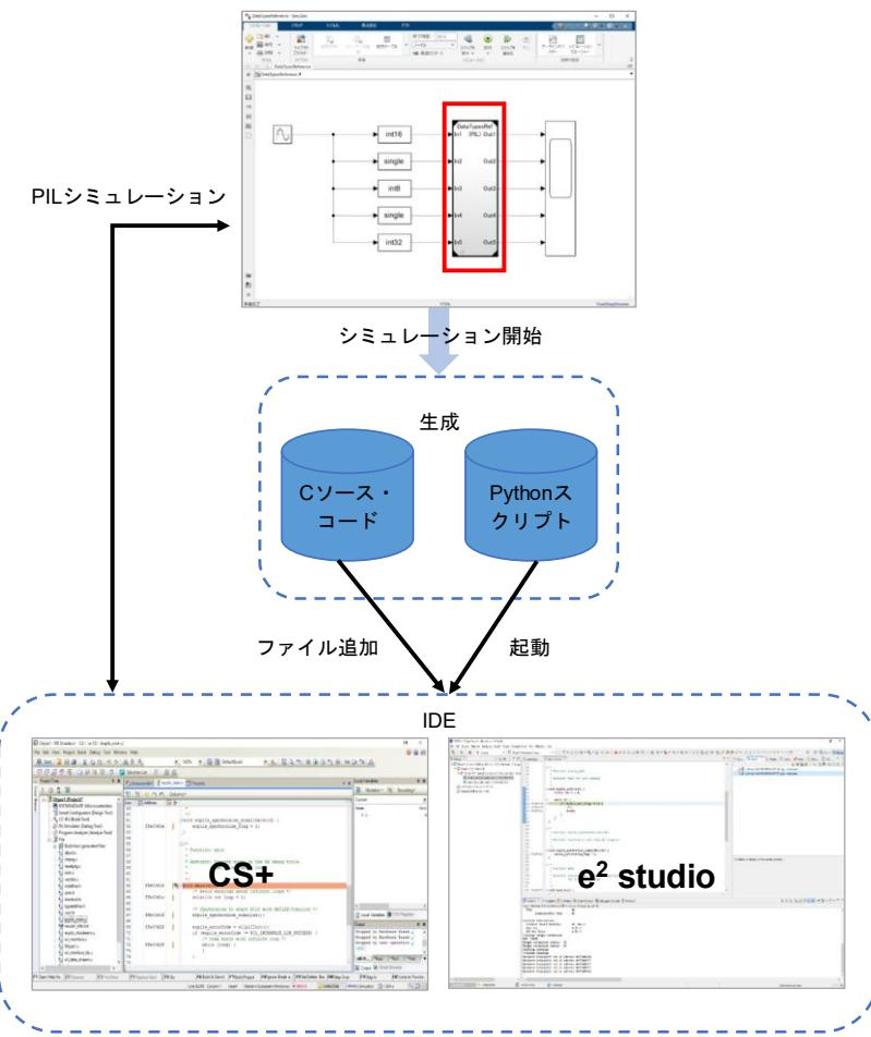
図 1-9 Embedded Targetの処理の流れ(参照先モデルの場合)
