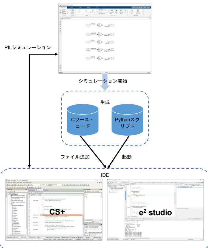
図 1-13 Embedded Target の処理の流れ(最上位モデルの場合)
