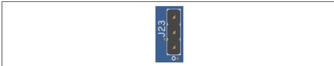
図 5-9 Pmod2 ピンヘッダジャンパ (表面)
