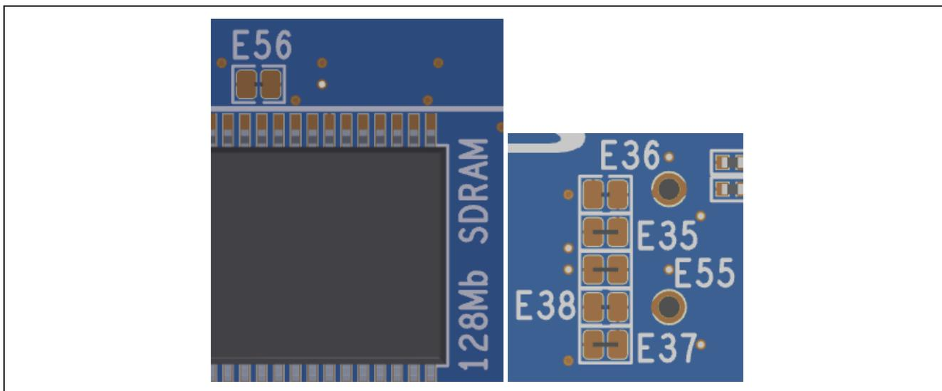
図 5-14 USB シリアル変換はんだジャンパ (E56 : 表面、その他 : 裏面)
