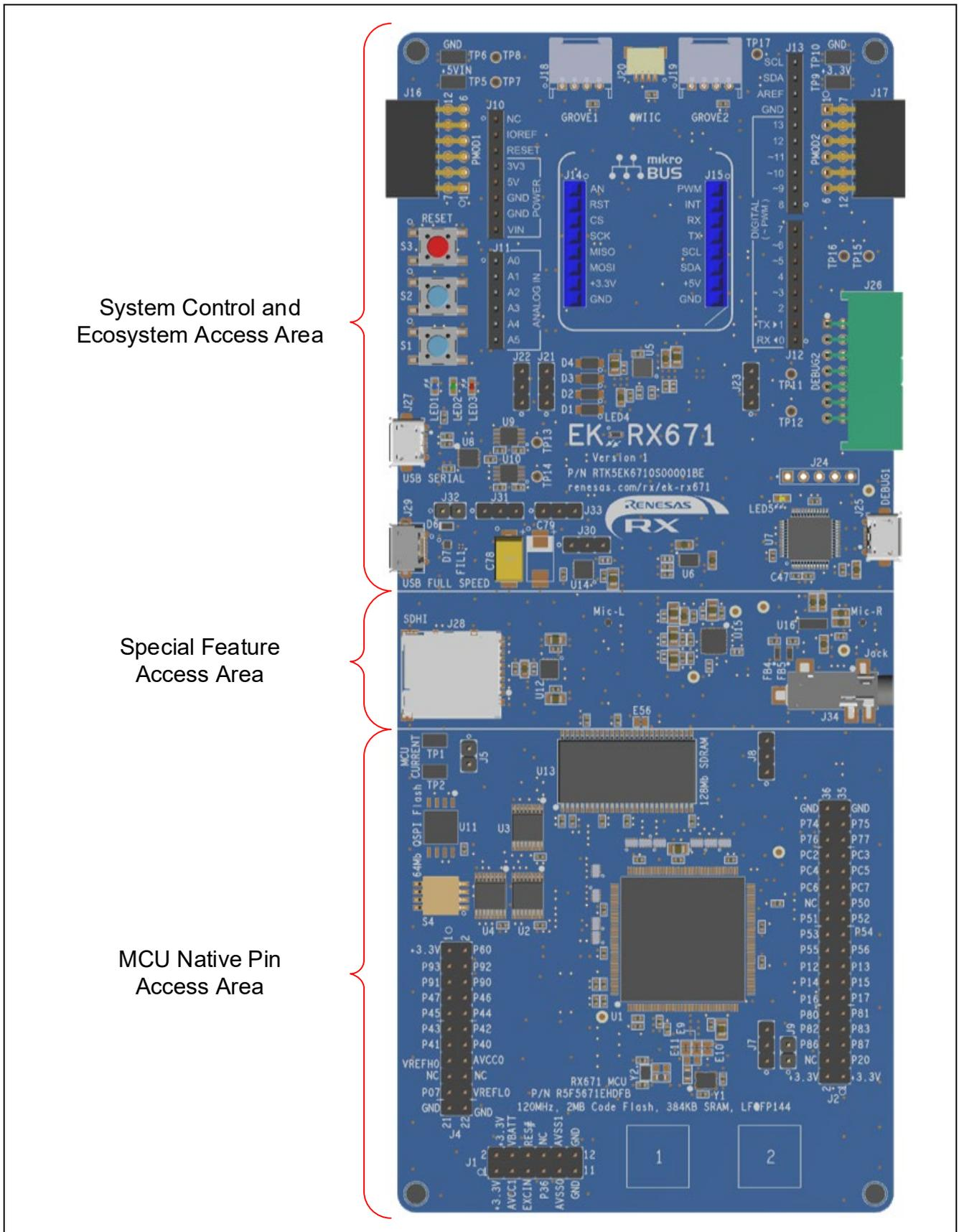
図 4-1 EK-RX671 ボードのエリアの定義
