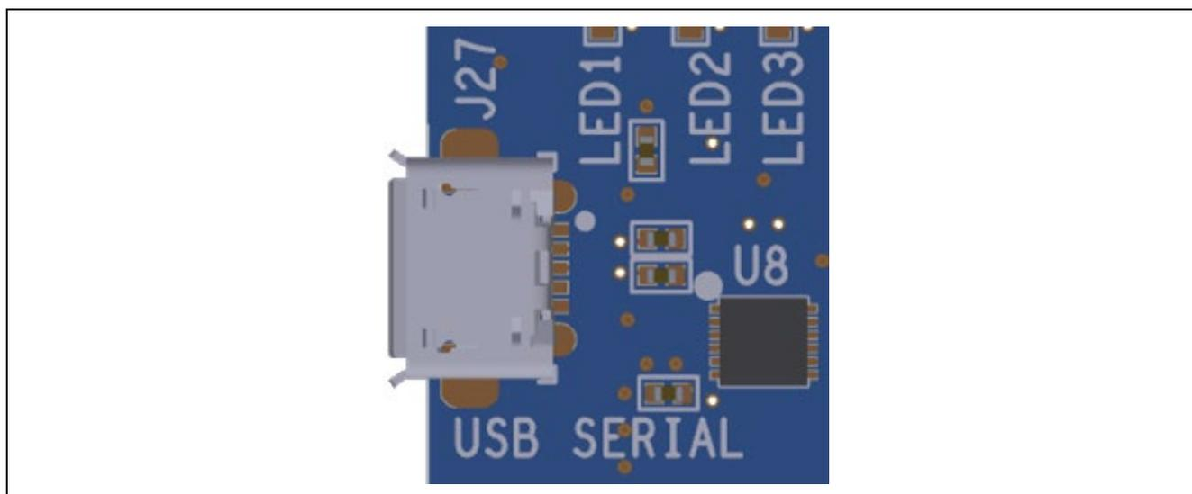
図 5-13 USB シリアル変換用 USB Micro Type B コネクタ
