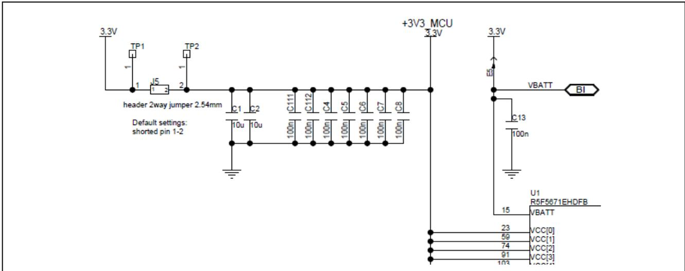
図 7-2 RX MCU +3.3 V 電流測定回路
