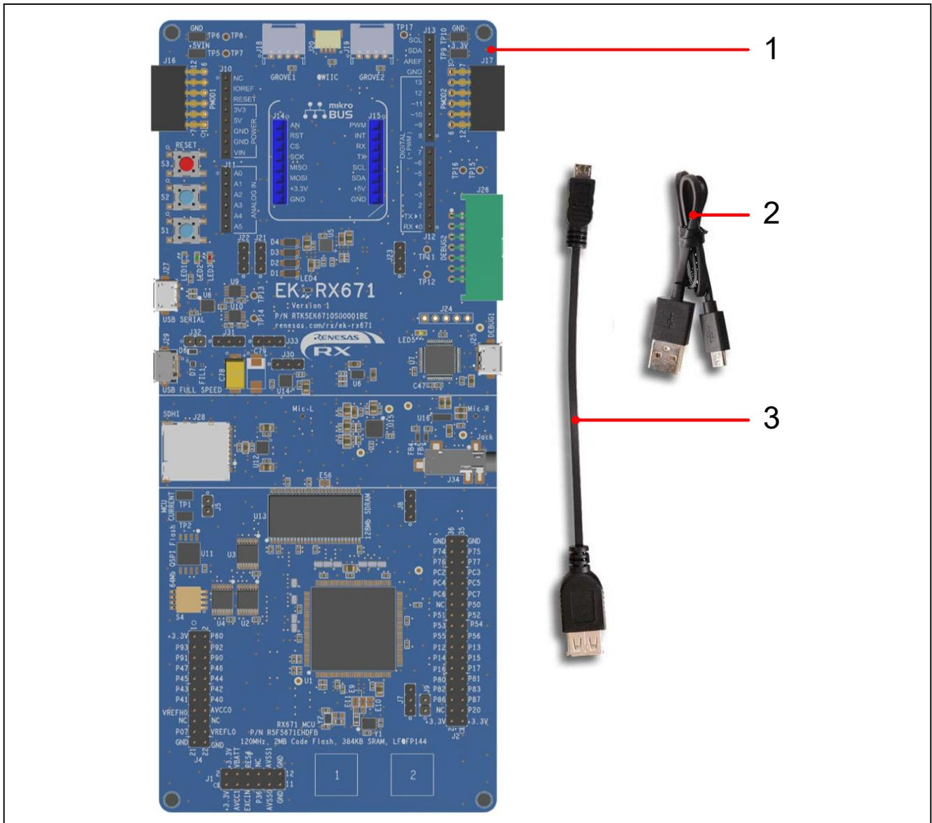
図 2-1 EK-RX671 v1 評価キット構成
