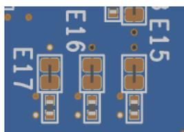
図 5-19 ユーザLED はんだジャンパ (裏面)
