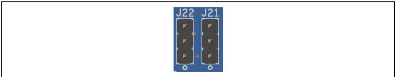
図 5-6 Pmod 1 ピンヘッダジャンパ (表面)
