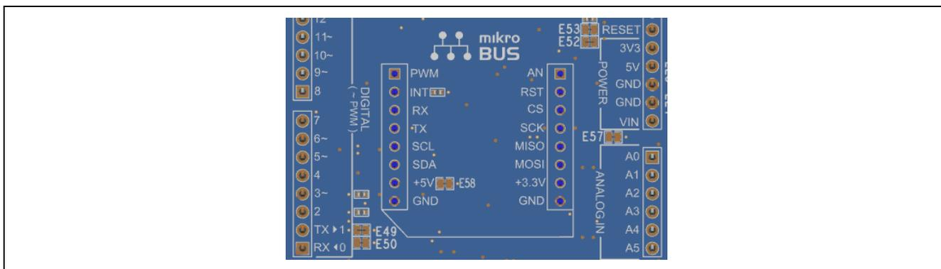
図 5-11 Arduino Uno はんだジャンパ (裏面)
