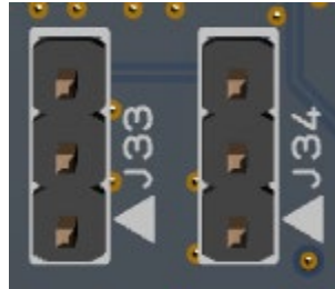
図 18 Pmod2 ピンヘッダジャンパ (表面)
