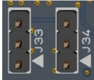
図 18 Pmod2 ピンヘッダジャンパ (表面)
