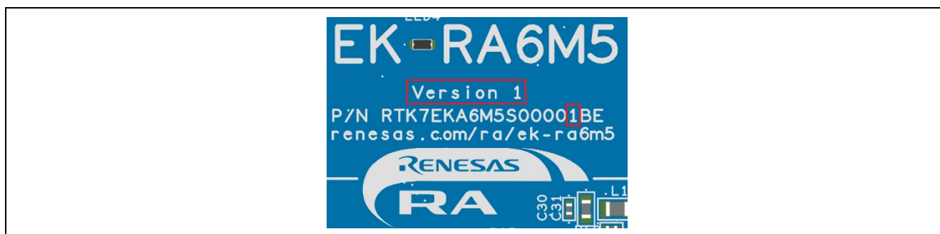
図8 RA6M5 ボード上でのキットバージョンナンバの識別
