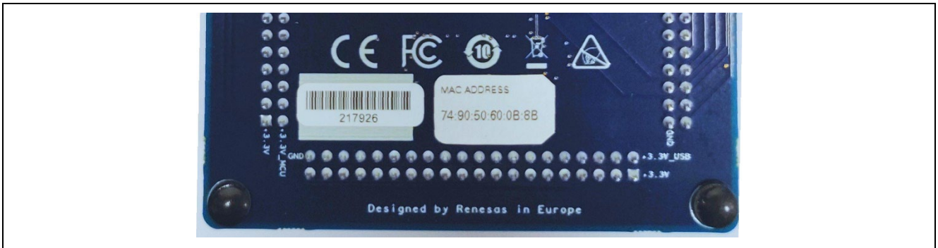
図 10 EK-RA6M5 ボード上でのシリアルナンバーの識別
