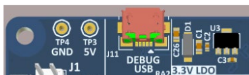
図 7 本評価キットボードの USB デバッグコネクタ（J11）、TP3、および TP4
