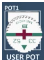
図 27 本評価キットボード上のユーザポテンショメータ（上面）
