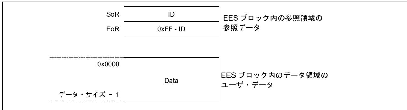
図 3-5 格納データの構造
