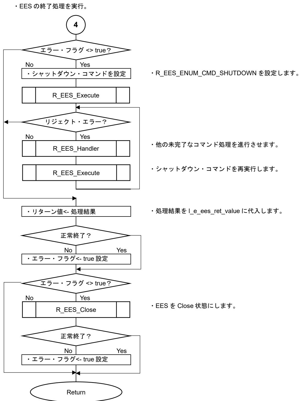
図 6-7 EEPROM エミュレーション制御サンプルの処理実行フロー(5/5)
