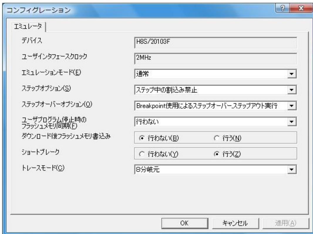
図 5.3 [コンフィグレーション]ダイアログボックス ([エミュレータ]ページ)
