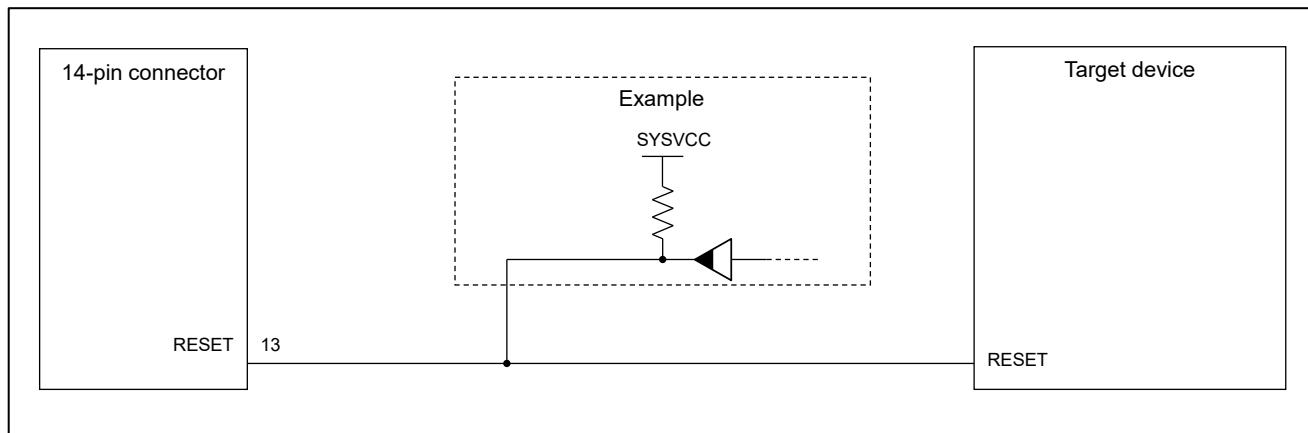
図 2-7 リセット回路接続例
