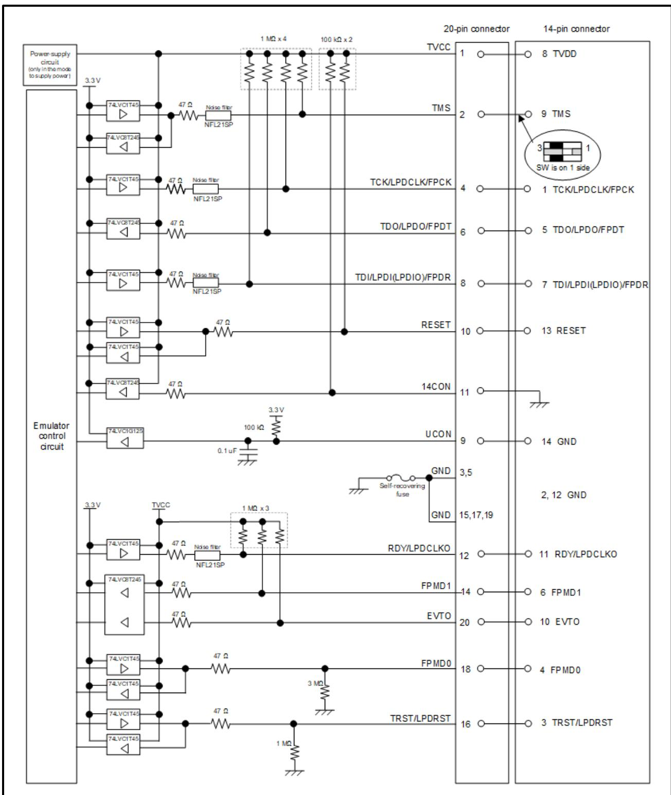
図 5-3 E2 エミュレータ(Rev.D)内インタフェース回路(LPD 4pin、JTAG、2wireUART、CSI)
