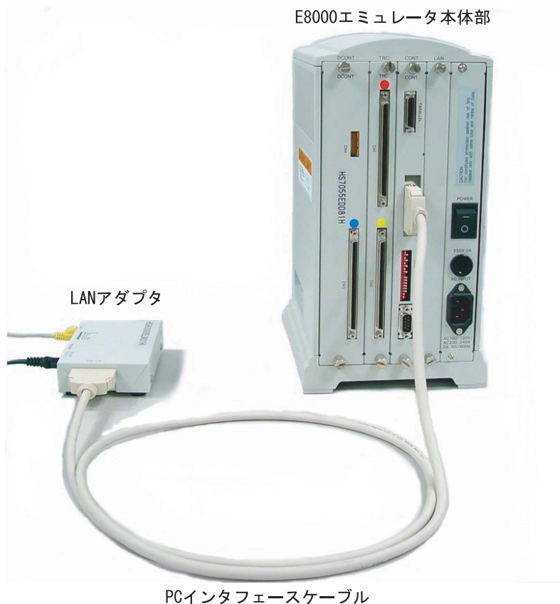
図 3.5 E8000 エミュレータと LAN アダプタとの接続
