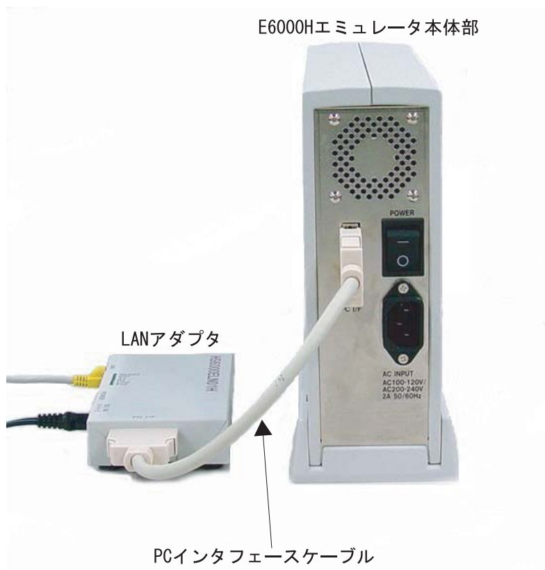
図 3.4 E6000H エミュレータと LAN アダプタとの接続
