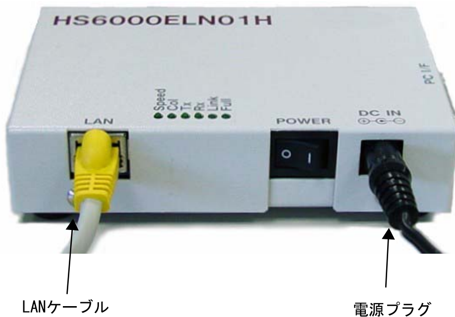
図 3.2 LAN アダプタの接続方法
