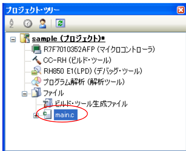
図 2—5 プロジェクト・ツリー パネル (ファイル main.c 追加後)
