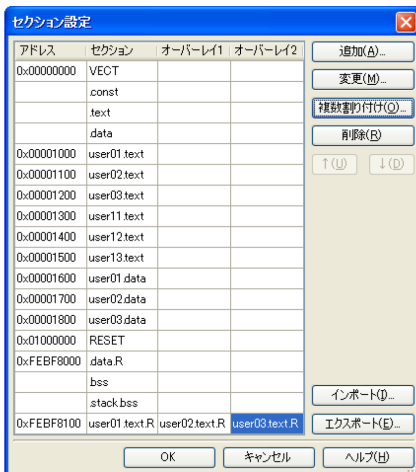
図 2—63 セクション設定 ダイアログ (オーバーレイ・セクション追加後)
