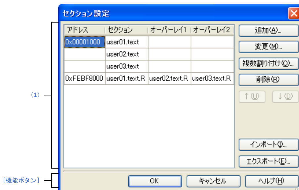
図 A—29 セクション設定 ダイアログ
