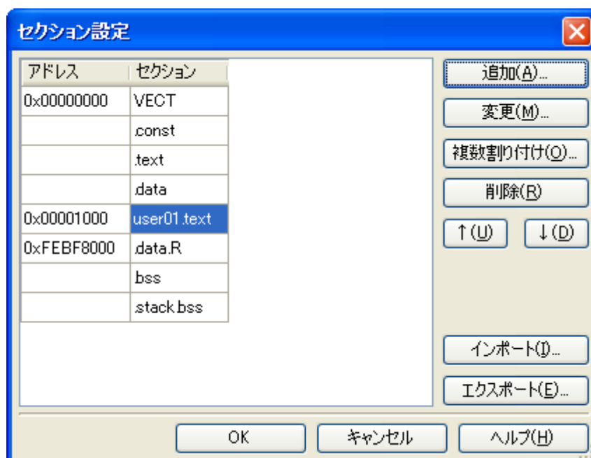
図 2—57 セクション設定 ダイアログ (ROM セクション追加後)
