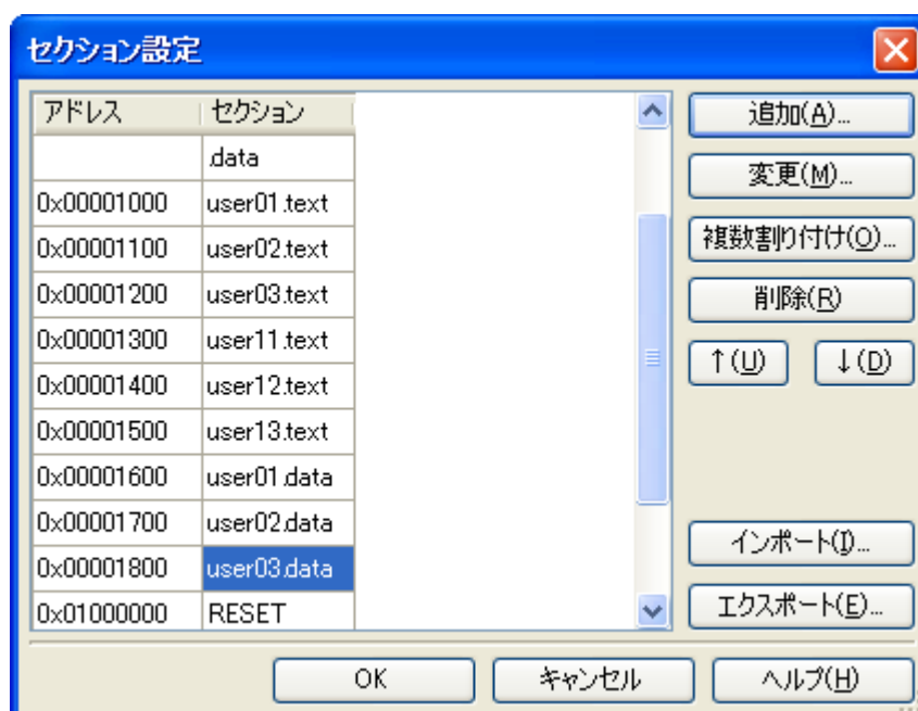
図 2—58 セクション設定 ダイアログ (複数 ROM セクション追加後)
