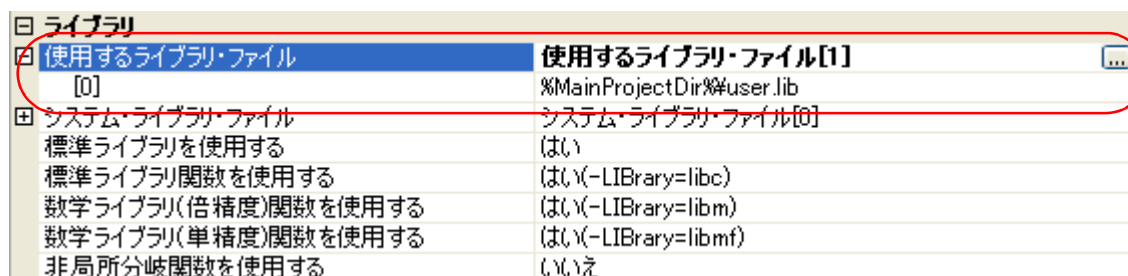
図 2—48 「使用するライブラリ・ファイル」 プロパティ (ライブラリ・ファイル設定後)
