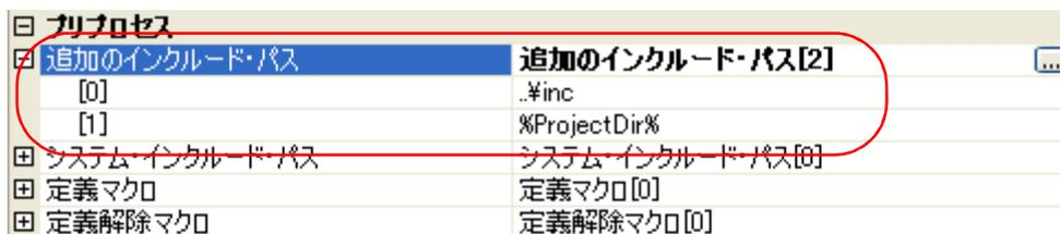
インクルード・パスの変更は、[...] ボタン、またはサブプロパティのテキスト・ボックスへの直接入力により行うことができます。
