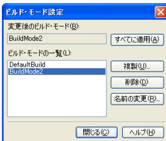
ビルド・モードの一覧から変更するビルド・モードを選択すると、[変更後のビルド・モード] に選択したビルド・モードが表示されます。[すべてに適用] ボタンをクリックすると、プロジェクトに属するメイン・プロジェクト、およびすべてのサブプロジェクトのビルド・モードを、ダイアログ上で選択したビルド・モードに変更します。
