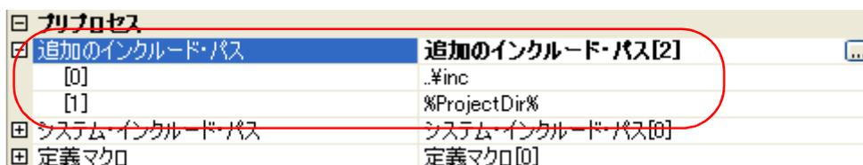
インクルード・パスの変更は、[...] ボタン、またはサブプロパティのテキスト・ボックスへの直接入力により行うことができます。
