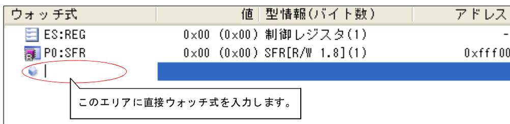
エン트리・ボックス内に、キーボードより直接ウォッチ式を入力したのち、[Enter] キーを押下します。
