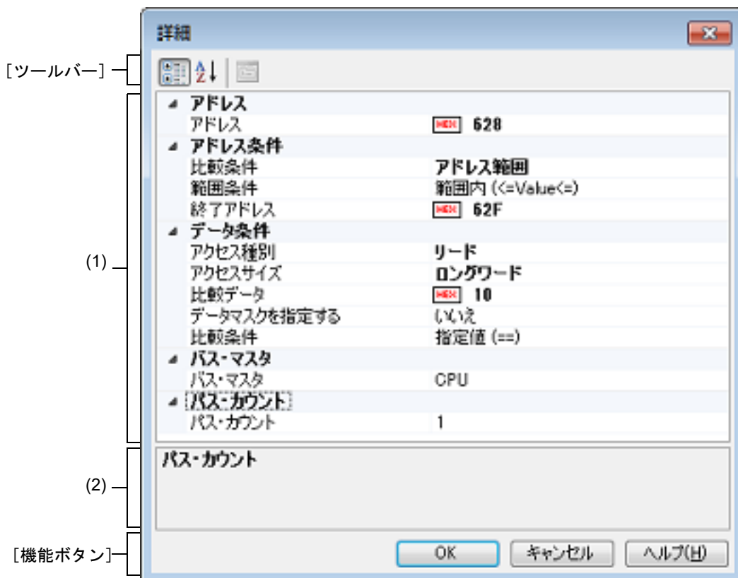
図 A.42 アクセスイベント詳細設定ダイアログ【E1】【E20】
