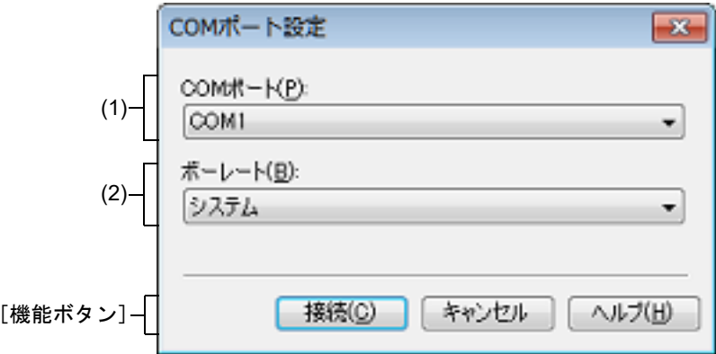
図 A.45 COM ポート設定 ダイアログ
