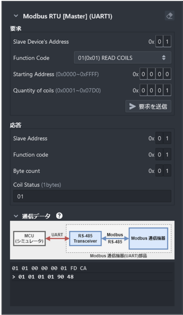
図 A.57 シリアルモニタ (Modbus)
