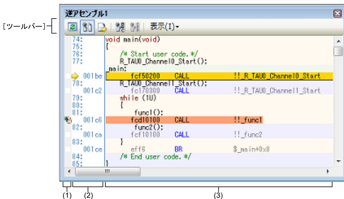
図 A.7 逆アセンブル パネル（混合表示モードの場合）
