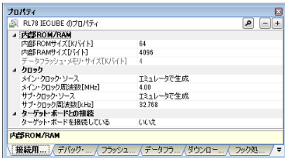
図 2.7 動作環境設定【IECUBE】（プロパティ パネルの例）
