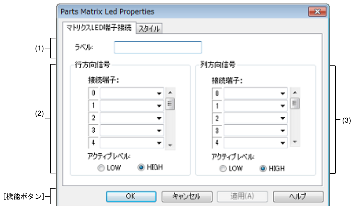
図 A.86 Parts Matrix Led Properties ダイアログ：[マトリクス LED 端子接続] タブ
