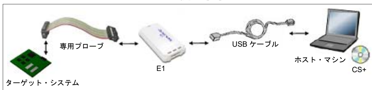
図 2.1 ホスト・マシンとデバッグ・ツールとの接続例【E1】
