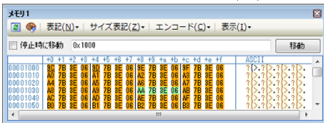
図 2.121 RRM 機能によるメモリ表示の例（メモリ パネル）【E20(JTAG)】【RX600 シリーズ】
