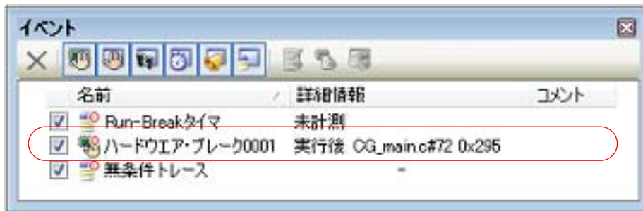
図 2.87 イベントパネルの組み合わせブレイク・イベント（実行系）の設定例【E1】【E20】
