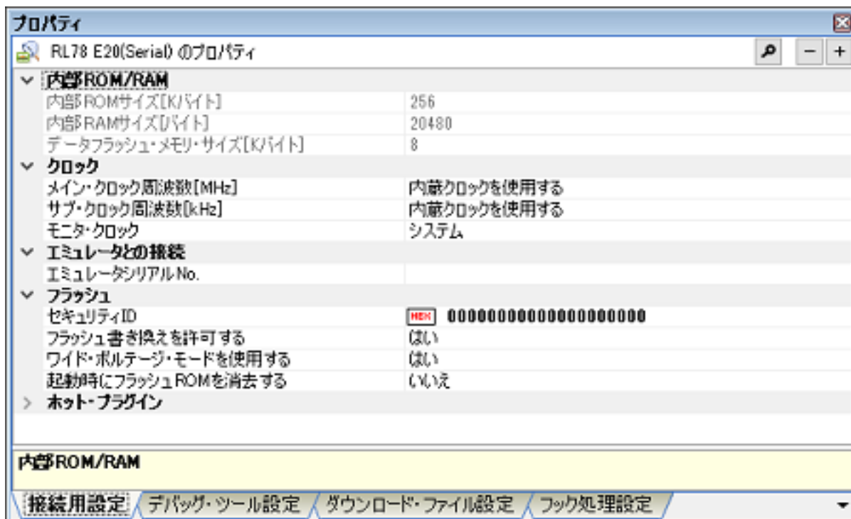
図 2.36 動作環境設定【E20】（プロパティ パネルの例）
