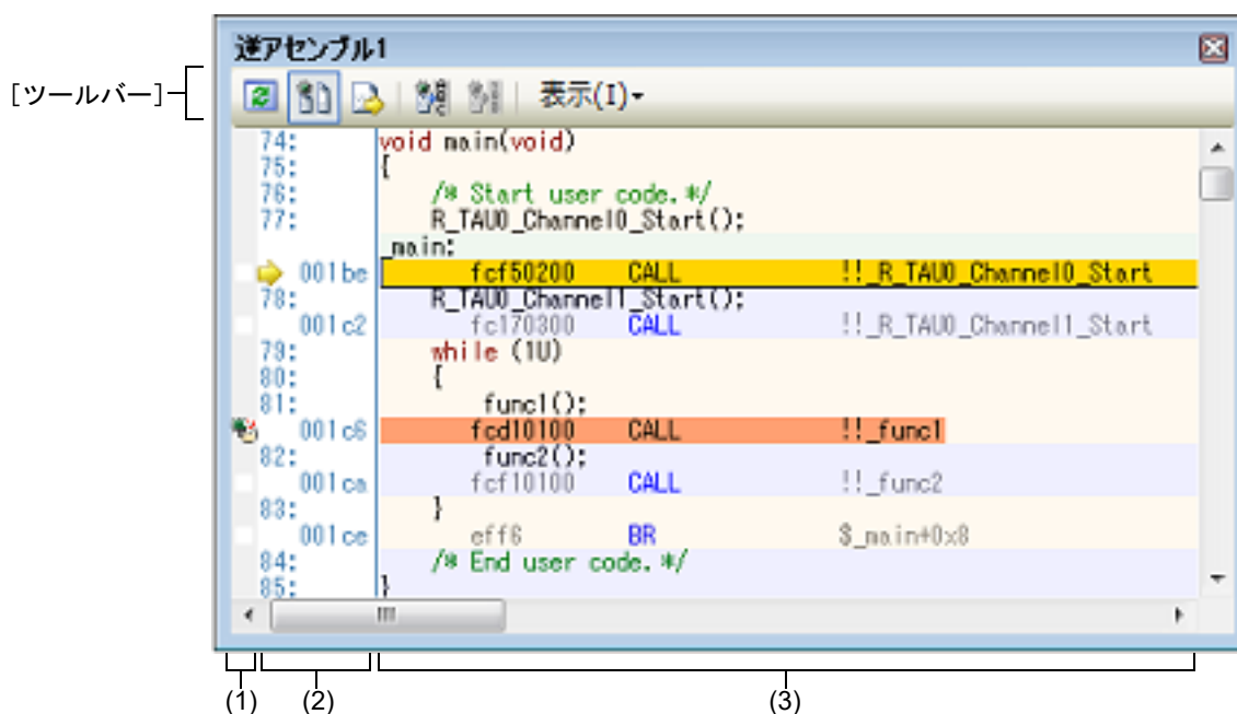
図 A.16 逆アセンブル パネル（混合表示モードの場合）
