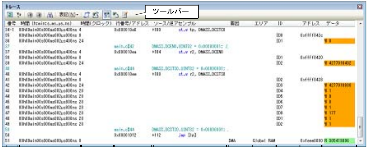
図 2.111 トレース・データの表示（トレースパネル【Full-spec emulator】【E1】【E20】）
