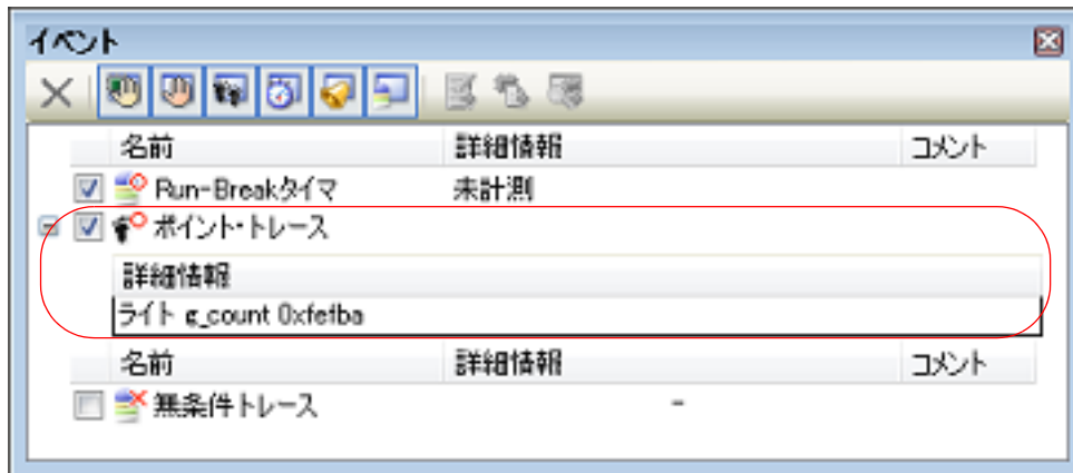
図 2.109 イベントパネルのポイント・トレース・イベントの設定例
