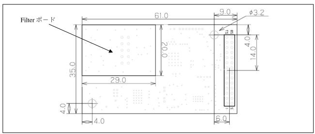
Figure 1-5: PLC ボードと Filter ボードの寸法
