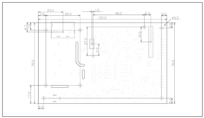
Figure 1-6: BASE ボードの寸法
