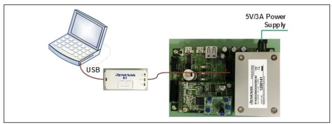
Figure 2-1: E1 エミュレーター接続
