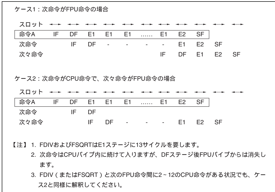
図 10.27 FDIV および FSQRT 命令の FPU パイプライン
