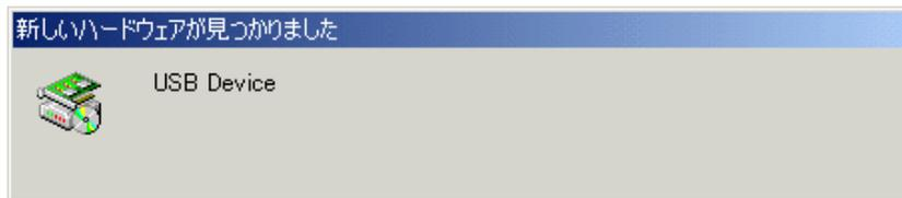
そのままウィザードに従うとセットアップ情報ファイル(inf ファイル)を指定するためのダイアログがオープンします。本製品をインストールしたディレクトリ下の `musbdrv.inf` ファイルを指定してください。
