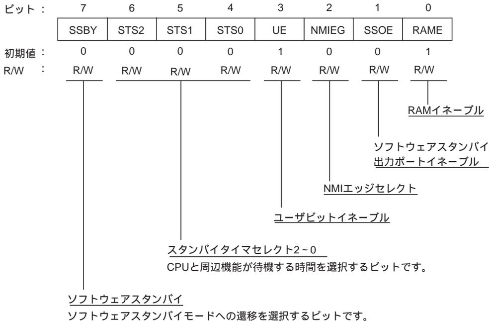
SYSCR は 8 ビットのリード/ライト可能なレジスタで、ビット 7 の SSBY ビットとビット 6~4 の STS2~STS0 ビットとビット 1 の SSOE ビットにより低消費電力状態の制御を行います。なお、SYSCR のその他のビットについての詳細は「3.3 システムコントロールレジスタ (SYSCR)」を参照してください。
