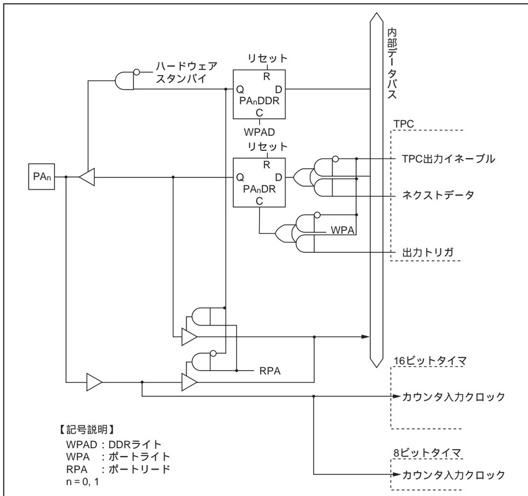
図 C.10 (a) ポート A ブロック図 (PA<sub>0</sub>、PA<sub>1</sub> 端子)
