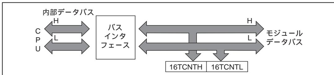
図 8.4 16TCNT のアクセス動作 [ CPU 16TCNT (ワード) ]
