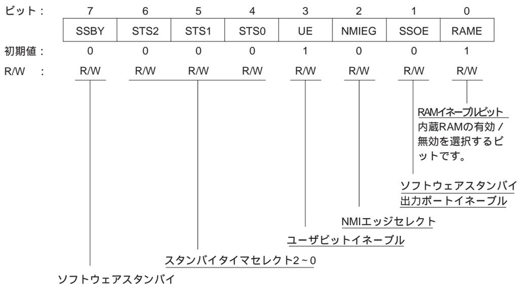
SYSCRは、内蔵RAMへのアクセスを許可/禁止するレジスタです。内蔵RAMはSYSCRのRAMEビットにより有効/無効が選択されます。なお、SYSCRのその他のビットについての詳細は「3.3 システムコントロールレジスタ (SYSCR)」を参照してください。
