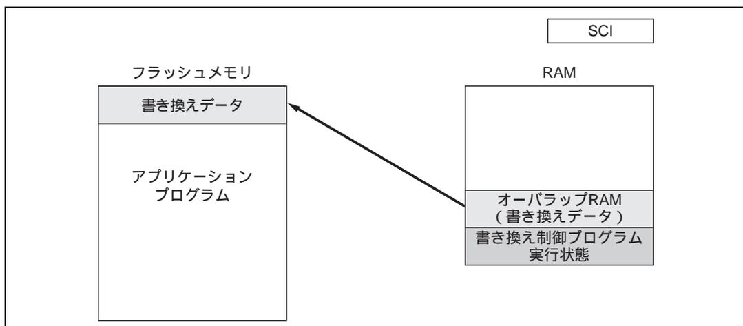
図 19.5 ユーザプログラムモードのオーバーラップ RAM データの書き込み
