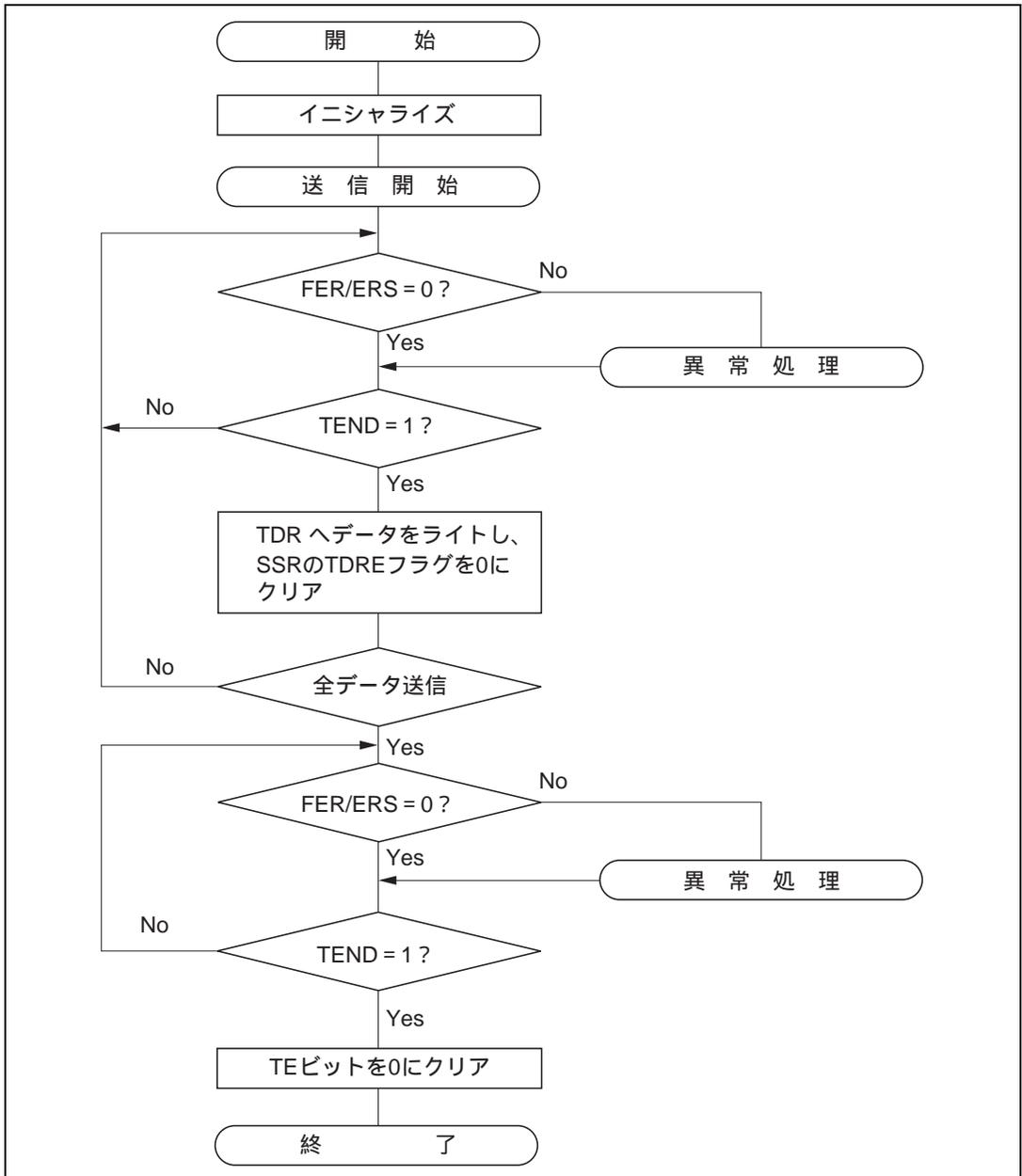
図 13.5 送信処理フローの例
