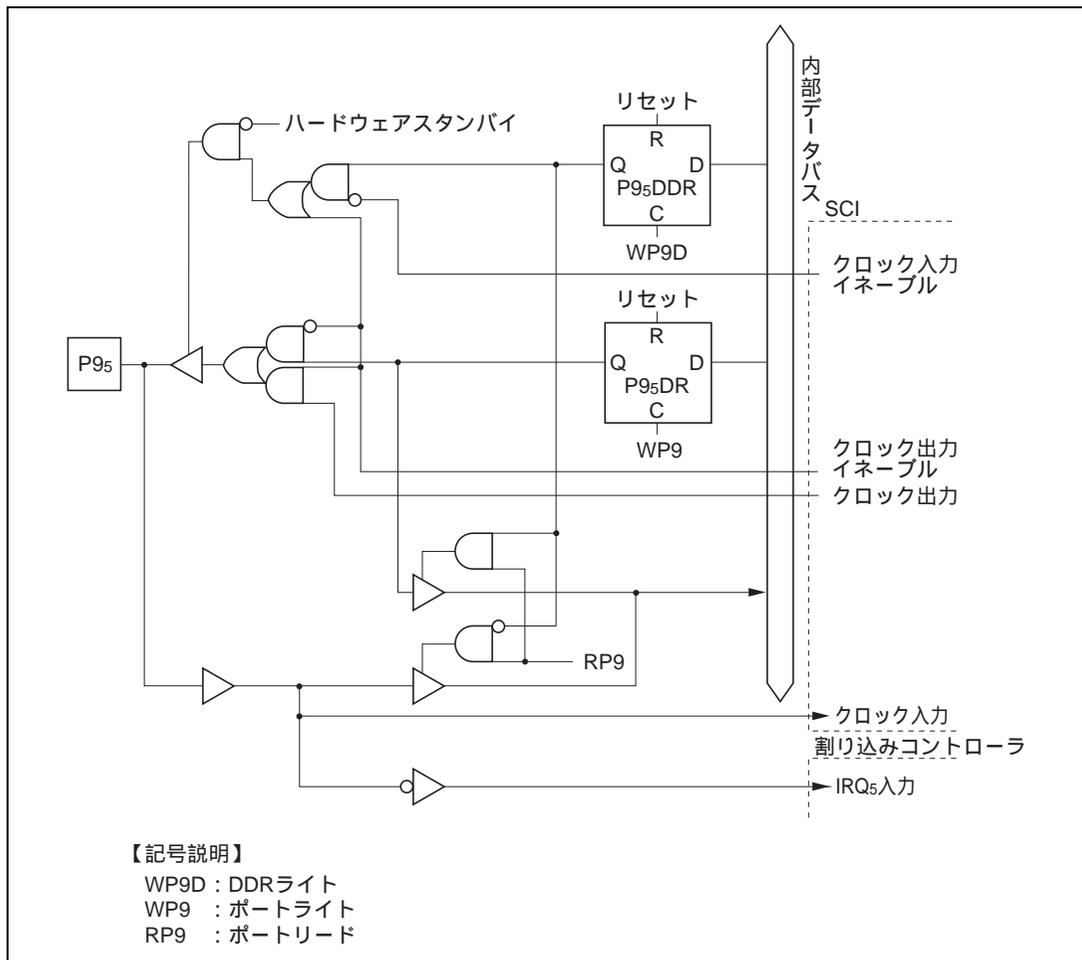
図 C.9 (f) ポート 9 ブロック図 (P9<sub>s</sub>端子)
