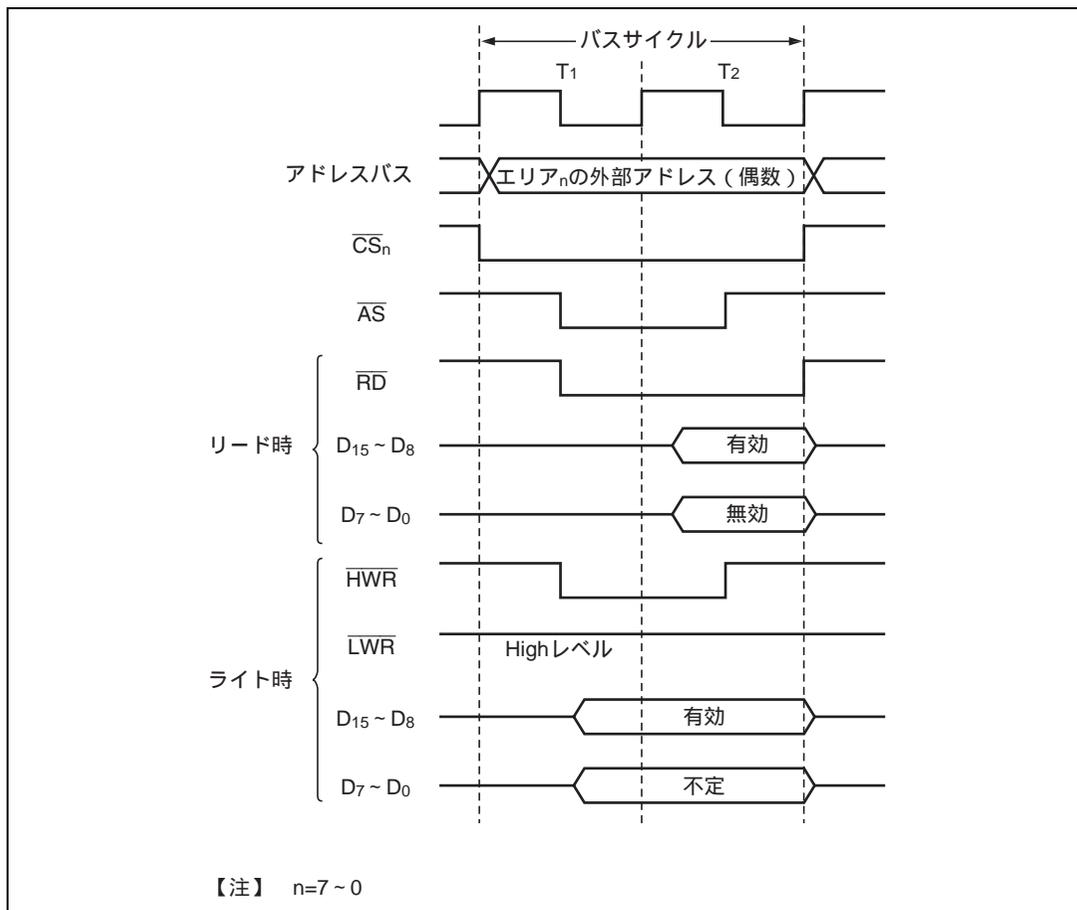
図 6.16 16 ビット 2 ステートアクセス空間のバス制御信号タイミング (1)
