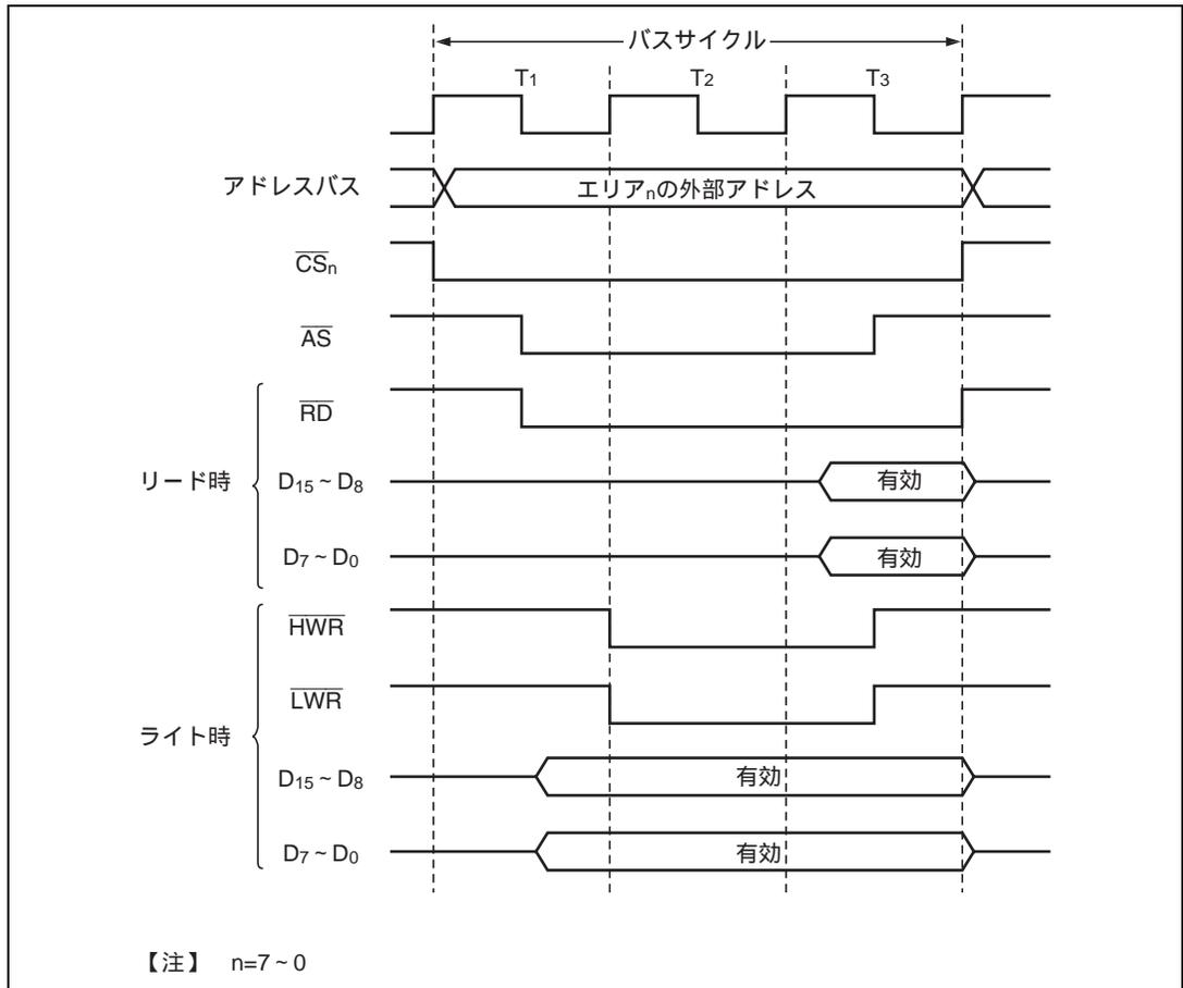
図 6.15 16 ビット 3 ステートアクセス空間のバス制御信号タイミング (3)
