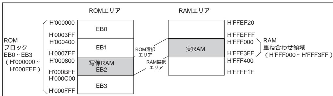
図 17.2 ROM エリアと RAM エリアの重ね合わせ例
