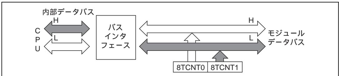
図 9.7 8TCNT1 のアクセス動作 [ 8TCNT1 CPU (下位バイト) ]
