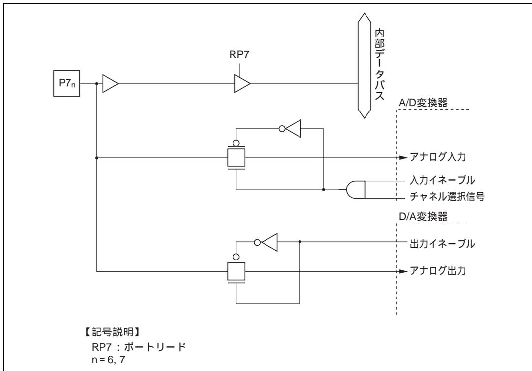
図 C.7 (b) ポート7ブロック図 (P7<sub>6</sub>~P7<sub>7</sub>端子)
