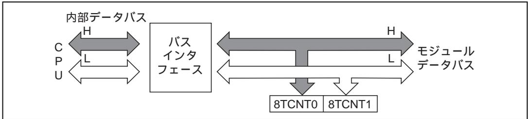
図 9.4 8TCNT0 のアクセス動作 [ CPU 8TCNT0 (上位バイト) ]
