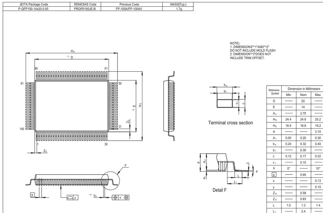
図 H.3 外形寸法図 (FP-100A) 単位 : mm
