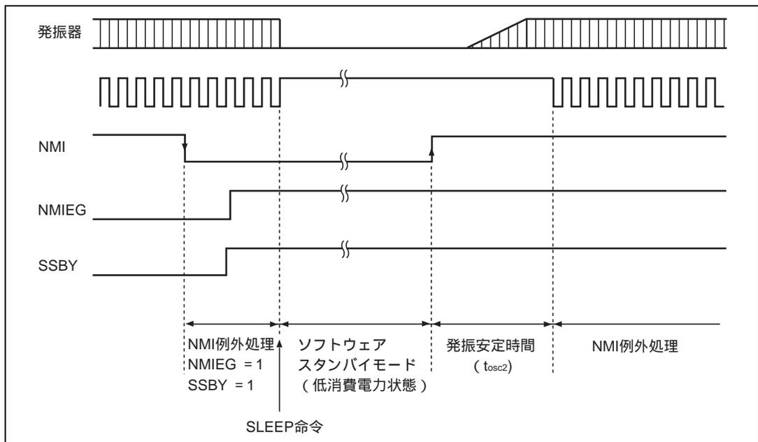
図 21.1 ソフトウェアスタンバイモード時の NMI タイミング (例)
