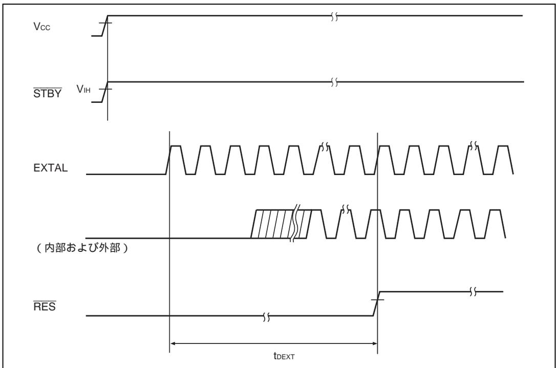
図 20.7 外部クロック出力安定遅延時間タイミング
