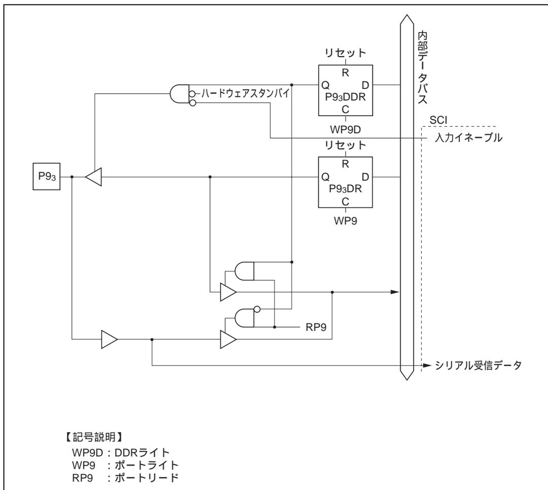
図 C.9 (d) ポート9ブロック図 (P9<sub>3</sub>端子)
