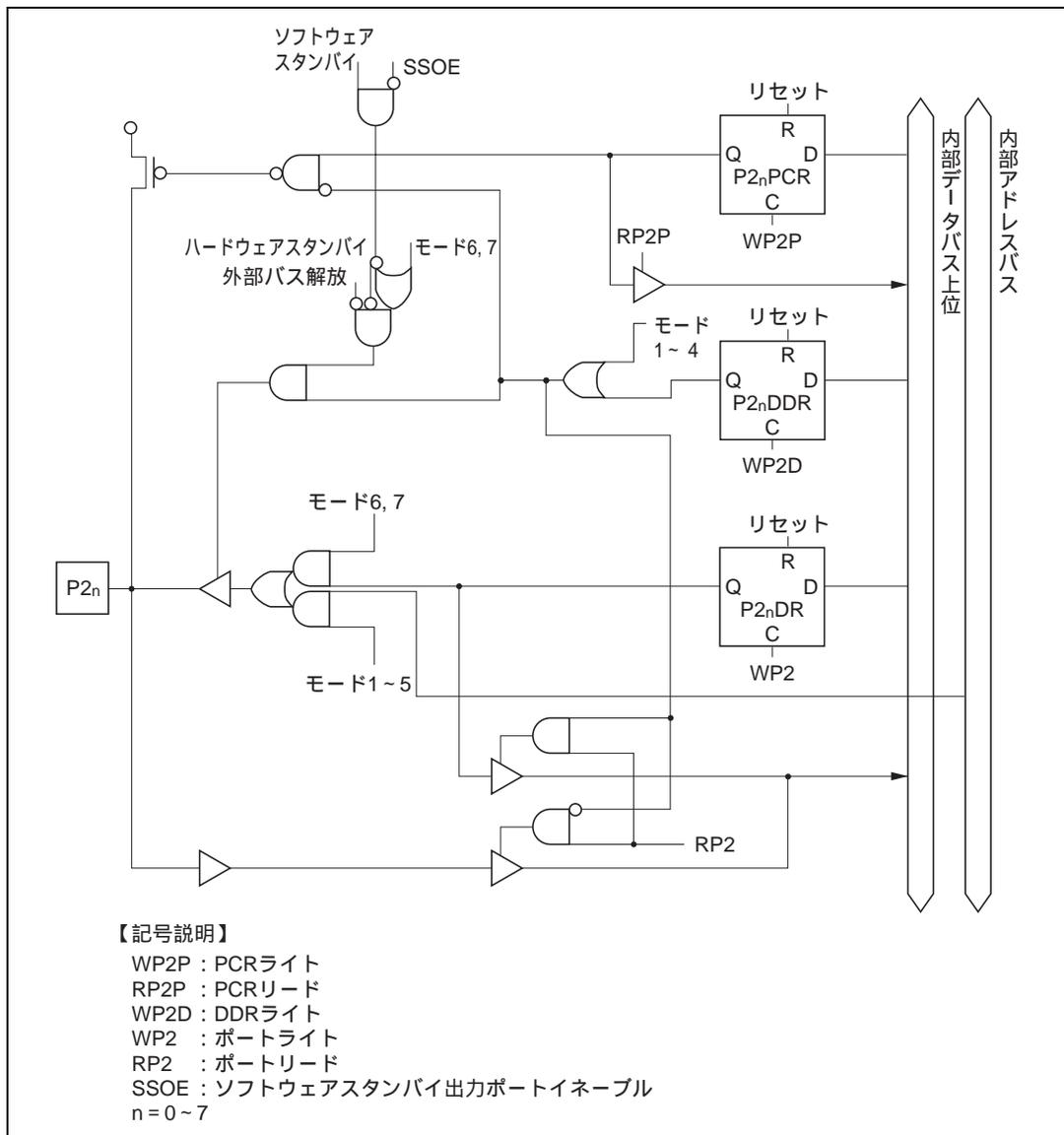
図 C.2 ポート 2 ブロック図 (P2<sub>0</sub> ~ P2<sub>7</sub> 端子)
