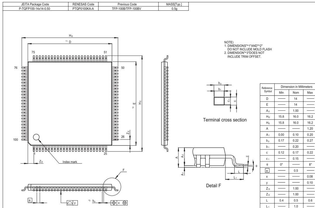
図 H.2 外形寸法図 (TFP-100B) 単位 : mm
