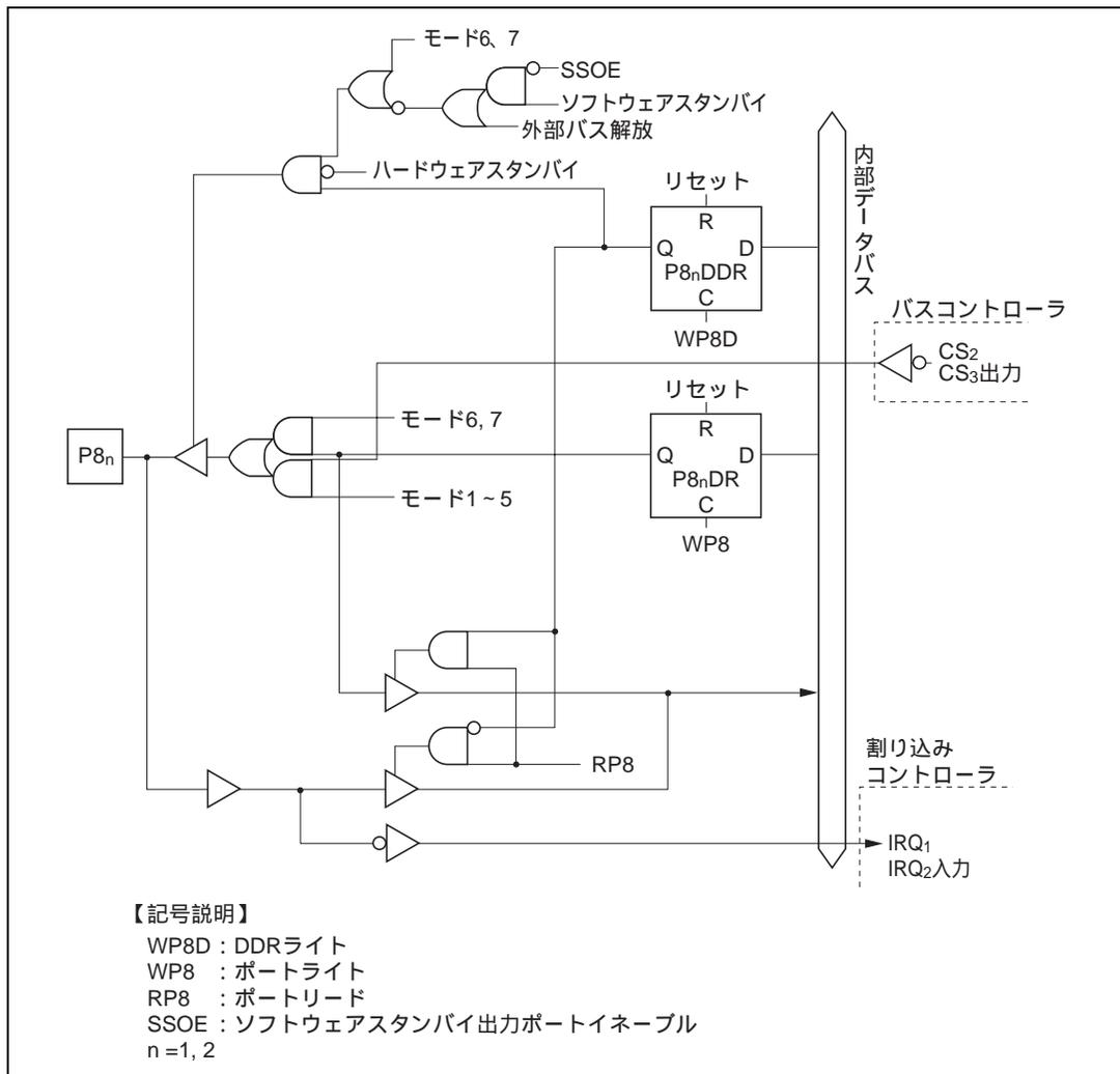
図 C.8 (b) ポート 8 ブロック図 (P8<sub>1</sub> ~ P8<sub>2</sub> 端子)
