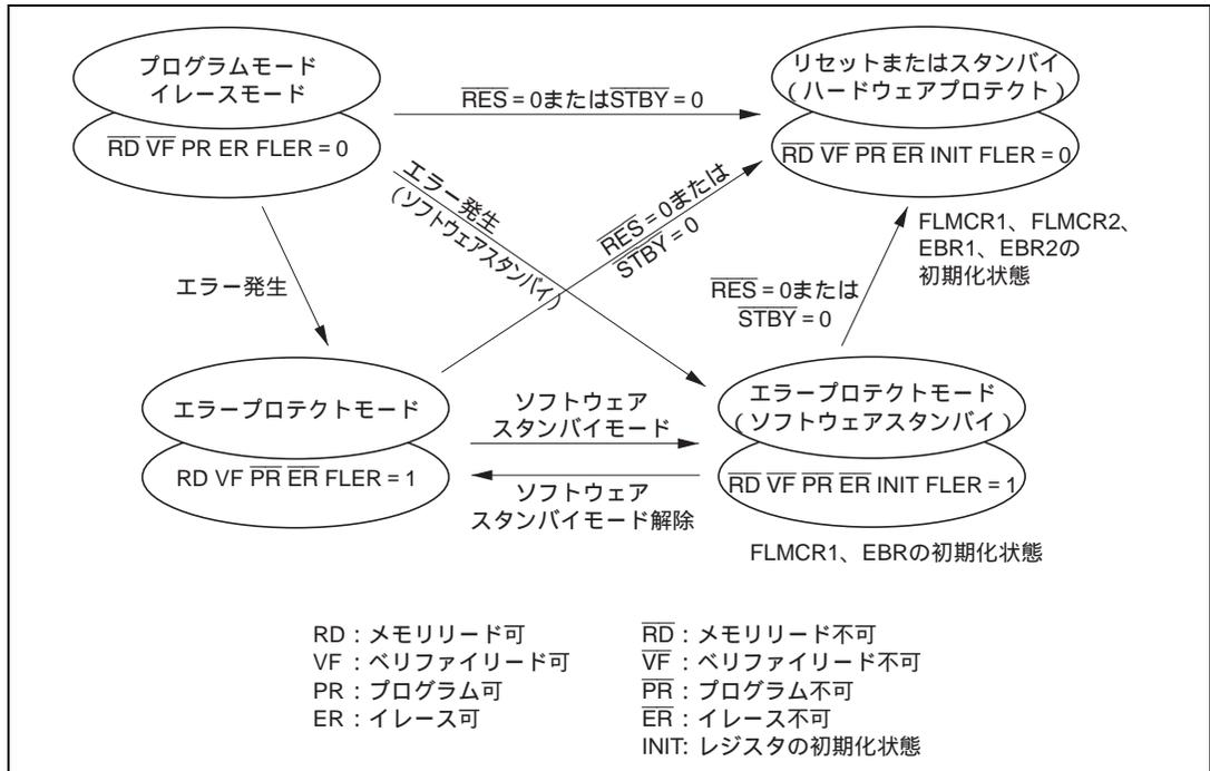
図 19.13 フラッシュメモリの状態遷移図 (モード 5、7 (内蔵 ROM が有効) で FWE 端子に High レベル印加時)
