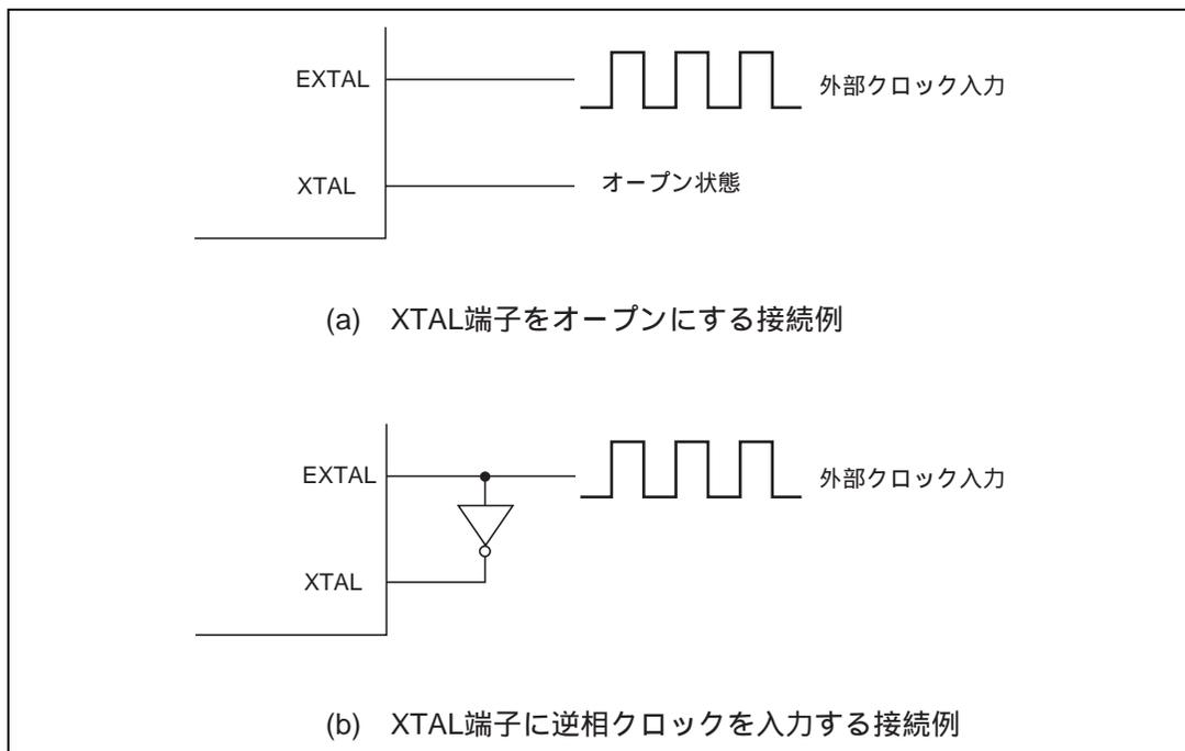
図 20.5 外部クロックを入力する場合の接続例
