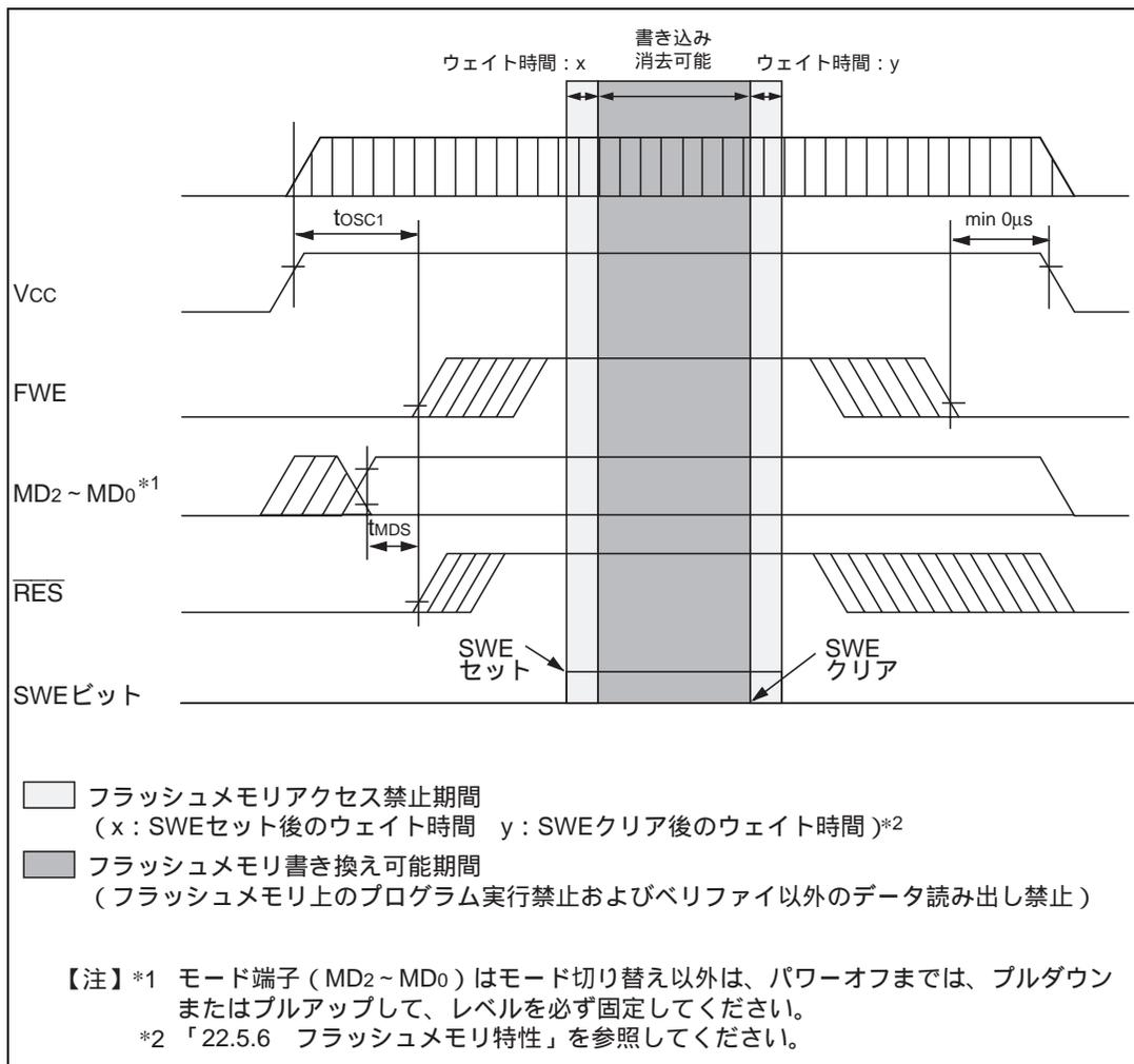
図 19.17 電源投入 / 切断タイミング ( ユーザプログラムモード )
