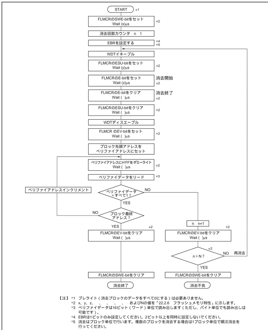
図 17.12 イレース/イレースペリファイフロー（単一ブロック消去）
