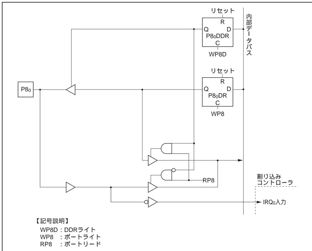
図 C.8 (a) ポート 8 ブロック図 (P8<sub>0</sub>端子)
