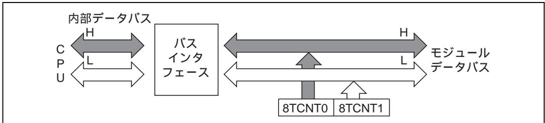
図 9.6 8TCNT0 のアクセス動作 [ 8TCNT0 CPU (上位バイト) ]
