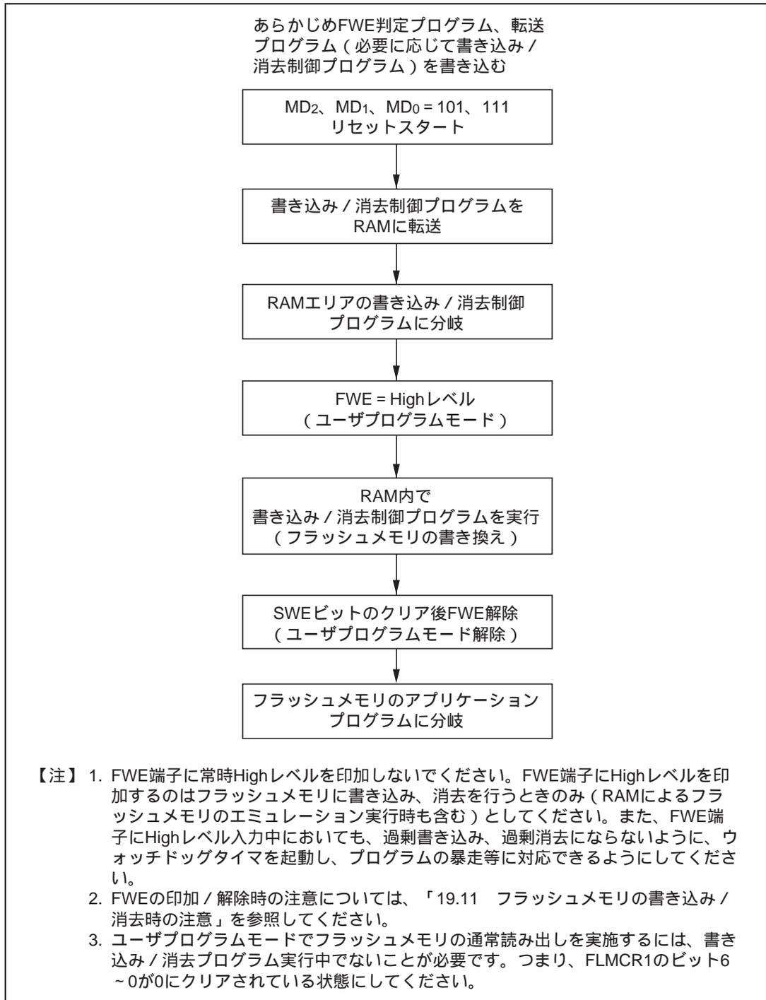
図 19.9 ユーザプログラムモードの実行手順例
