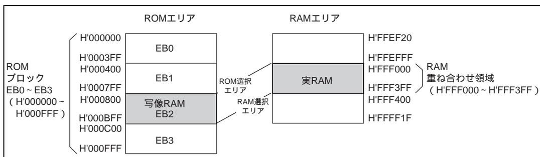
図 19.2 ROM エリアと RAM エリアの重ね合わせ例
