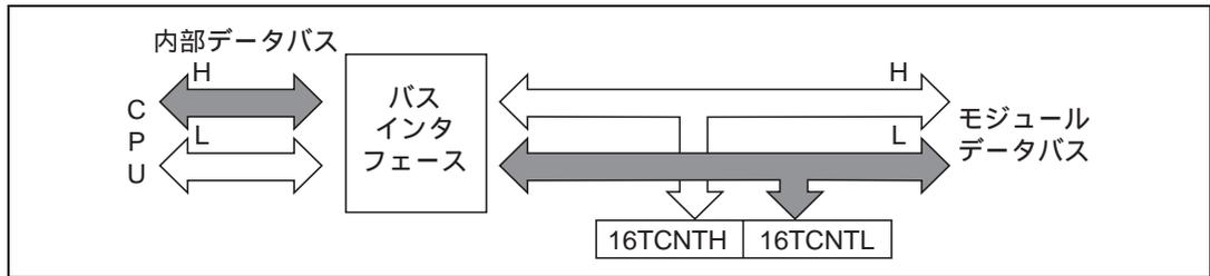
図 8.7 16TCNTL のアクセス動作 [ CPU 16TCNTL (下位バイト) ]
