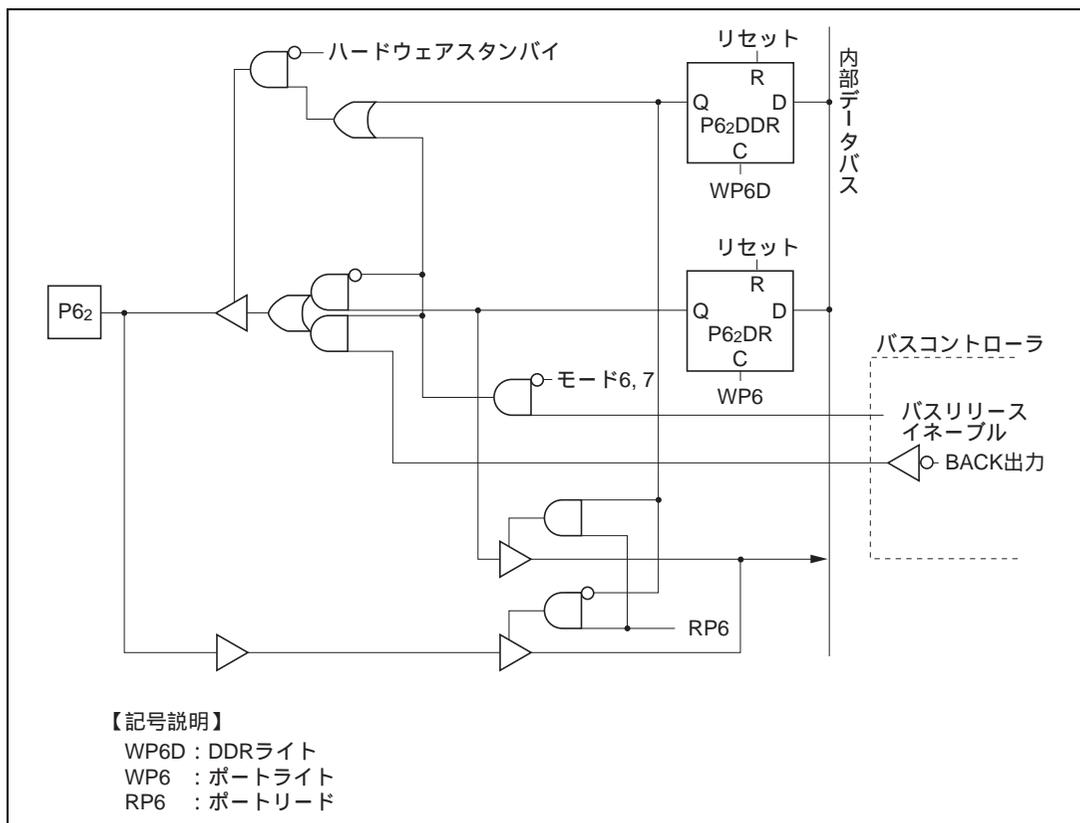
図 C.6 (c) ポート 6 ブロック図 (P6<sub>2</sub>端子)
