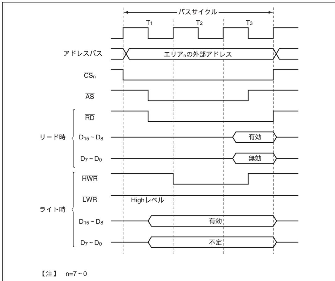
図 6.11 8ビット3ステートアクセス空間のバス制御信号タイミング
