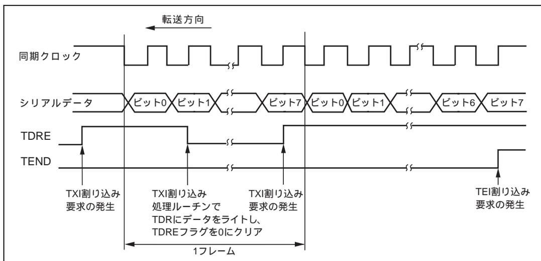
図 12.19 SCI の送信時の動作例
