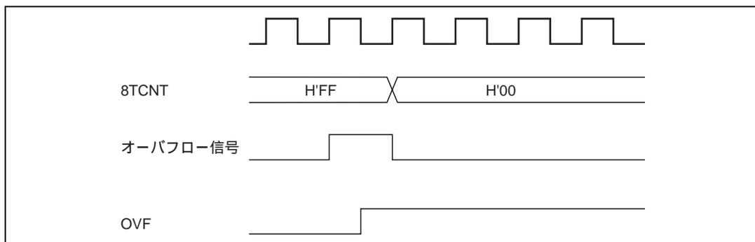
図 9.16 OVF のセットタイミング
