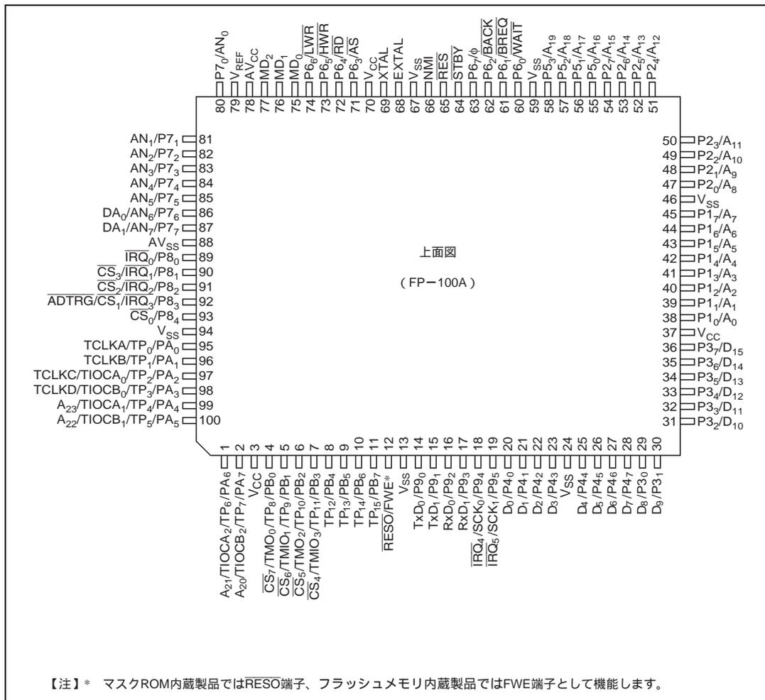
図 1.3 H8/3062F-ZTAT R マスク品、H8/3062 マスク ROM 品、H8/3061 マスク ROM 品、H8/3060 マスク ROM 品のピン配置図 (FP-100A パッケージ：上面図)
