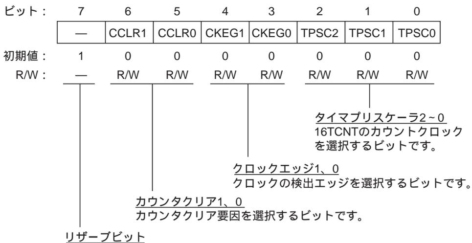
16TCR は 8 ビットのリード/ライト可能なレジスタで、16TCNT のカウンタクロックの選択、外部クロック選択時のエッジの選択、およびカウンタクリア要因の選択を行います。
