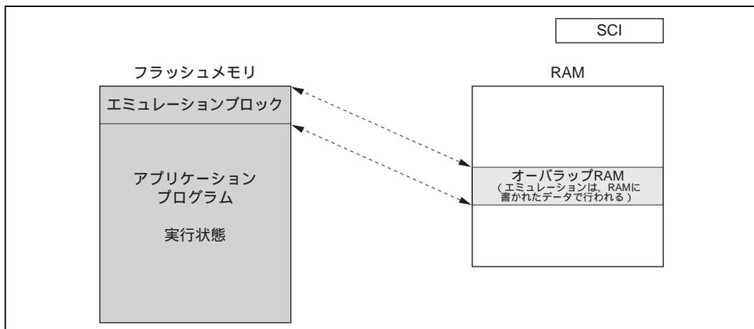
図 19.4 ユーザモード、ユーザプログラムモードのオーバーラップ RAM データの読み出し
