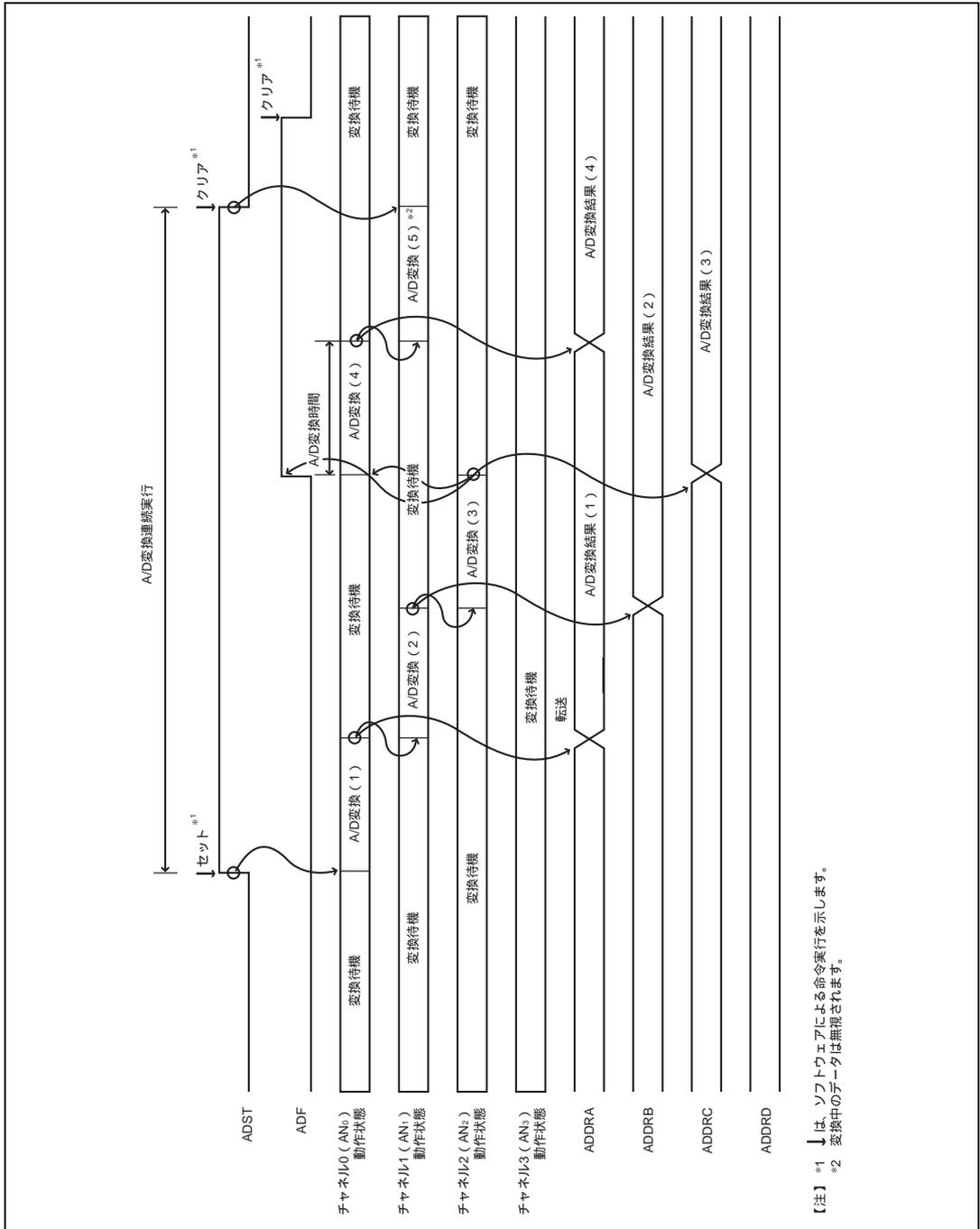
図 14.4 A/D 変換器の動作例 (スキャンモード AN<sub>0</sub> ~ AN<sub>2</sub> の 3 チャンネル選択時)
