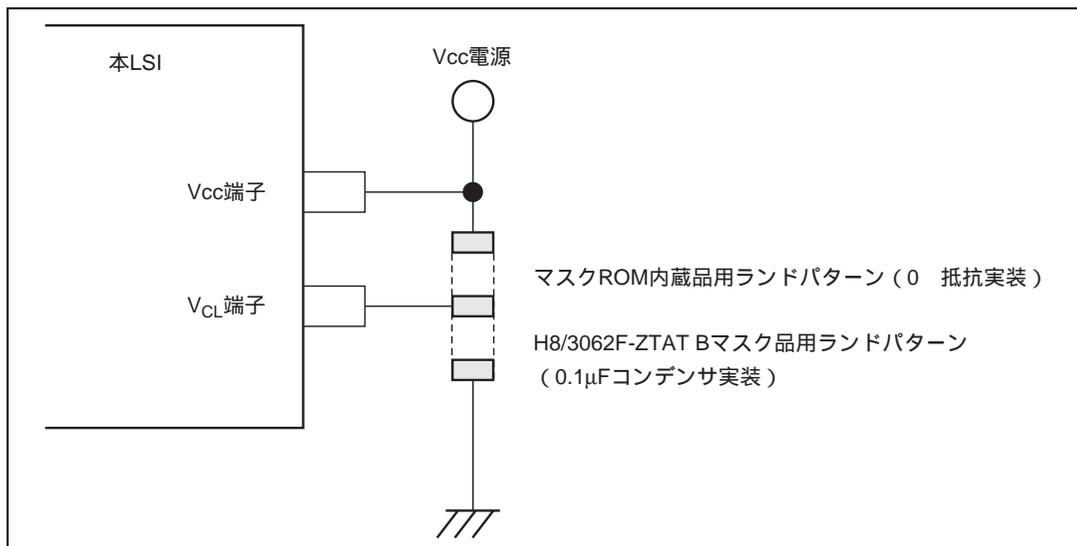
図 1.7 外付けコンデンサ対応の基板パターンの例
