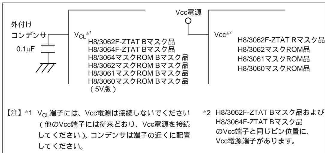
図 1.6 H8/3062F-ZTAT B マスク品、H8/3064F-ZTAT B マスク品およびマスク ROM 内蔵 B マスク品の  $V_{CL}$  コンデンサ接続方法
