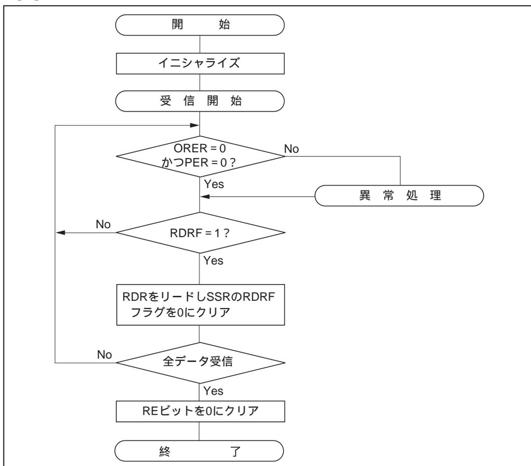
図 13.8 受信処理フローの例
