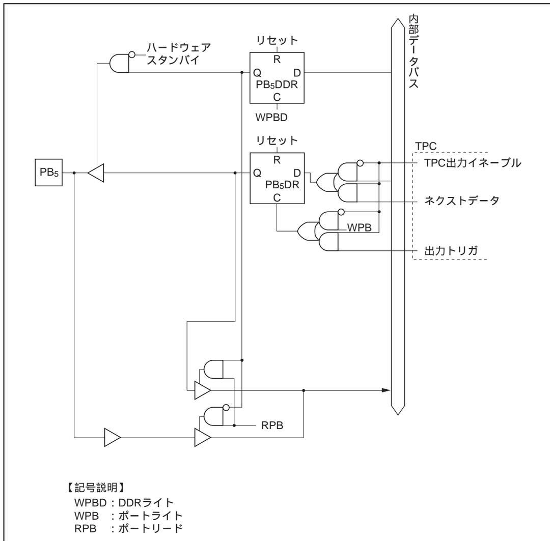
図 C.11 (d) ポート B ブロック図 (PB<sub>5</sub> 端子)
