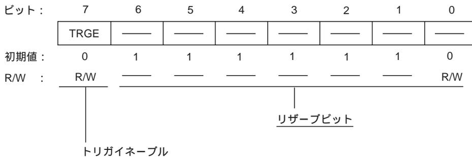
ADCR は、8 ビットのリード / ライト可能なレジスタで、外部トリガ入力あるいは 8 ビットタイマのコンペアマッチ信号による A/D 変換の開始の許可 / 禁止を選択します。
