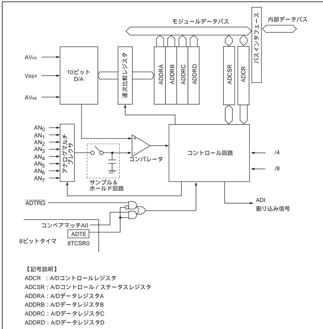
図 14.1 A/D 変換器のブロック図
