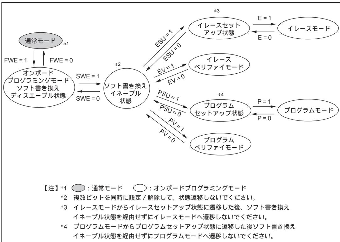
図 17.10 FLMCR の各ビット設定による状態遷移
