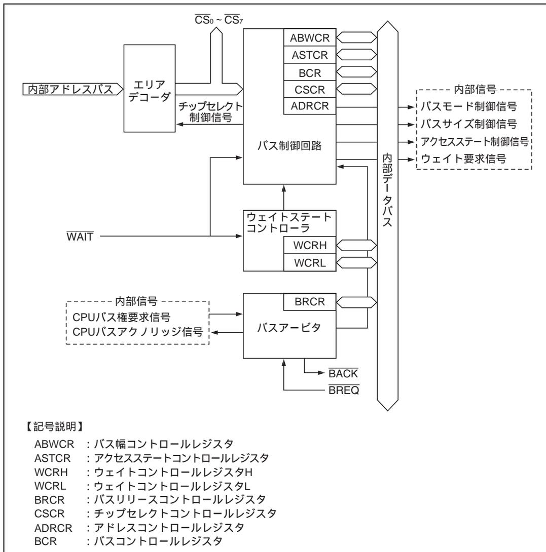
図 6.1 バスコントローラのブロック図
