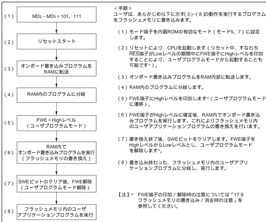
図 17.9 ユーザプログラムモードの実行手順例
