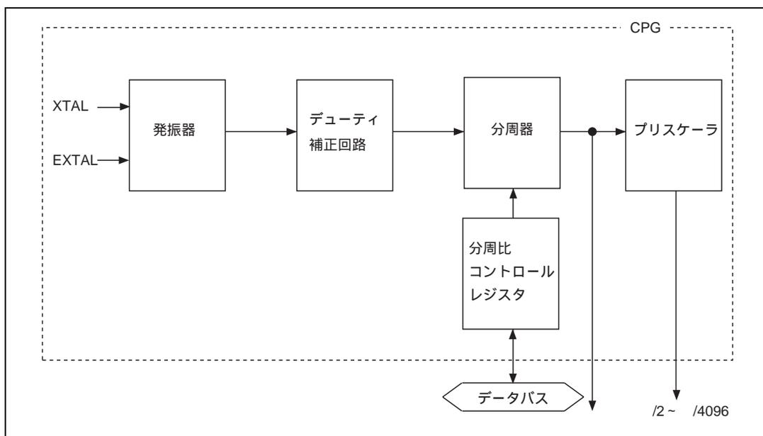
図 20.1 クロック発振器のブロック図
