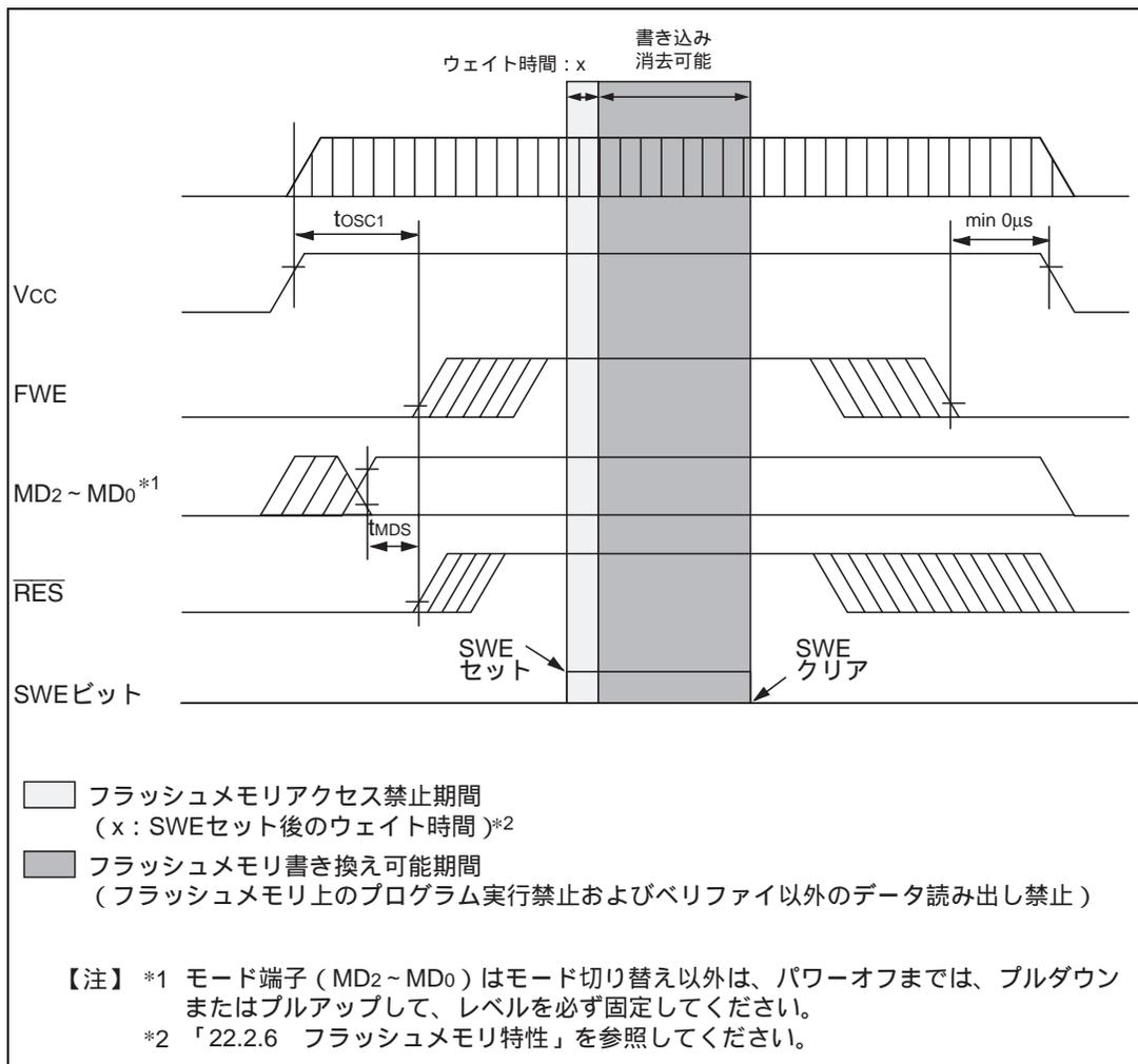
図 17.17 電源投入/切断タイミング (ユーザプログラムモード)
