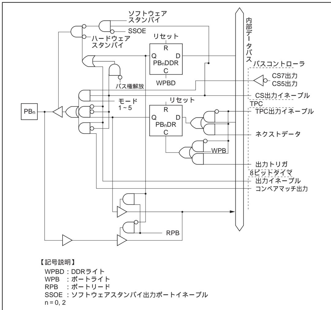
図 C.11 (a) ポート B ブロック図 (PB<sub>0</sub>、PB<sub>2</sub> 端子)
