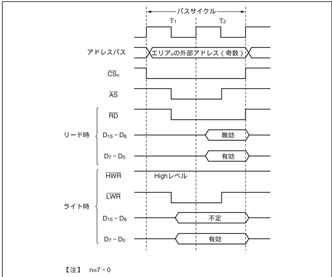
図 6.17 16 ビット 2 ステートアクセス空間のバス制御信号タイミング (2)
