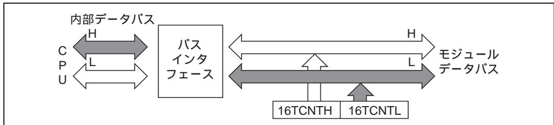
図 8.9 16TCNTL のアクセス動作 [ 16TCNTL CPU (下位バイト) ]
