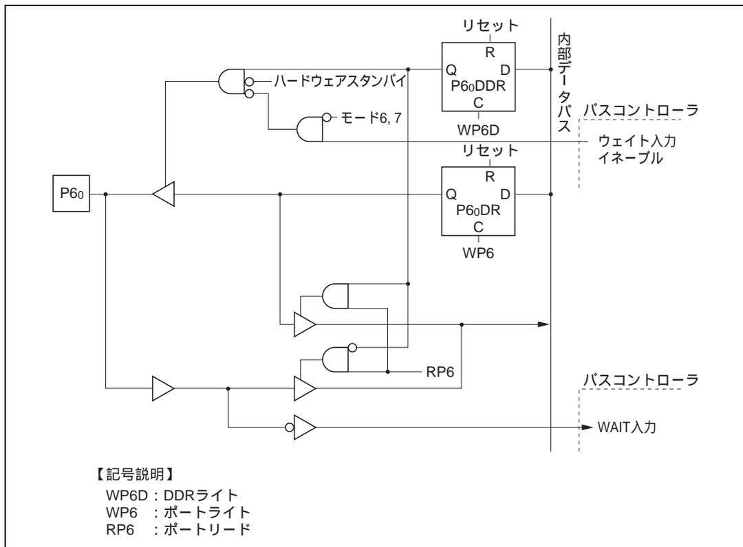
図 C.6 (a) ポート6ブロック図 (P6<sub>0</sub>端子)
