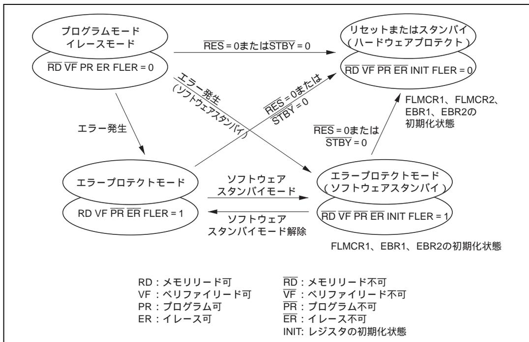
図 18.12 フラッシュメモリの状態遷移図 (モード 5、7 (内蔵 ROM が有効) で FWE 端子に High レベル印加時)
