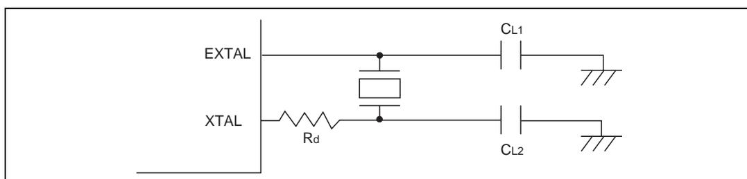
図 20.2 水晶発振子を接続する場合の接続例
