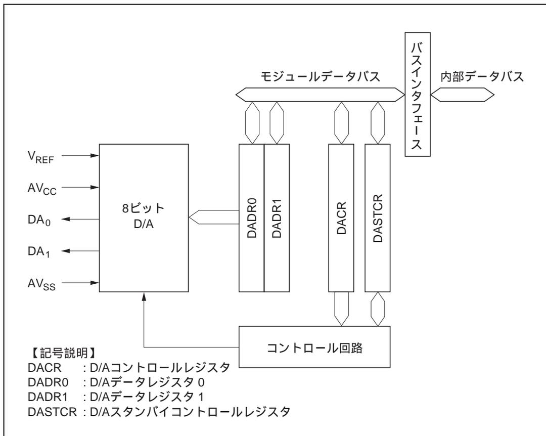
図 15.1 D/A 変換器のブロック図
