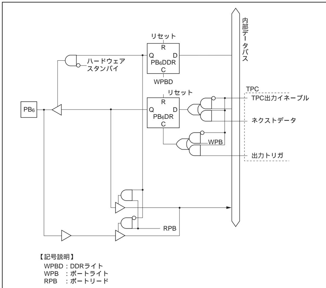
図 C.11 (e) ポート B ブロック図 (PB<sub>6</sub> 端子)
