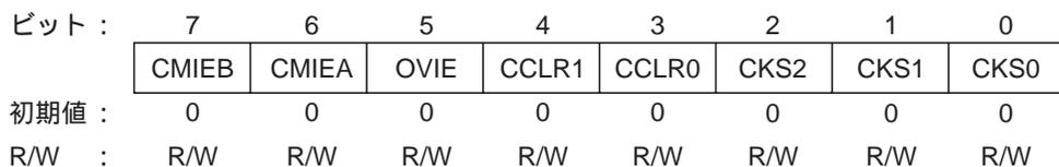
8TCR はそれぞれ 8 ビットのリード/ライト可能なレジスタで、8TCNT の入力クロックの選択、8TCNT のクリア指定、および各割り込み要求の許可を制御します。
