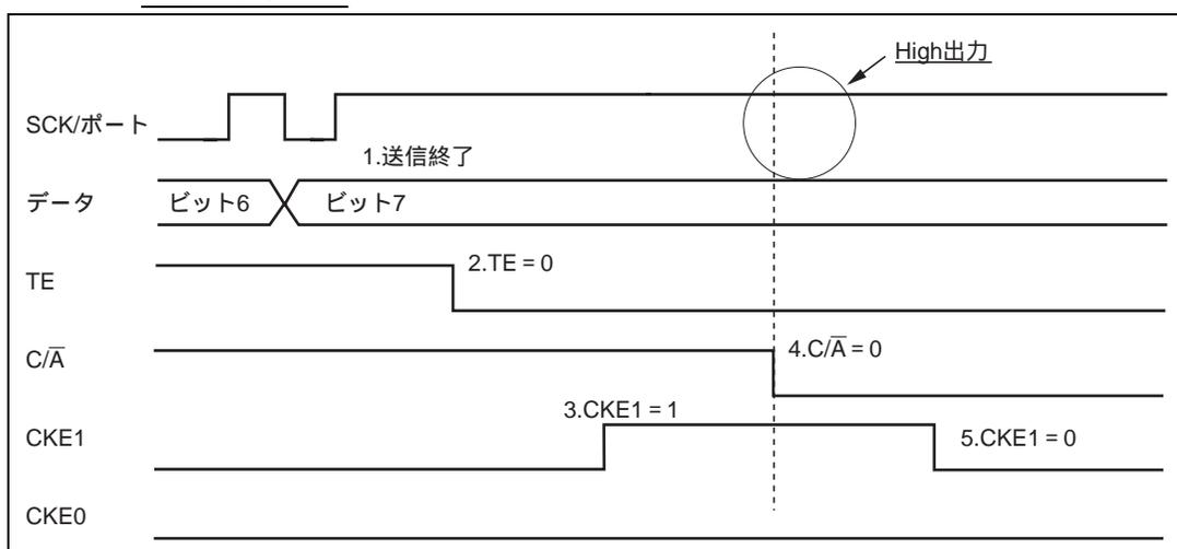
図 12.27 SCK 端子からポート端子へ切り替える時の動作 (Low 出力の回避例)
