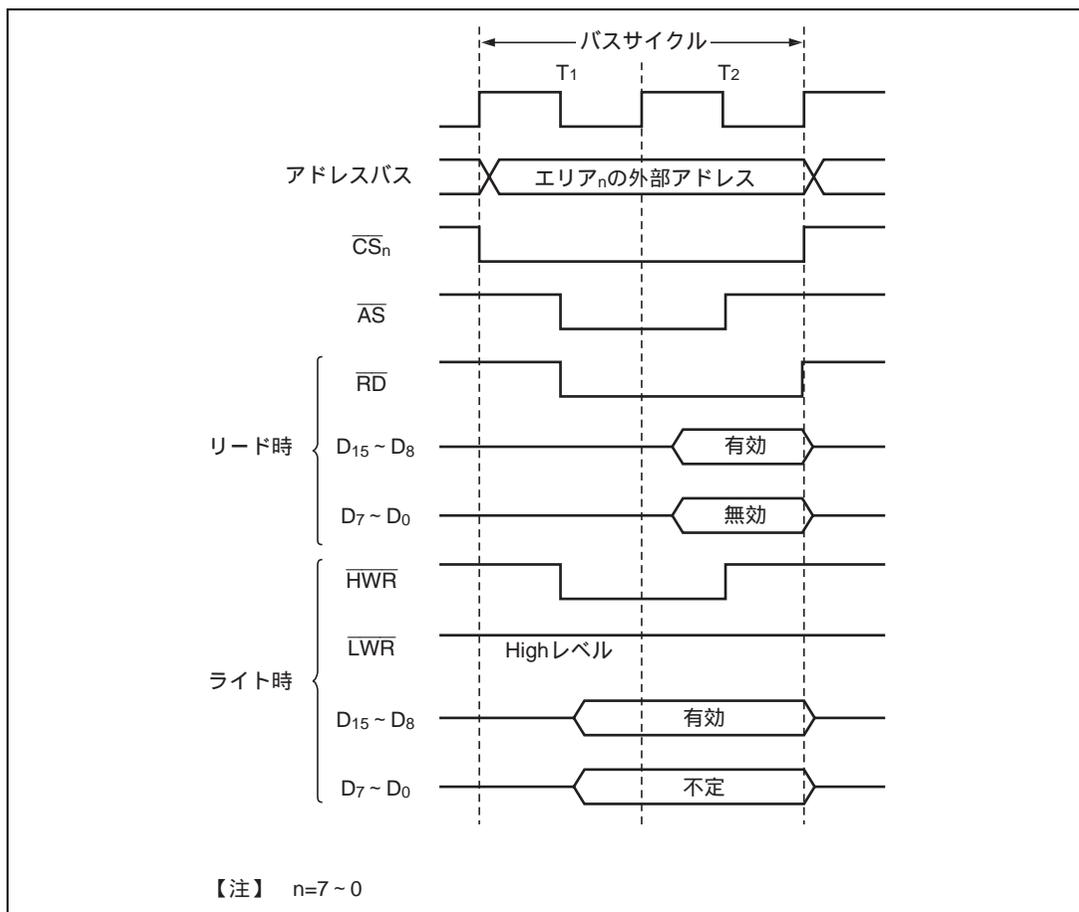
図 6.12 8 ビット 2 ステートアクセス空間のバス制御信号タイミング
