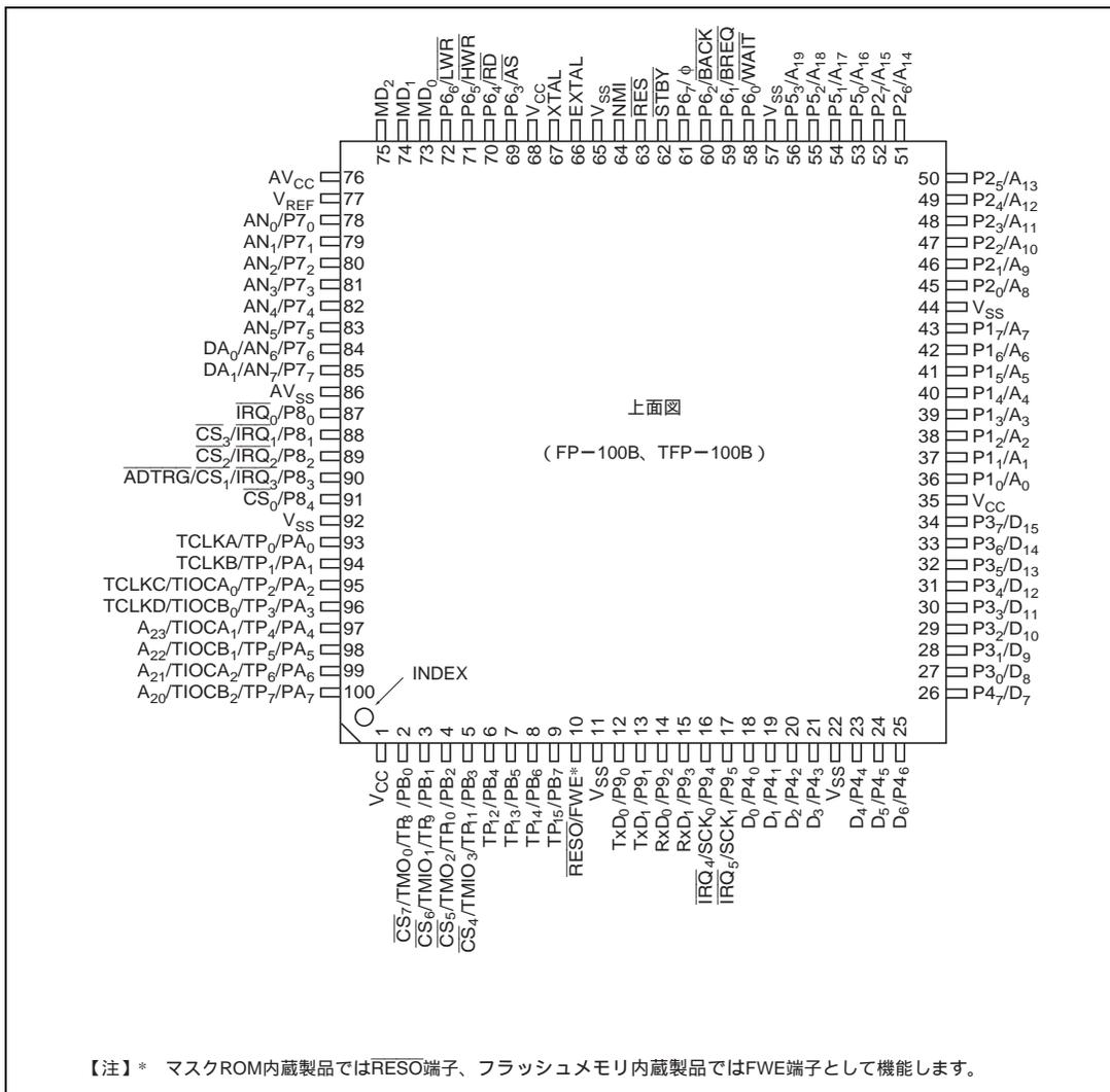
図 1.2 H8/3062F-ZTAT R マスク品、H8/3062 マスク ROM 品、H8/3061 マスク ROM 品、H8/3060 マスク ROM 品のピン配置図 (FP-100B、TFP-100B パッケージ：上面図)
