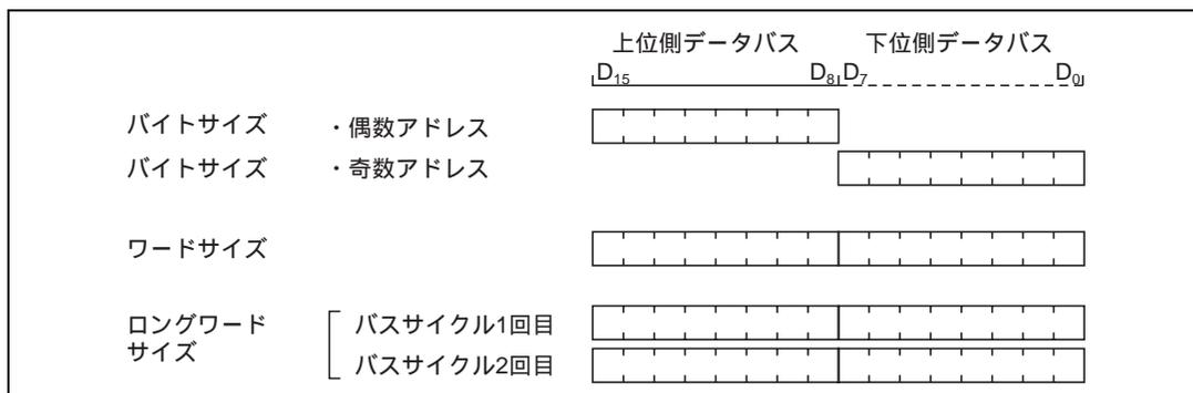
図 6.10 アクセスサイズとデータアライメント制御 (16 ビットアクセス空間)
