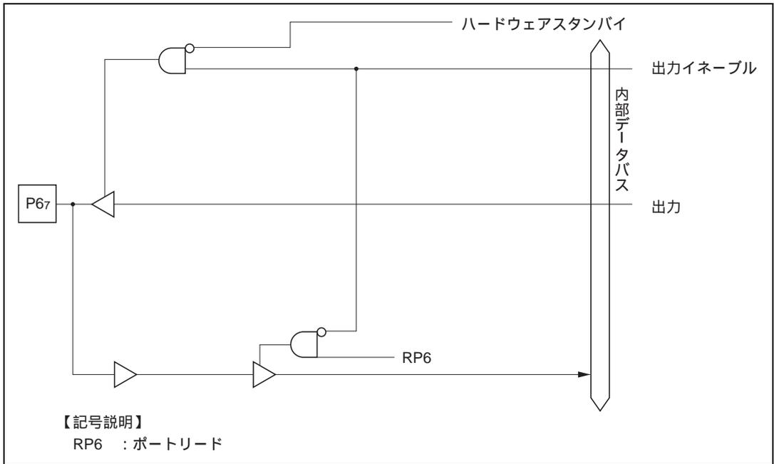
図 C.6 (e) ポート 6 ブロック図 (P6, 端子)
