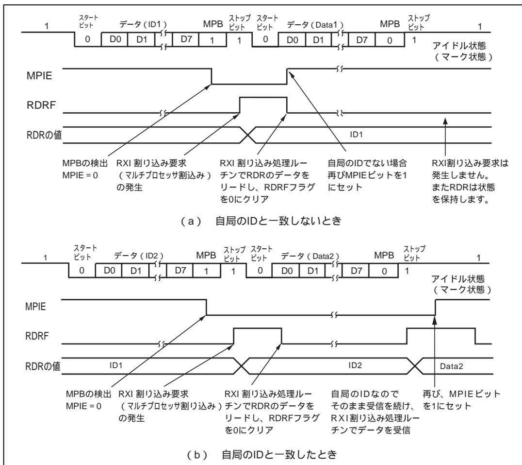
図 12.15 SCI の受信時の動作例
