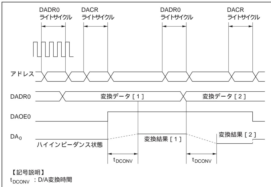
図 15.2 D/A 変換器の動作例
