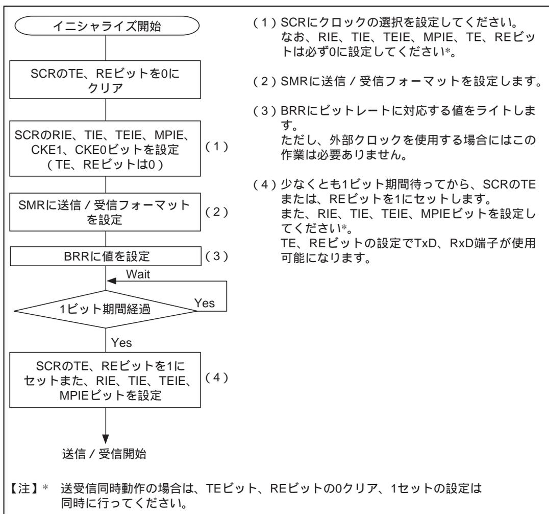
図 12.17 SCI のイニシャライズフローチャートの例
