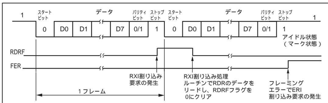
図 12.9 SCI の受信時の動作例 (8 ビットデータ / パリティあり / 1 ストップビットの例)
