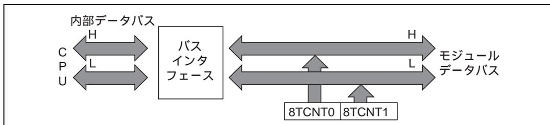
図 9.3 8TCNT のアクセス動作 [ 8TCNT CPU (ワード) ]
