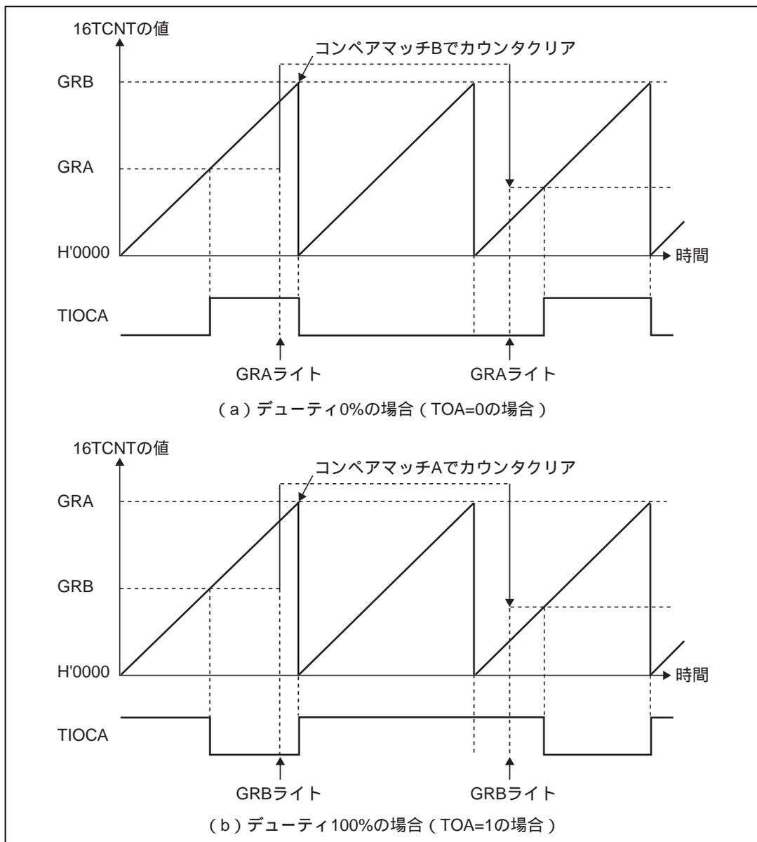
図 8.28 PWMモードの動作例
