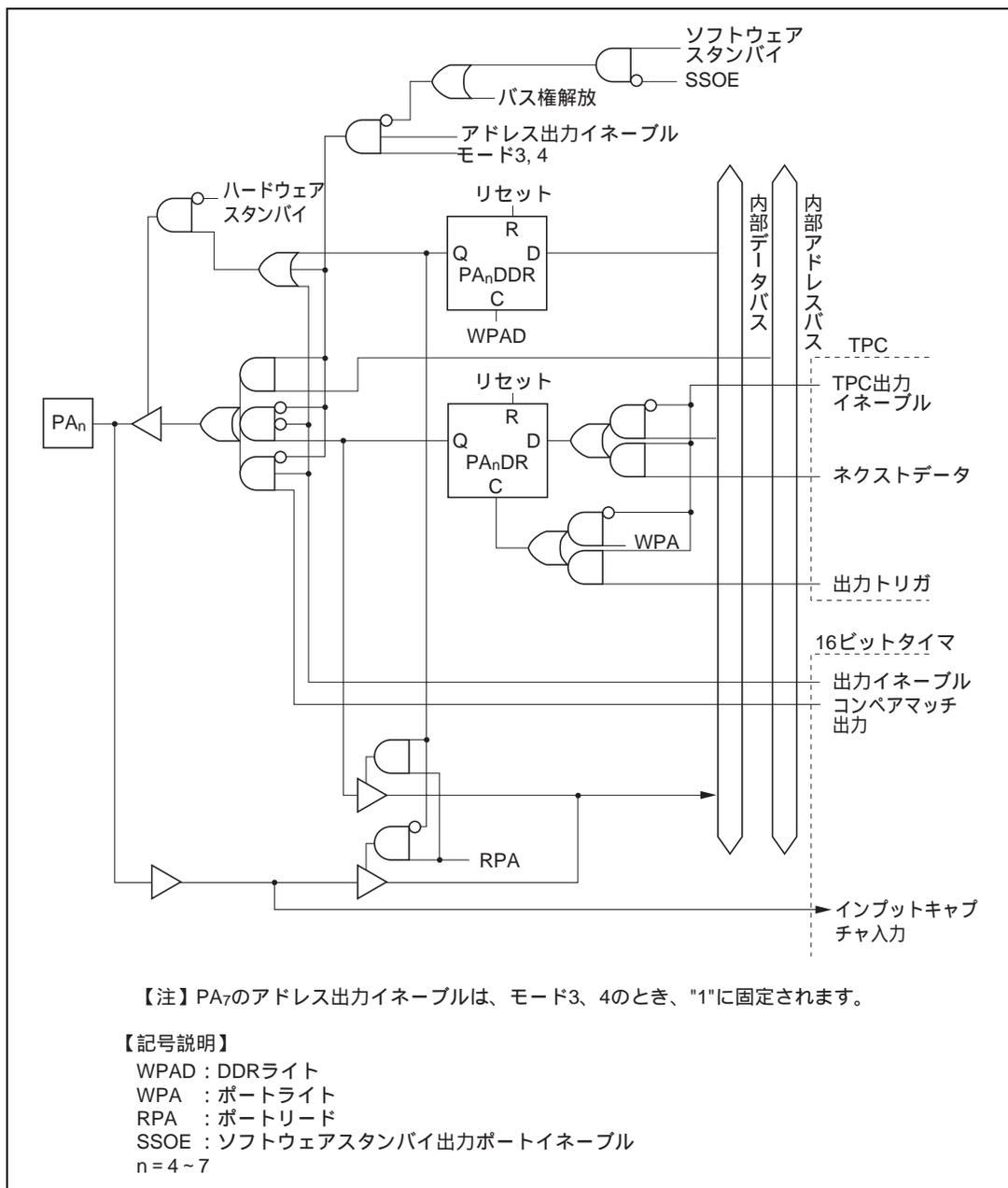
図 C.10 (c) ポート A ブロック図 (PA<sub>4</sub> ~ PA<sub>7</sub>端子)
