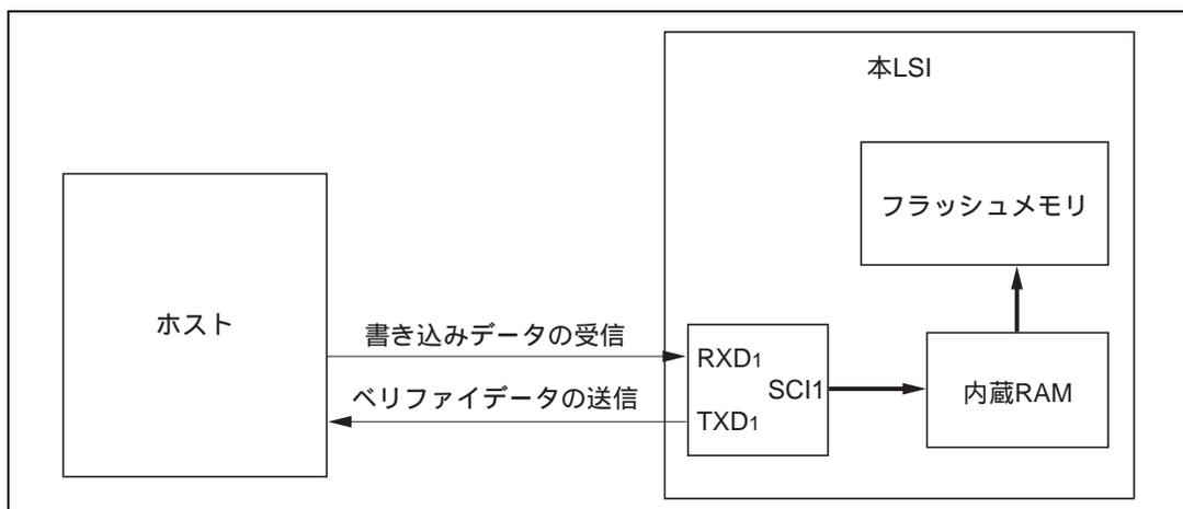
図 17.5 ブートモード時のシステム構成図
