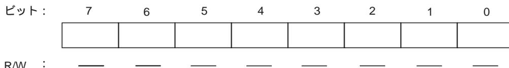
SCI は、RSR に RxD 端子から入力されたシリアルデータを LSB (ビット 0) から受信した順にセットし、パラレルデータに変換します。1 バイトのデータ受信を終了すると、データは自動的に RDR へ転送されます。
