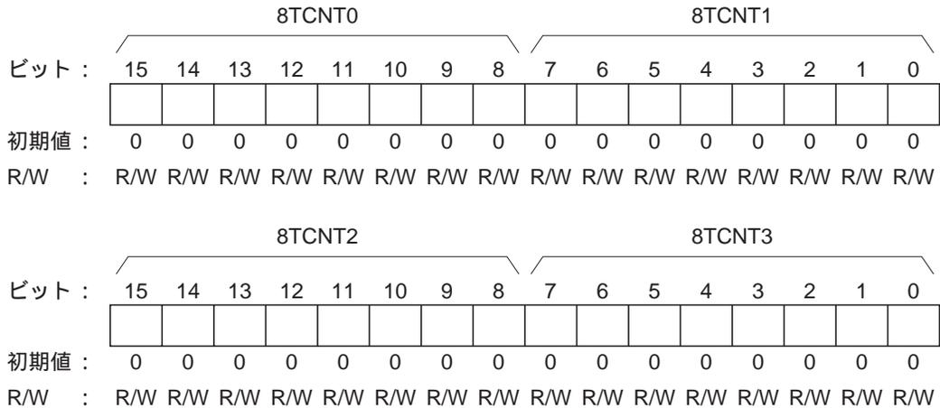
8TCNT はそれぞれ 8 ビットのリード/ライト可能なアップカウンタで、入力する内部または外部クロックによってカウントアップされます。入力するクロックは、8TCR の CKS2 ~ CKS0 ビットで選択します。8TCNT の値は、CPU から常にリード/ライト可能です。
