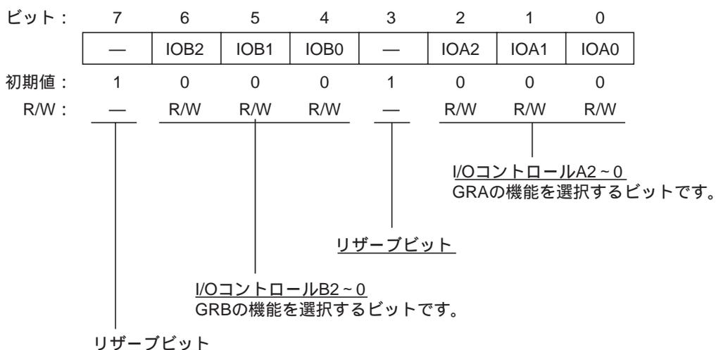
TIOR は 8 ビットのリード/ライト可能なレジスタで、GRA、GRB をアウトプットコンペアレジスタとして使用するか、インプットキャプチャレジスタとして使用するかを選択します。また TIORA、TIORB 端子の機能を選択します。アウトプットコンペアレジスタを選択した場合は出力設定を選択し、インプットキャプチャレジスタを選択した場合はインプットキャプチャ信号の入力エッジを選択します。
