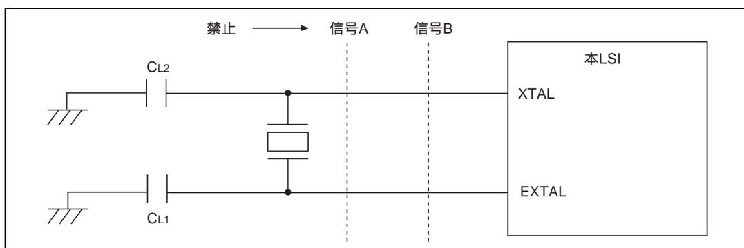
図 20.4 発振回路部のボード設計に関する注意事項
