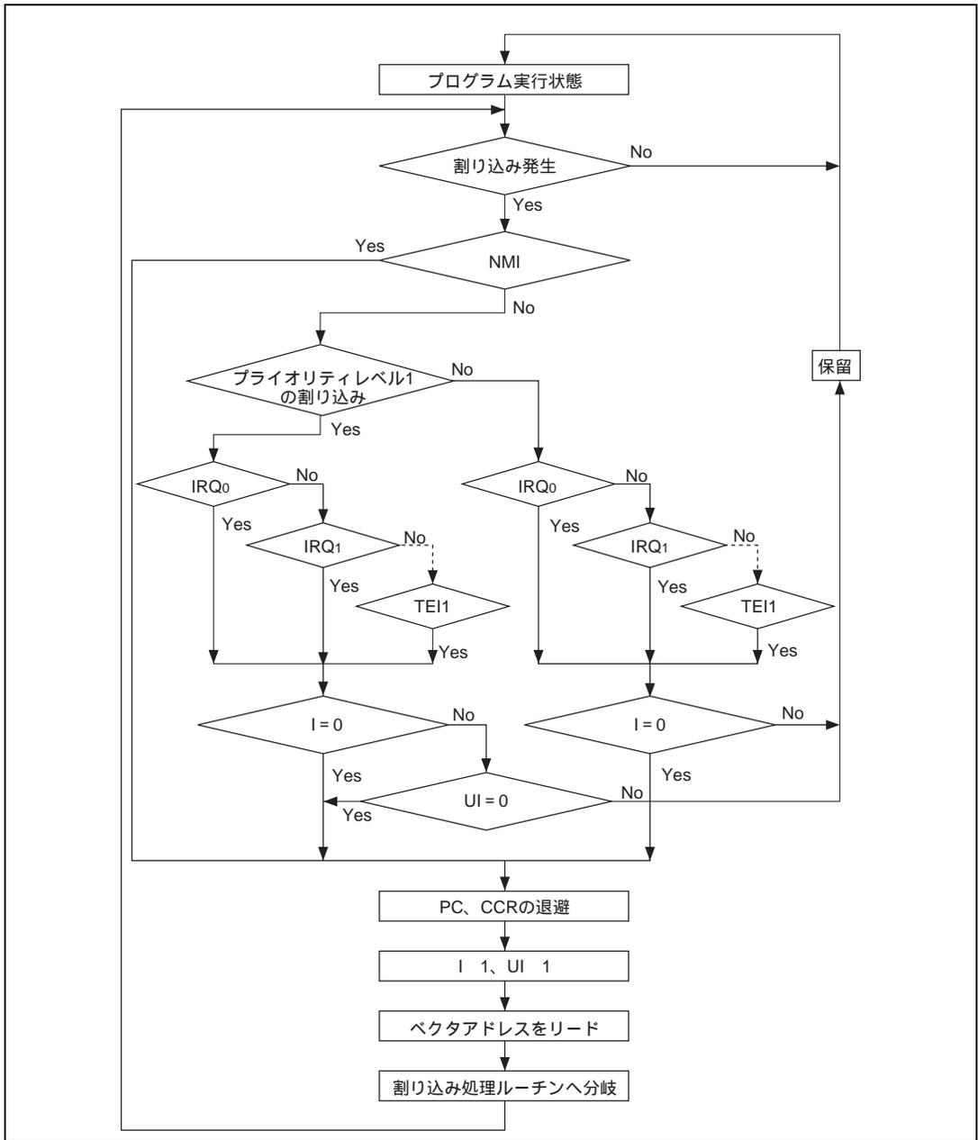
図 5.6 UE = 0 の場合の割り込み受け付けまでのフロー
