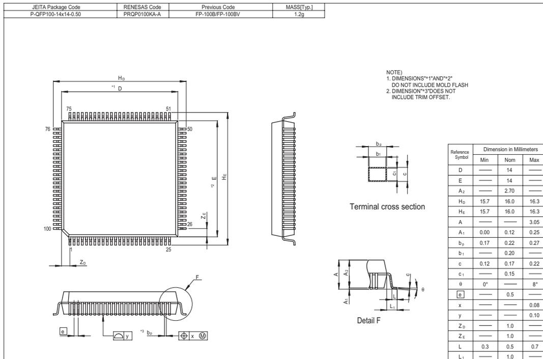
図 H.1 外形寸法図 (FP-100B) 単位 : mm
