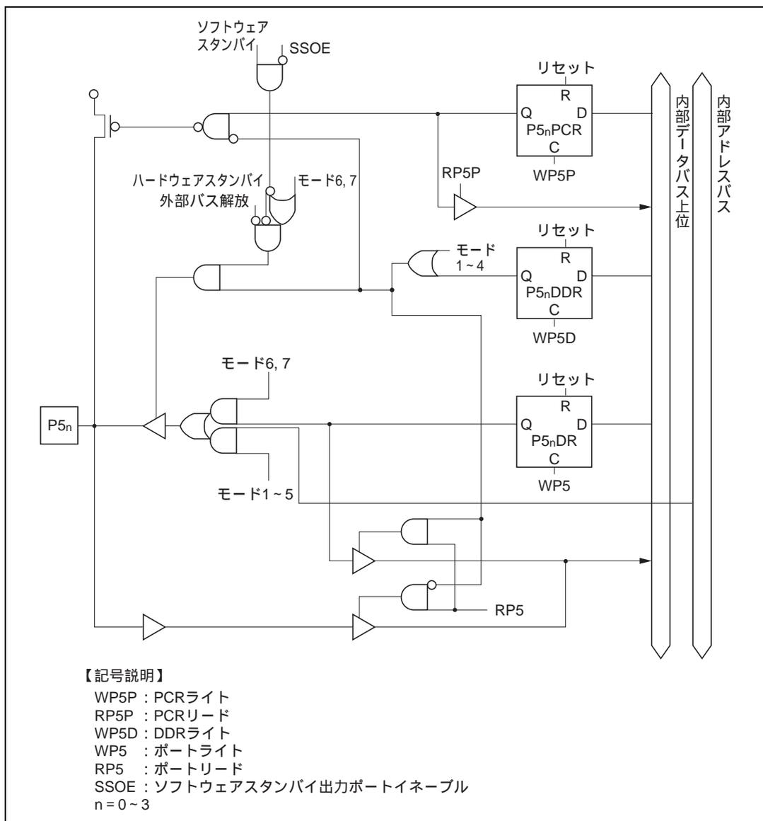
図 C.5 ポート5ブロック図 (P5<sub>0</sub>~P5<sub>3</sub>端子)
