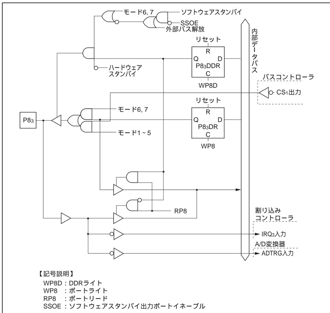
図 C.8 (c) ポート 8 ブロック図 (P8<sub>3</sub>端子)
