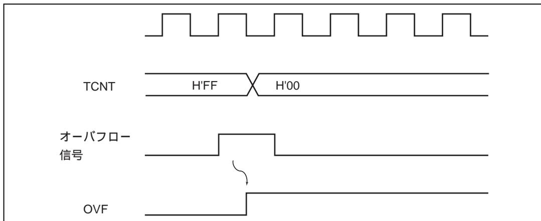
図 11.6 OVF フラグのセットタイミング
