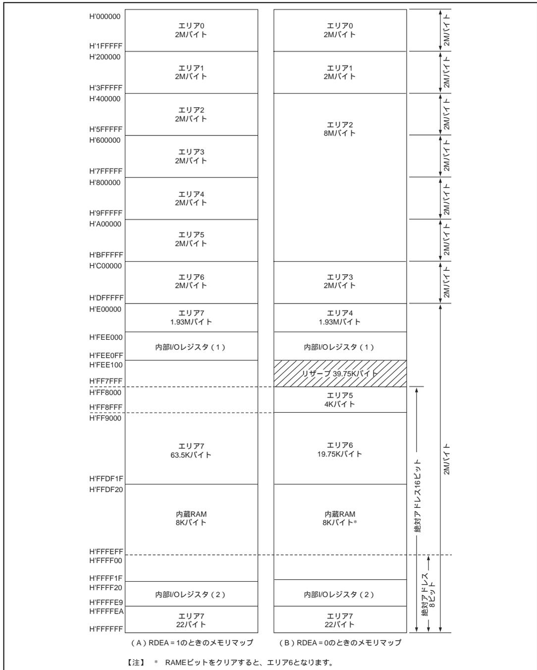
図 6.5 16M バイトモード時のメモリマップ (H8/3064F-ZTAT B マスク品、H8/3064 マスク ROM B マスク品の場合) (3)
