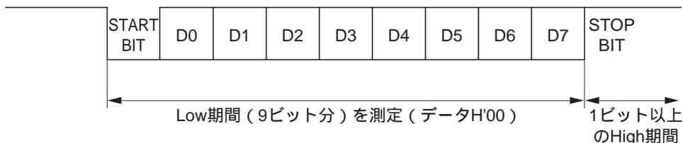
ブートモードが起動すると、本 LSI はホストより連続送信される調歩同期式 SCI 通信のデータ (H'00) の Low 期間を測定します。このときの SCI 受信 / 送信フォーマットを「8 ビットデータ、1 ストップビット、パリティなし」に設定してください。本 LSI は、測定した Low 期間よりホストの送信するビットレートを計算し、ビット調整終了合図としてホストへ H'00 を 1 バイト送信します。ホストは、この調整終了合図 (H'00) を正常に受信したことを確認し、本 LSI へ H'55 を 1 バイト送信してください。受信が正常に行われなかった場合は、再度ブートモードを起動し (リセット)、上述の操作を行ってください。ホストが送信するビットレート、および本 LSI のシステムクロックの周波数によってホストと本 LSI のビットレートに誤差が生じます。正常に SCI を動作させるために、ホストの転送ビットレートを (19,200、9,600、4,800) bps\* に設定してください。
