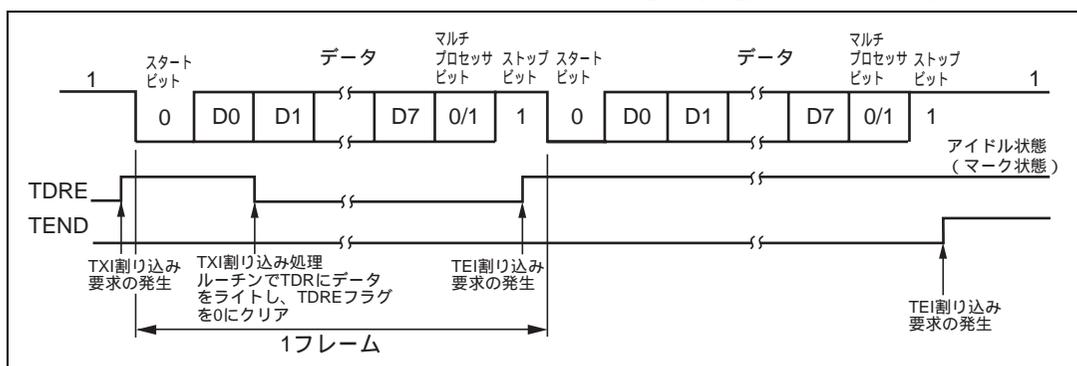
図 12.12 SCI の送信時の動作例
