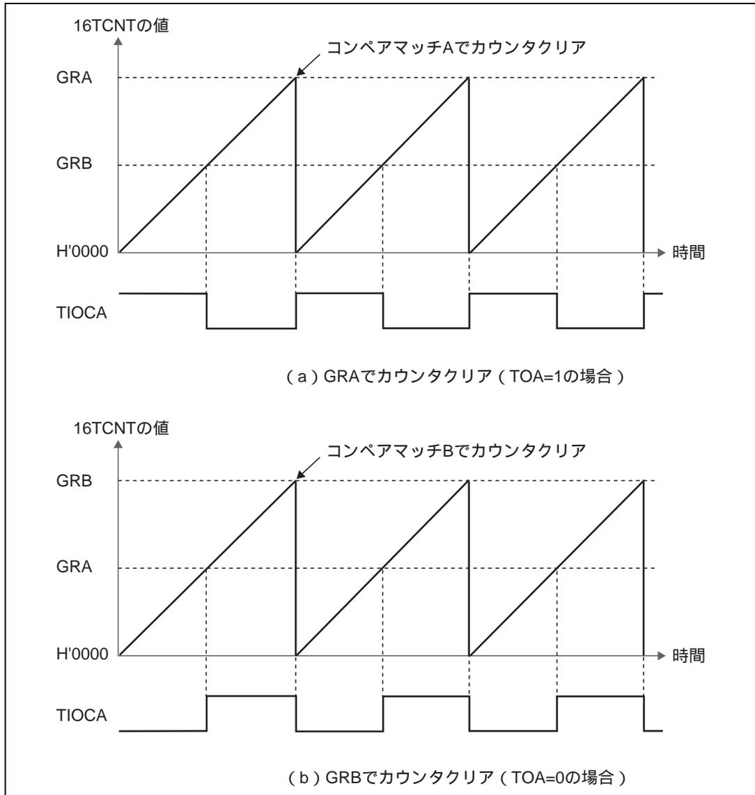
図 8.27 PWMモードの動作例
