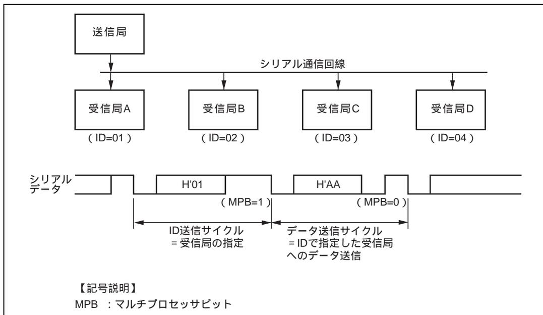
図 12.10 マルチプロセッサフォーマットを使用したプロセッサ間通信の例
