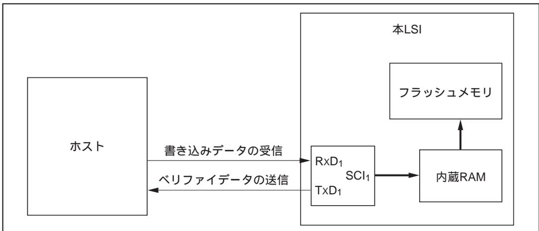
図 19.6 ブートモード時のシステム構成図
