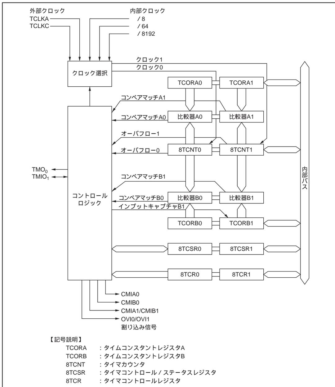
図 9.1 8ビットタイマのブロック図(2チャンネル分:グループ0の場合)
