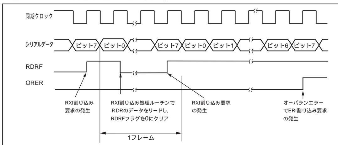
図 12.22 SCI の受信時の動作例
