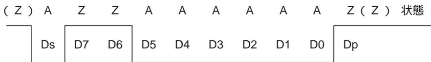
インバースコンベンションタイプは、論理 1 レベルを状態 A に、論理 0 レベルを状態 Z に対応付け、MSB ファーストで送受信する方式です。上記の開始キャラクタのデータは H'3F となります。
