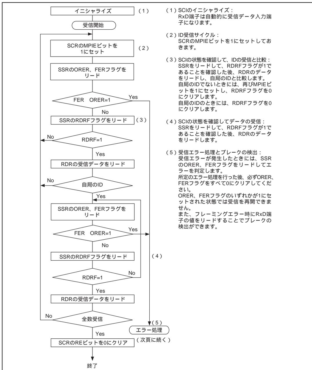
図 12.13 マルチプロセッサシリアル受信のフローチャートの例 (1)
