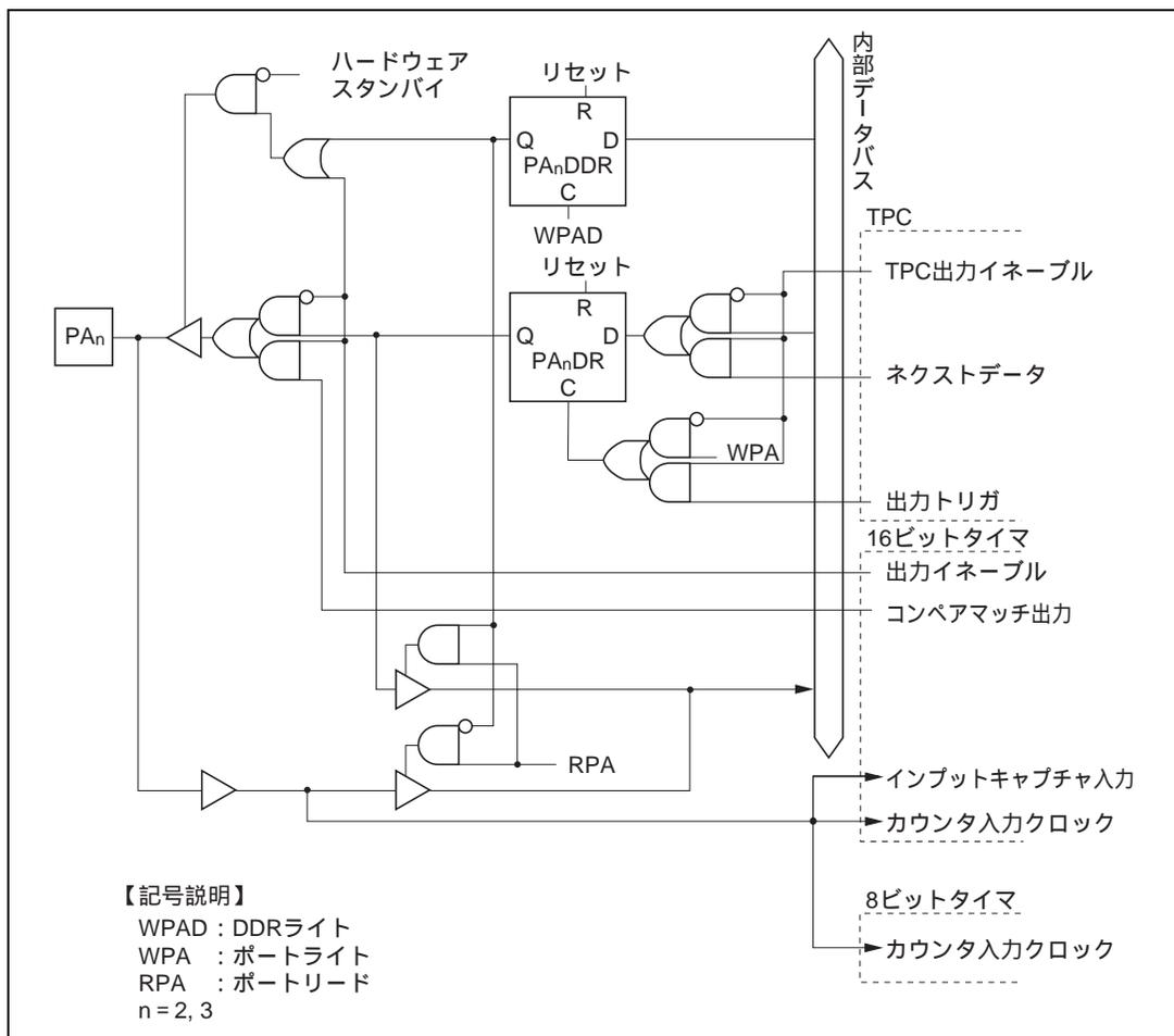
図 C.10 (b) ポート A ブロック図 (PA<sub>2</sub>、PA<sub>3</sub> 端子)
