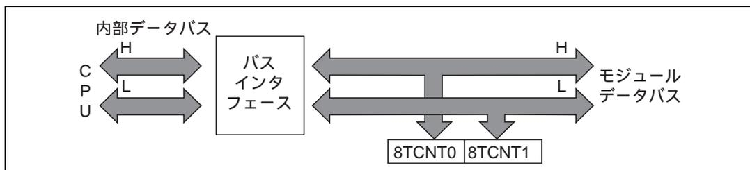
図 9.2 8TCNT のアクセス動作 [ CPU 8TCNT (ワード) ]
