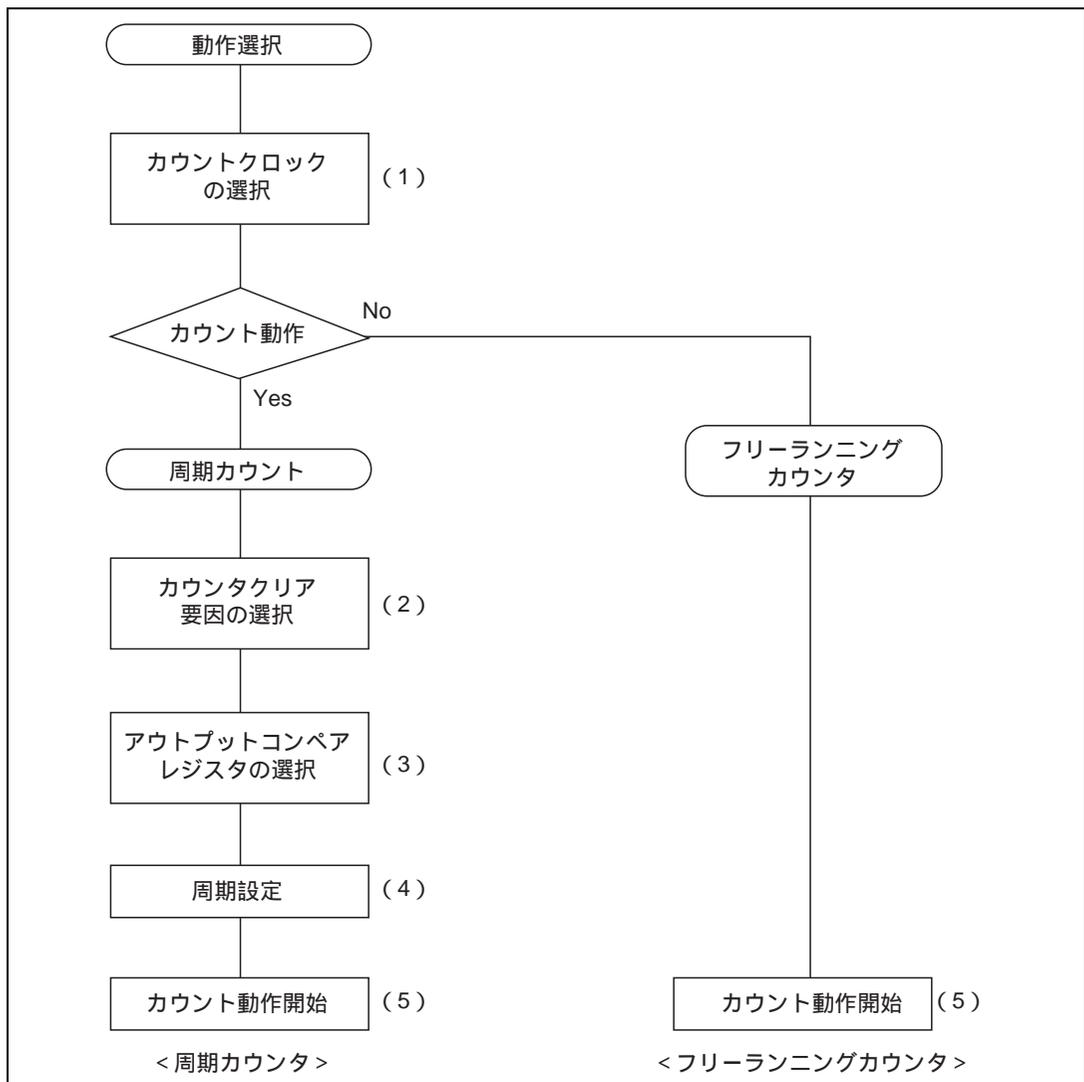
図 8.12 カウント動作設定手順例
