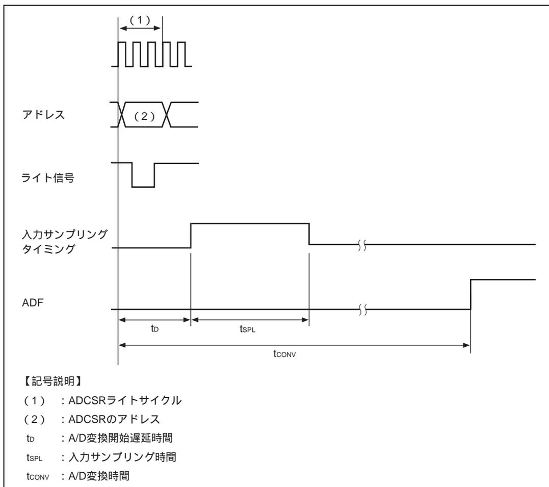
図 14.5 A/D 変換タイミング
