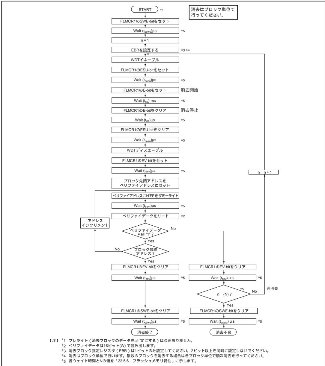
図 19.12 イレース/イレースベリファイフロー (単一ブロック消去)
