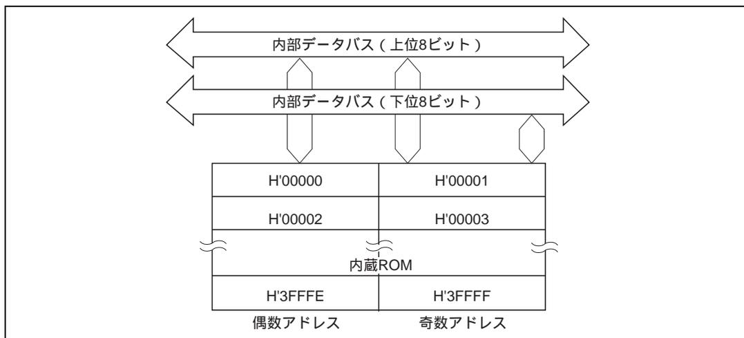
図 18.19 ROM のブロック図 (H8/3064 マスク ROM B マスク品の場合)
