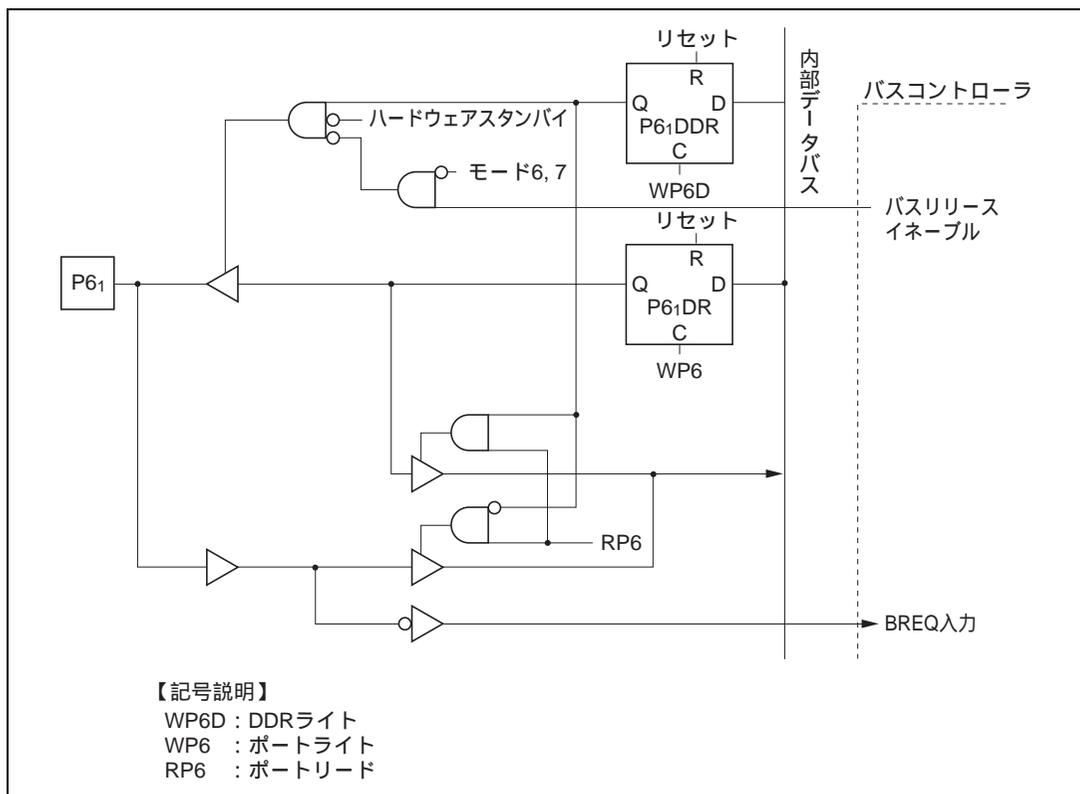
図 C.6 (b) ポート 6 ブロック図 (P6, 端子)
