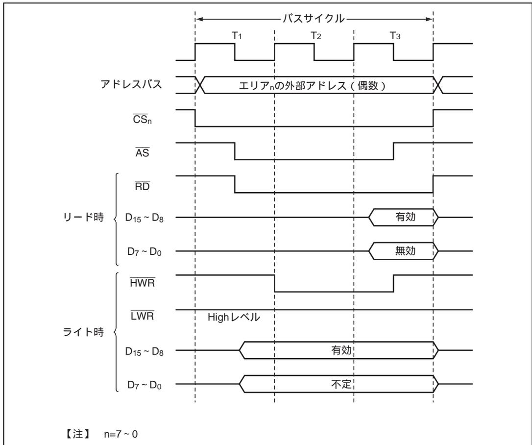
図 6.13 16 ビット 3 ステートアクセス空間のバス制御信号タイミング (1)
