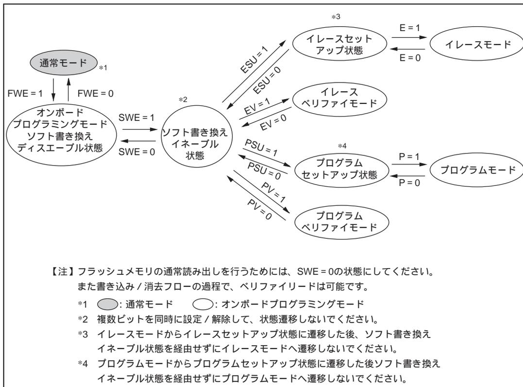
図 19.10 FLMCR1 の各ビット設定による状態遷移
