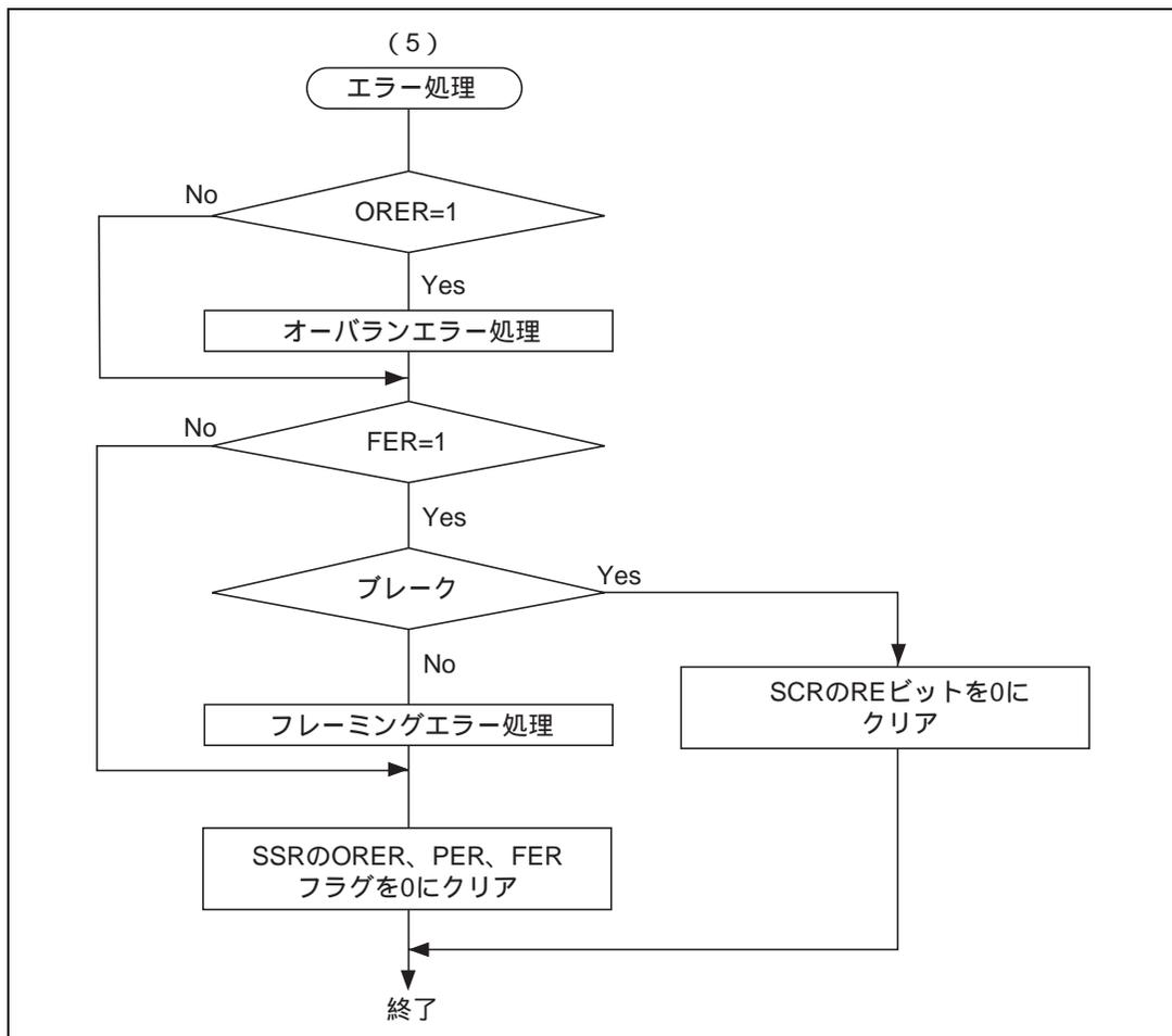
図 12.14 マルチプロセッサシリアル受信のフローチャートの例 (2)
