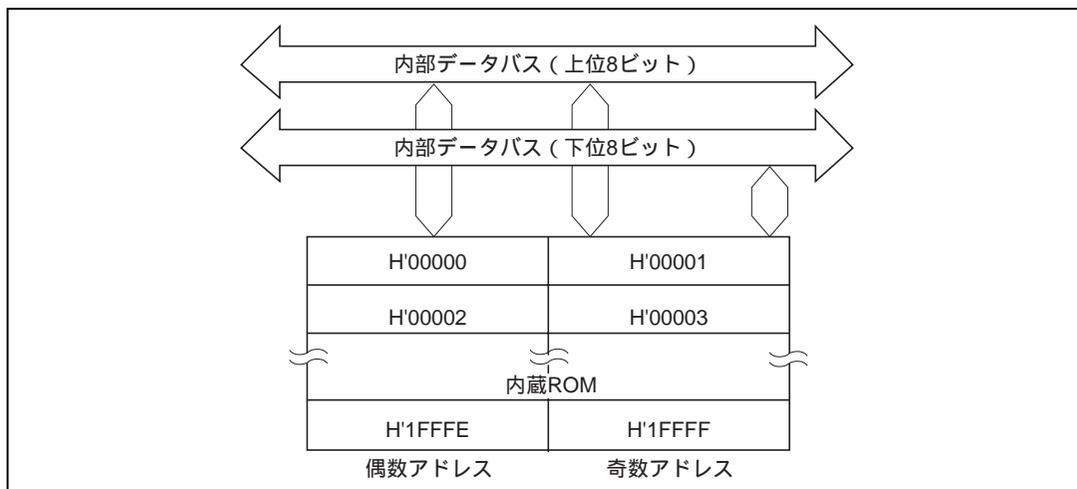
図 19.19 ROM のブロック図 ( H8/3062 マスク ROM B マスク品の場合 )
