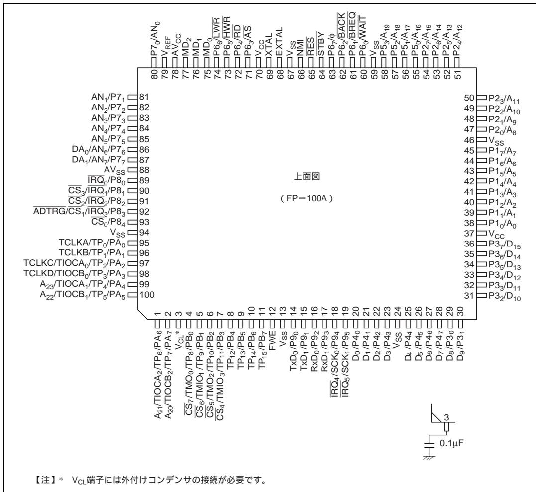
図 1.5 H8/3064F-ZTAT B マスク品、H8/3062F-ZTAT B マスク品、H8/3064 マスク ROM B マスク品、H8/3062 マスク ROM B マスク品、H8/3061 マスク ROM B マスク品、H8/3060 マスク ROM B マスク品のピン配置図 (FP-100A パッケージ: 上面図)
