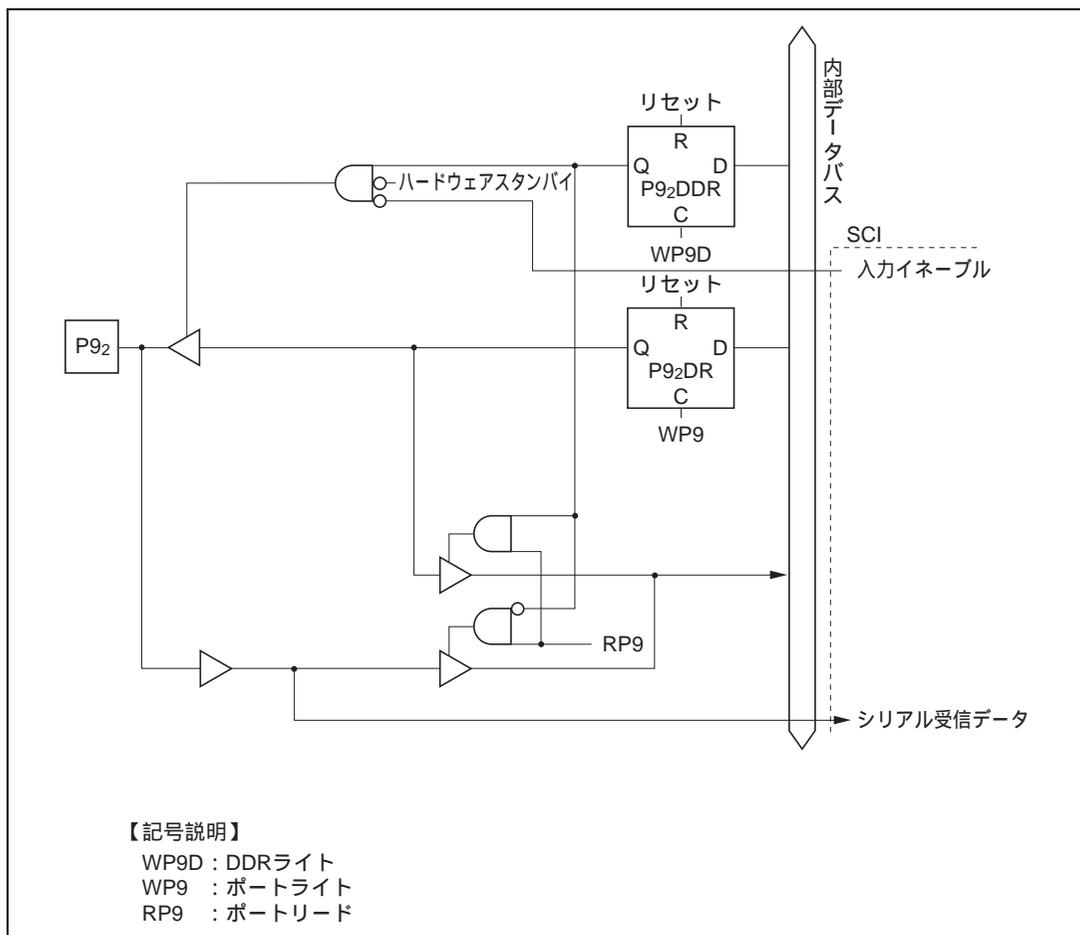
図 C.9 (c) ポート 9 ブロック図 (P9<sub>2</sub> 端子)
