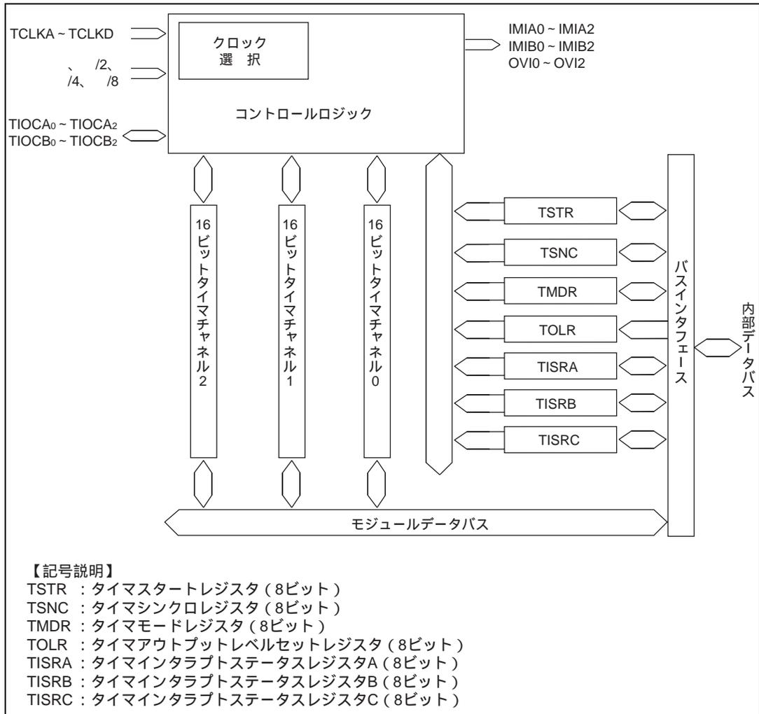
図8.1 16ビットタイマのブロック図(全体図)
