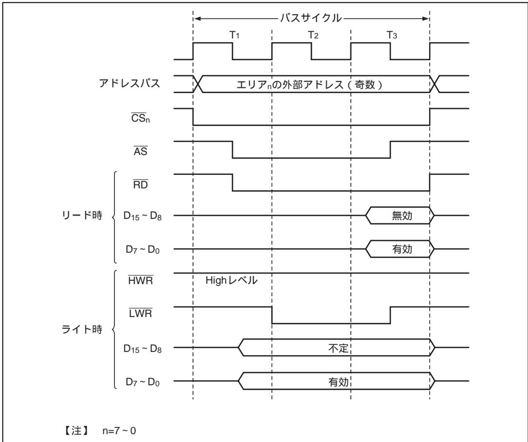
図 6.14 16 ビット 3 ステートアクセス空間のバス制御信号タイミング (2)
