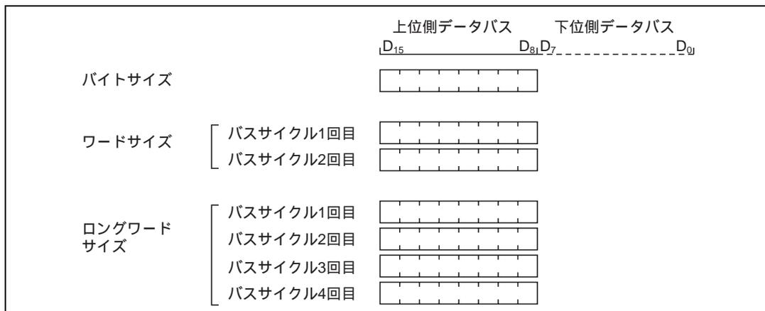
図 6.9 アクセスサイズとデータアライメント制御 (8 ビットアクセス空間)
