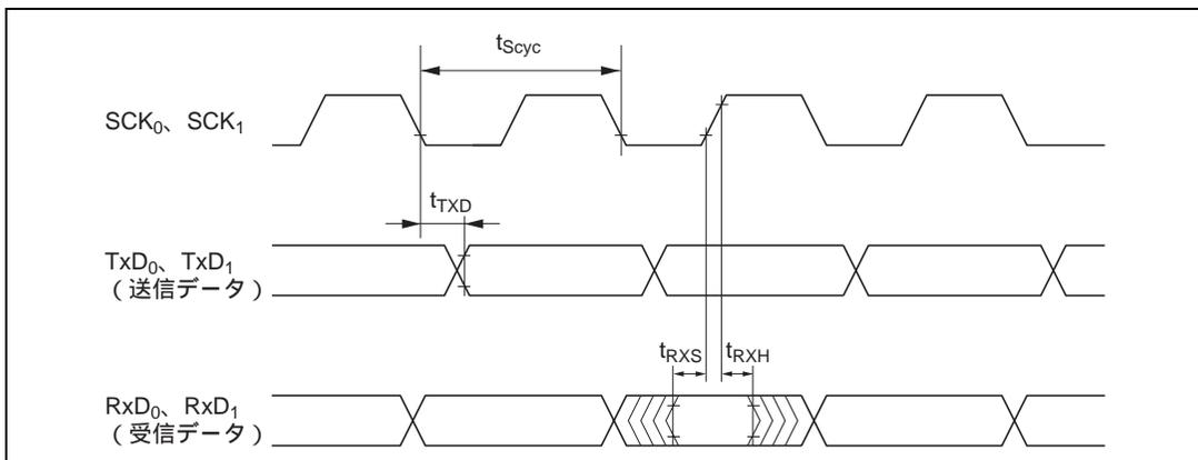
図 22.31 クロック同期式モード時の SCI 入出力タイミング
