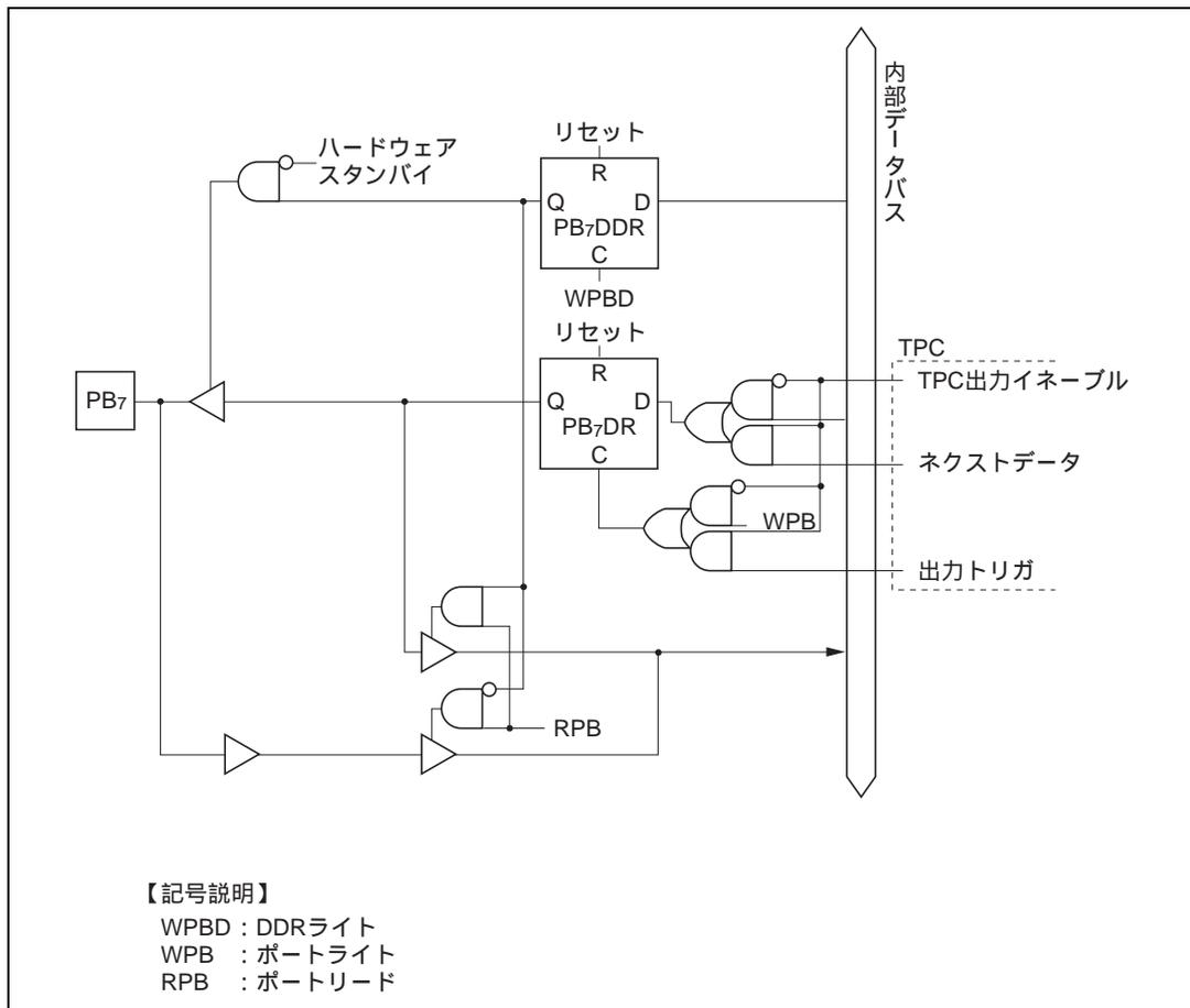
図 C.11 (f) ポート B ブロック図 (PB<sub>7</sub> 端子)
