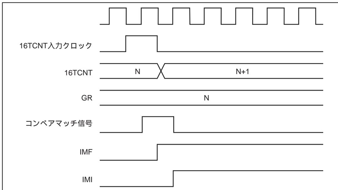
図 8.33 コンペアマッチ時の IMFA、IMFB フラグのセットタイミング
