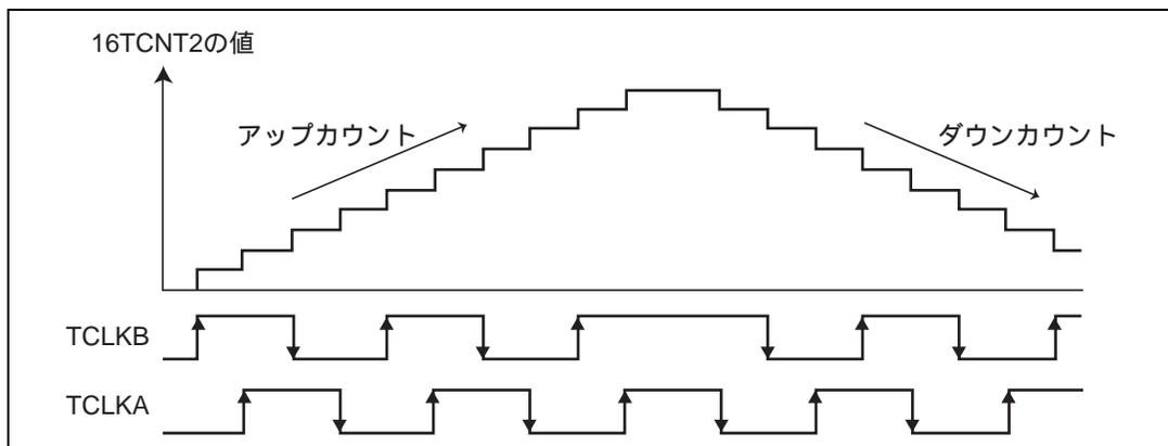
図 8.30 位相計数モードの動作例
