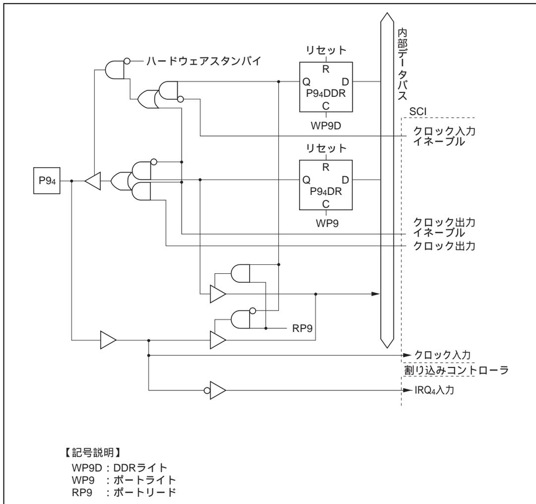
図 C.9 (e) ポート9ブロック図 (P9<sub>4</sub>端子)
