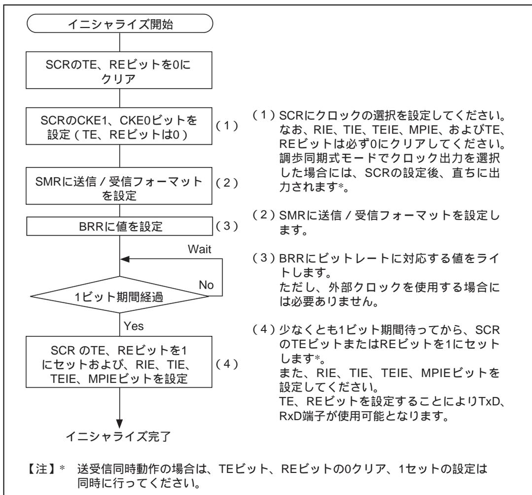
図 12.4 SCI のイニシャライズフローチャートの例
