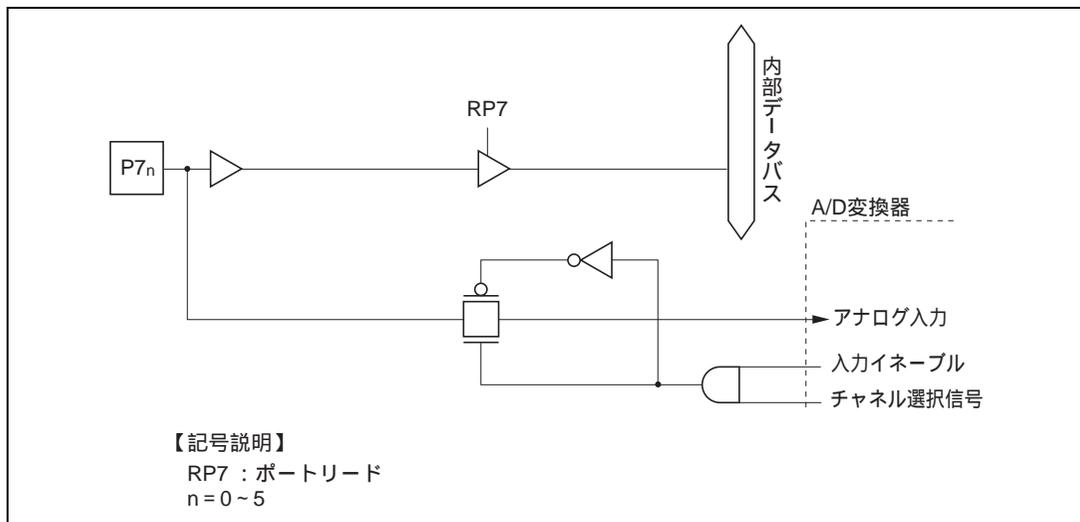
図 C.7 (a) ポート7ブロック図 ( $P7_0 \sim P7_5$  端子)
