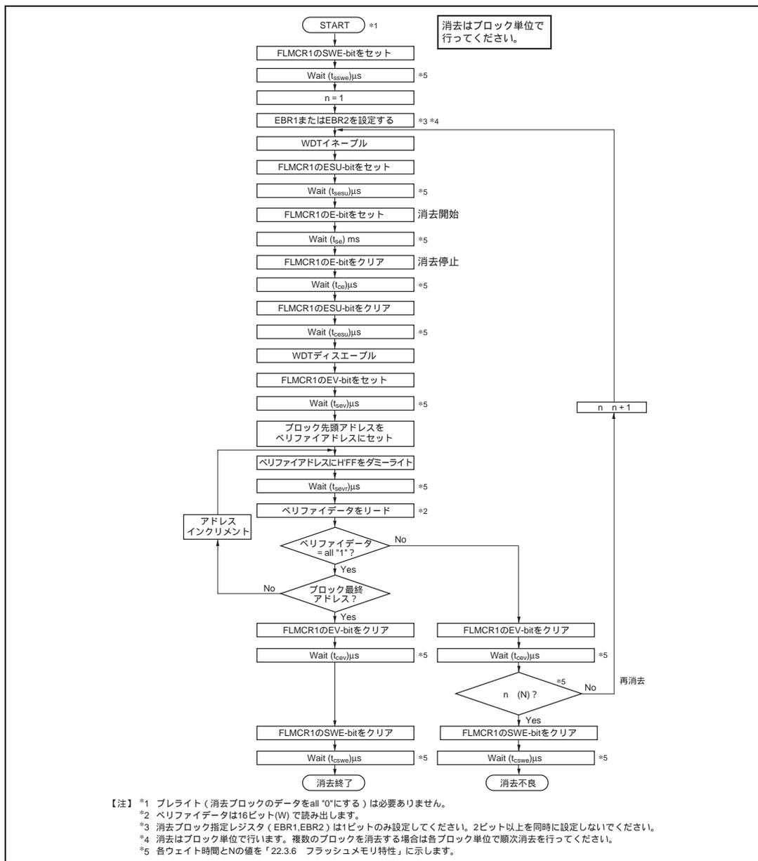
図 18.11 イレース / イレースベリファイフロー（単一ブロック消去）
