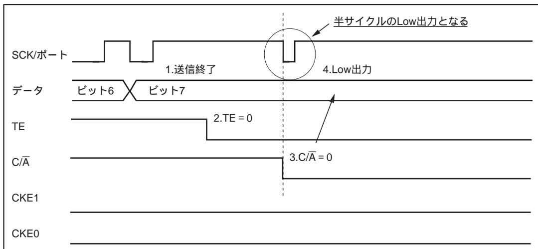
図 12.26 SCK 端子からポート端子へ切り替える時の動作
