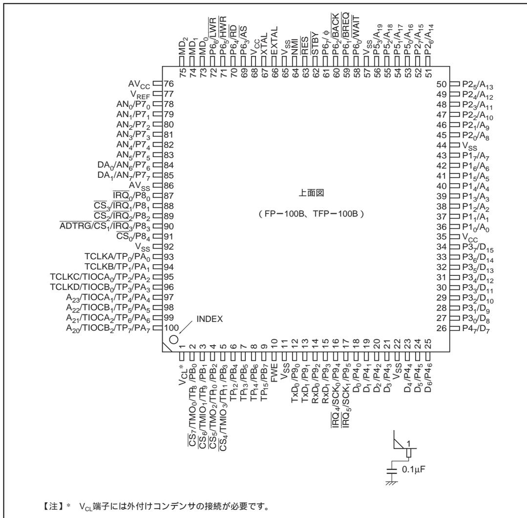
図 1.4 H8/3064F-ZTAT B マスク品、H8/3062F-ZTAT B マスク品、H8/3064 マスク ROM B マスク品、H8/3062 マスク ROM B マスク品、H8/3061 マスク ROM B マスク品、H8/3060 マスク ROM B マスク品のピン配置図 (FP-100B、TFP-100B パッケージ : 上面図)
