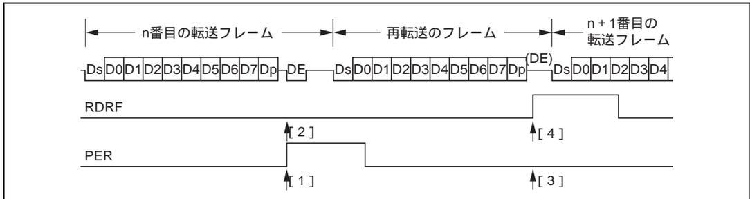
図 13.12 SCI 受信モードの場合の再転送動作
