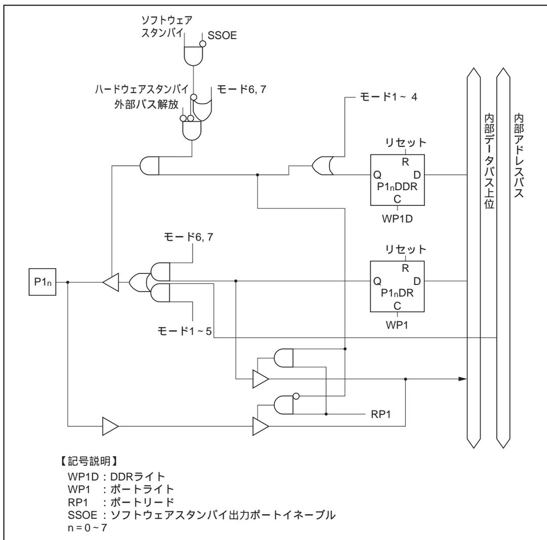
図 C.1 ポート1ブロック図 (P1<sub>0</sub>~P1<sub>7</sub>端子)
