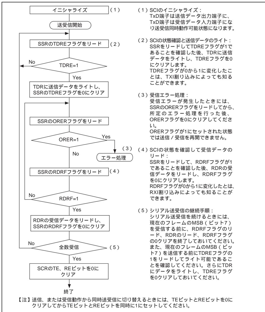
図 12.23 シリアル送受信同時動作のフローチャートの例
