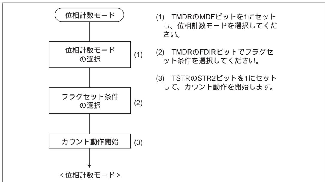
図 8.29 位相計数モードの設定手順例
