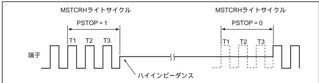
図 21.3 クロック発振開始、発振停止タイミング
