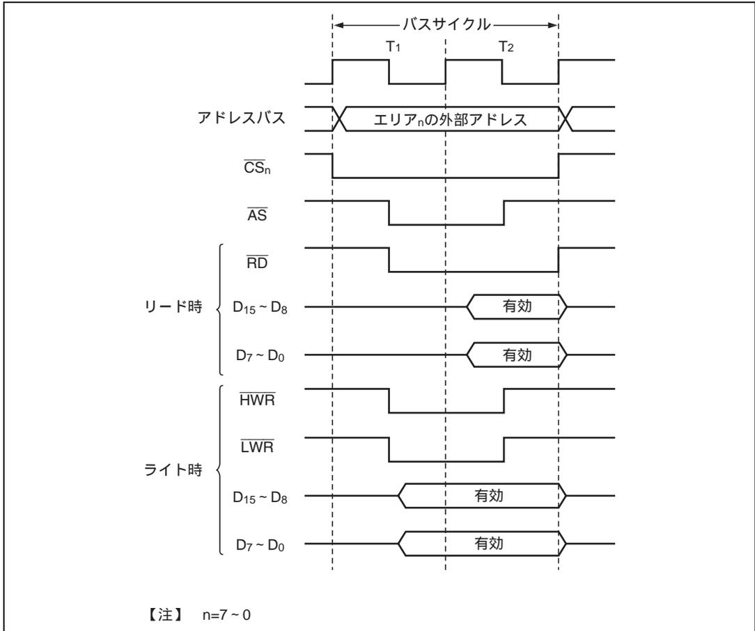
図 6.18 16 ビット 2 ステートアクセス空間のバス制御信号タイミング (3)
