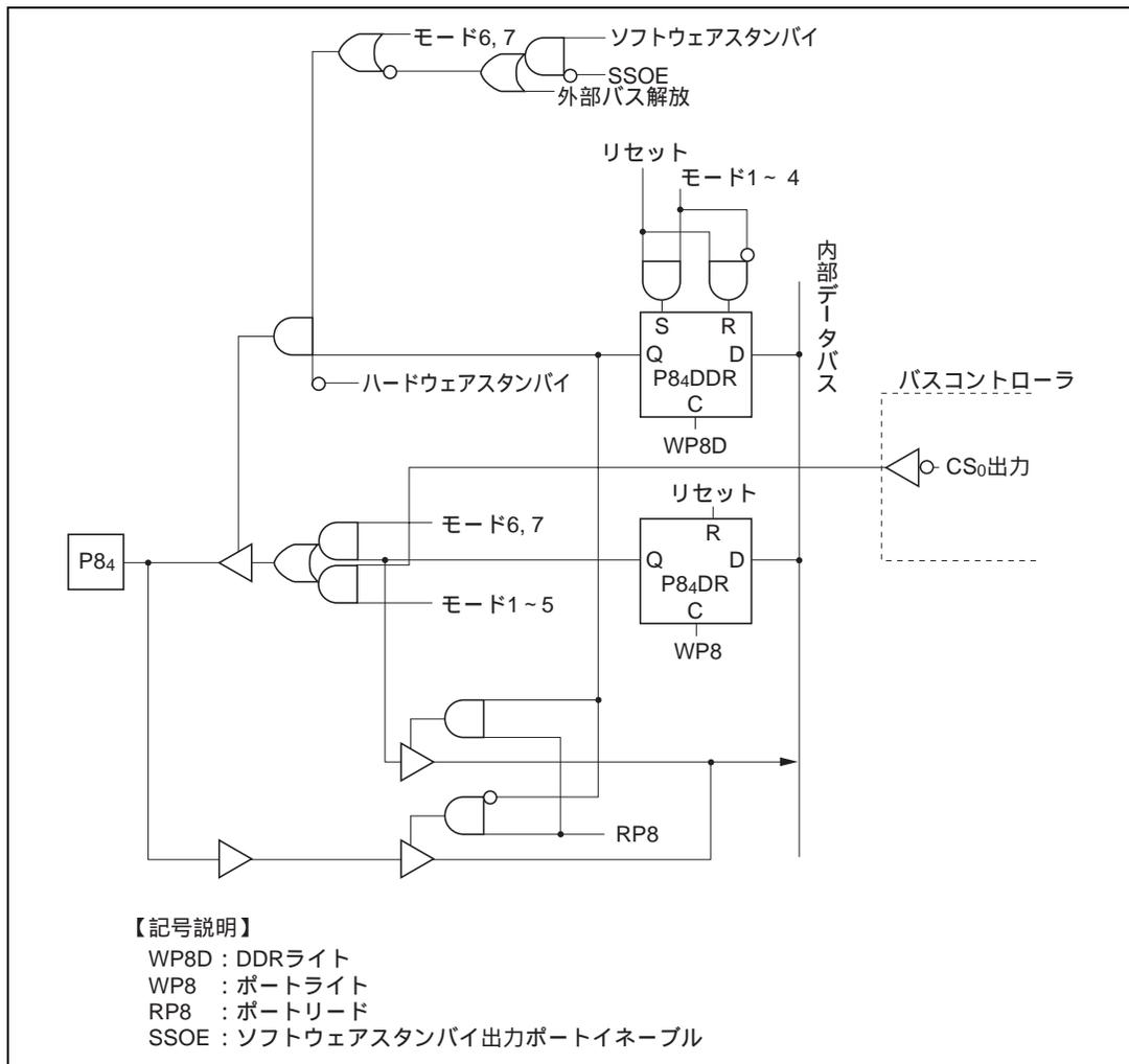
図 C.8 (d) ポート 8 ブロック図 (P8<sub>i</sub>端子)
