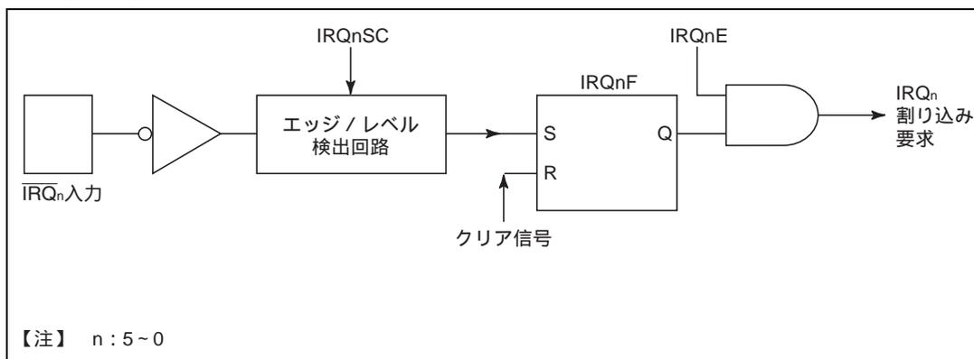
図 5.2 IRQ<sub>0</sub> ~ IRQ<sub>5</sub> 割り込みのブロック図
