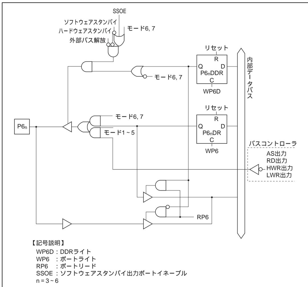
図 C.6 (d) ポート 6 ブロック図 (P6<sub>3</sub> ~ P6<sub>6</sub> 端子)
