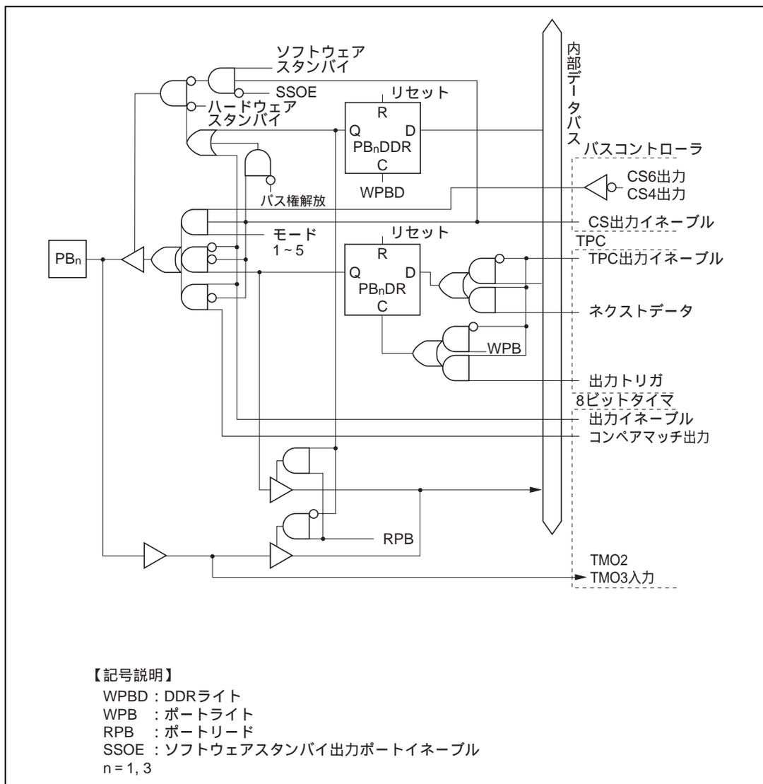
図 C.11 (b) ポート B ブロック図 (PB<sub>1</sub>、PB<sub>3</sub> 端子)
