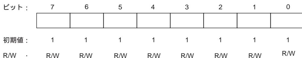
SCI は、TSR の空を検出すると、TDR にライトされた送信データを TSR に転送してシリアル送信を開始します。TSR のシリアルデータ送信中に TDR に次の送信データをライトしておくと、連続シリアル送信ができます。
