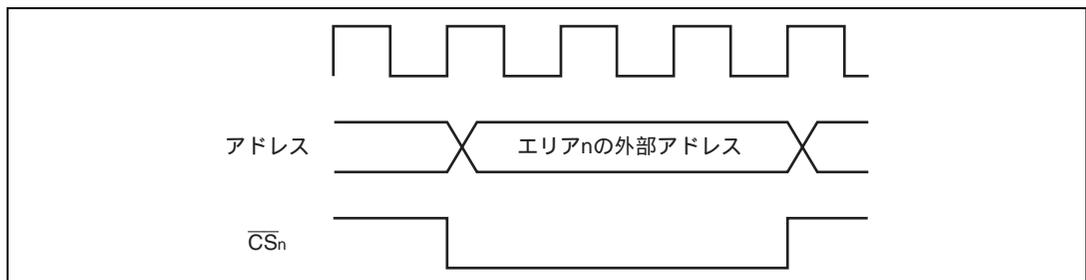
図 6.6  $\overline{CS}_n$  信号の出力タイミング (n=0~7)
