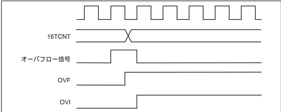
図 8.35 OVF のセットタイミング
