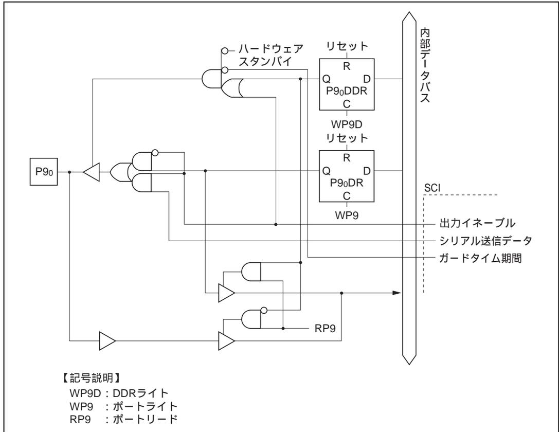
図 C.9 (a) ポート9ブロック図 (P9<sub>0</sub>端子)
