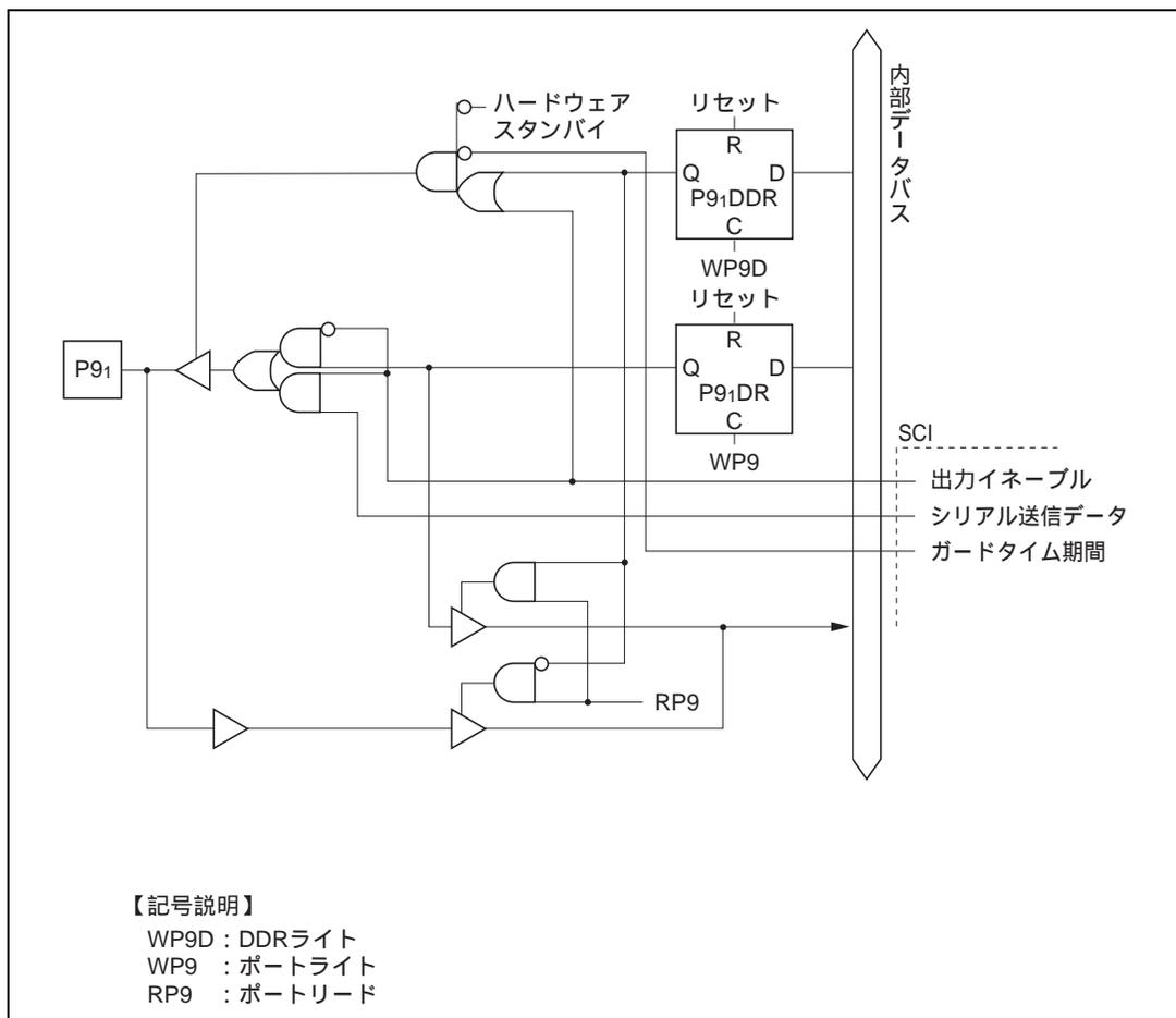
図 C.9 (b) ポート9ブロック図 (P9, 端子)
