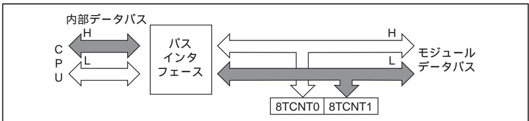
図 9.5 8TCNT1 のアクセス動作 [ CPU 8TCNT1 (下位バイト) ]
