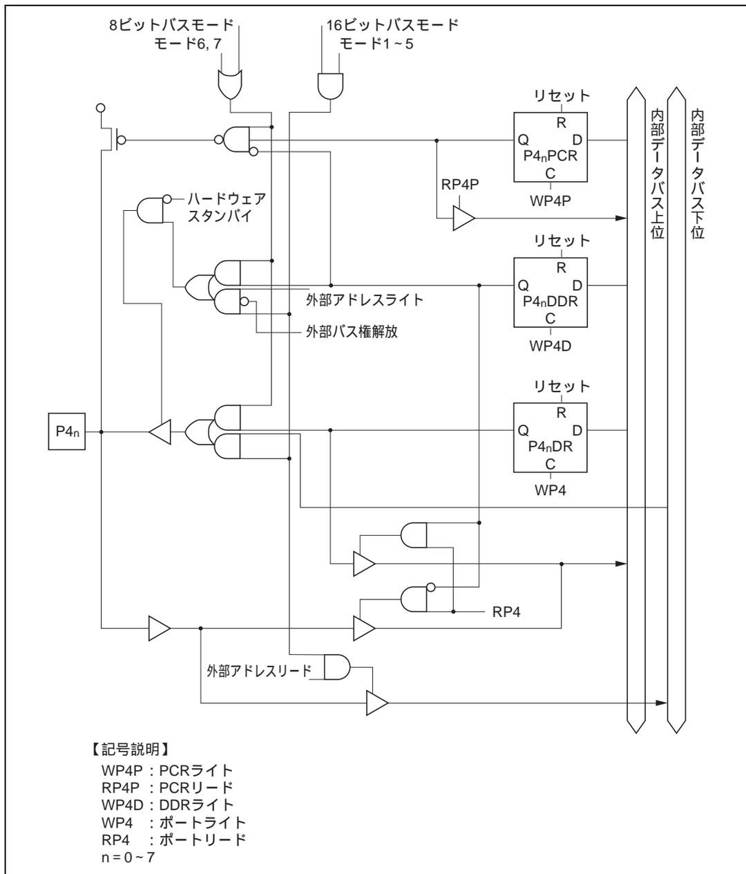
図 C.4 ポート4ブロック図 (P4<sub>0</sub> ~ P4<sub>7</sub>端子)
