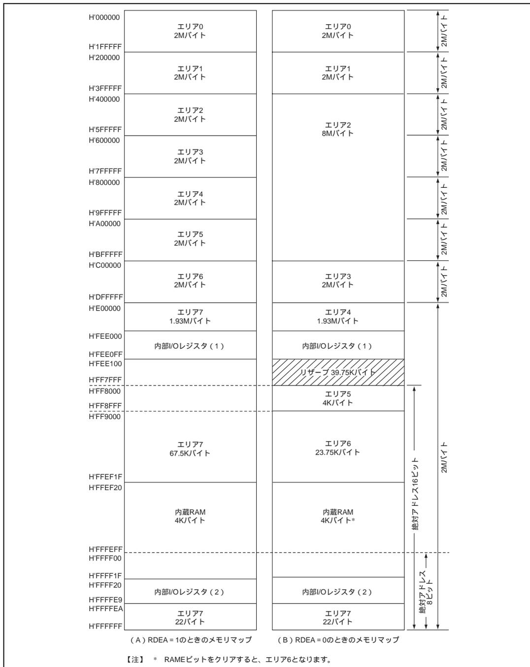
図 6.3 16M バイトモード時のメモリマップ (H8/3062F-ZTAT R マスク品、H8/3062F-ZTAT B マスク品、H8/3062 マスク ROM 品、H8/3061 マスク ROM 品、H8/3062 マスク ROM B マスク品、H8/3061 マスク ROM B マスク品の場合) (1)
