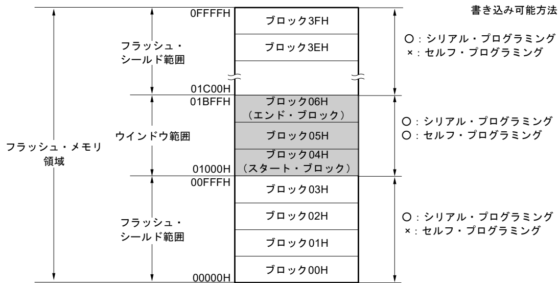
図25-11 フラッシュ・シールド・ウインドウの設定例 (対象デバイス：R5F100LE, スタート・ブロック：04H, エンド・ブロック：06Hの場合)
