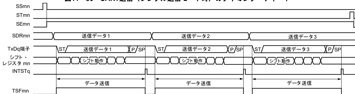
図11-80 UART送信（シングル送信モード時）のタイミング・チャート
