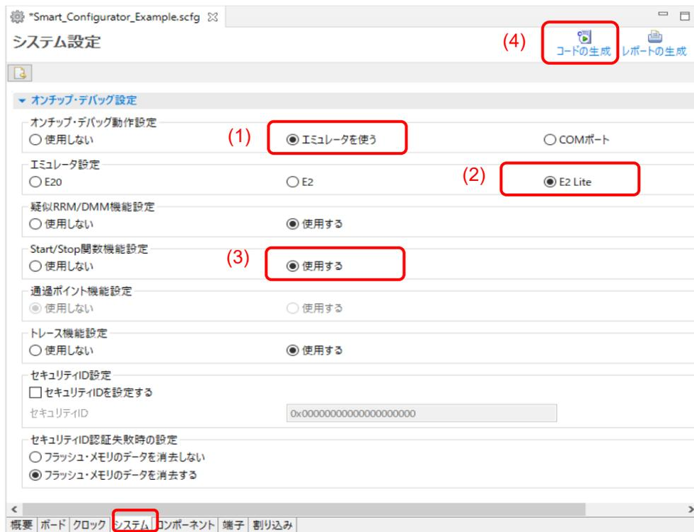
図 4-9 スマート・コンフィグレータ [システム] ページ設定
