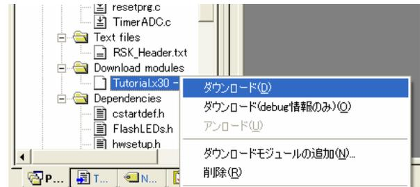
ダウンロードが完了すると、デバッガとコードの実行が可能になります。
