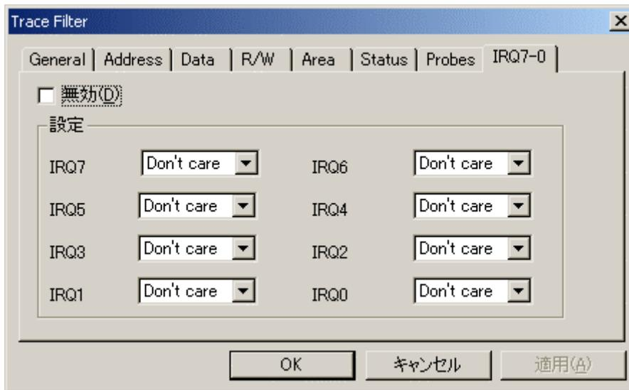
図 8-4 Trace Filter ダイアログボックス(IRQ7-0 ページ)
