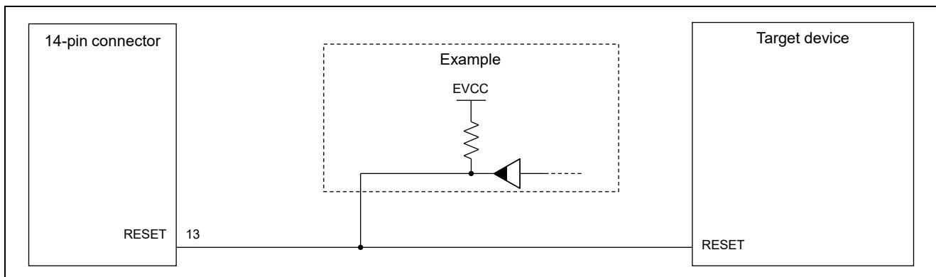
図 2-8 リセット回路接続例
