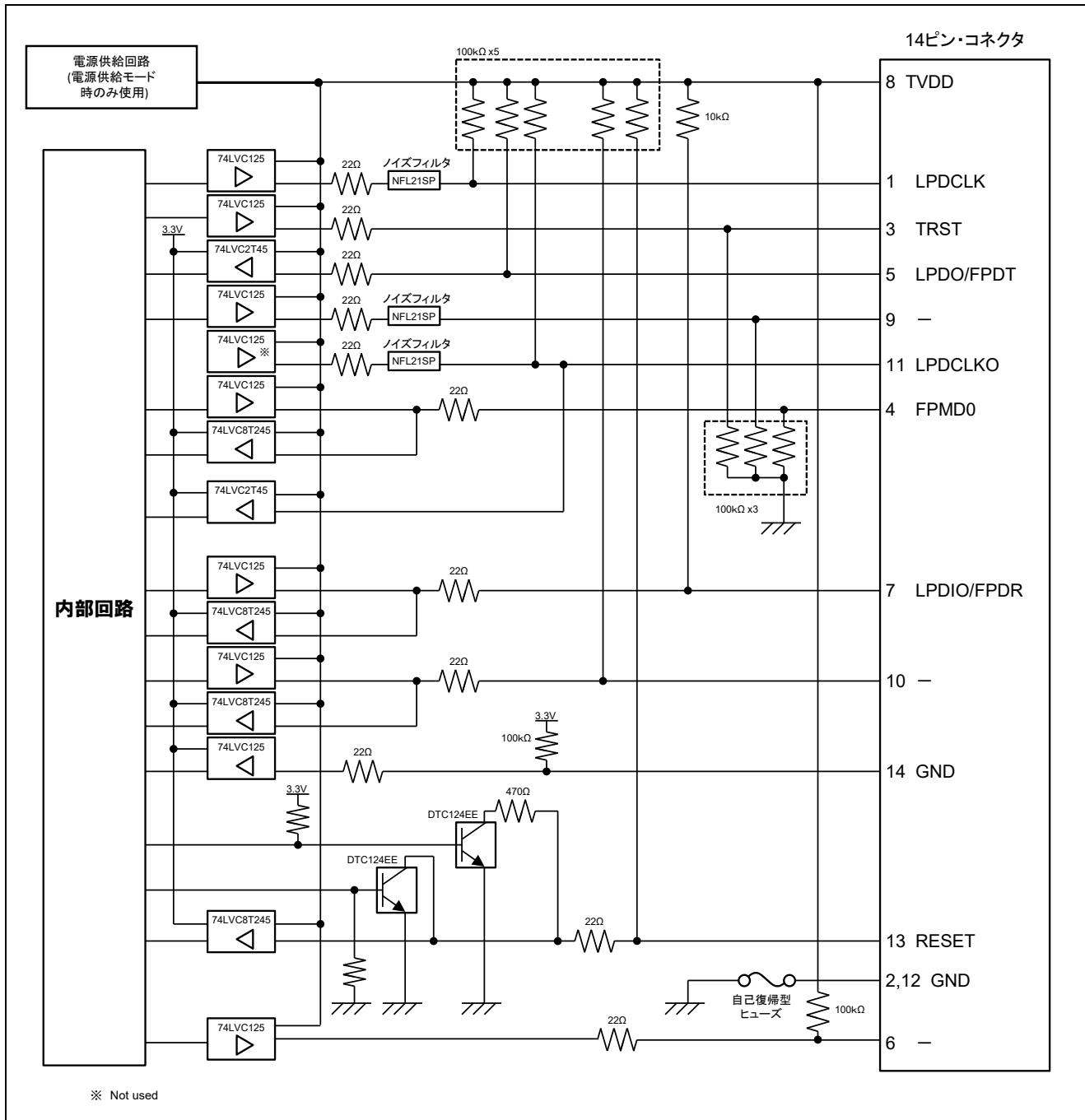
図 5-1 E1/E20 エミュレータ内インターフェース回路(LPD 1pin、1wireUART)
