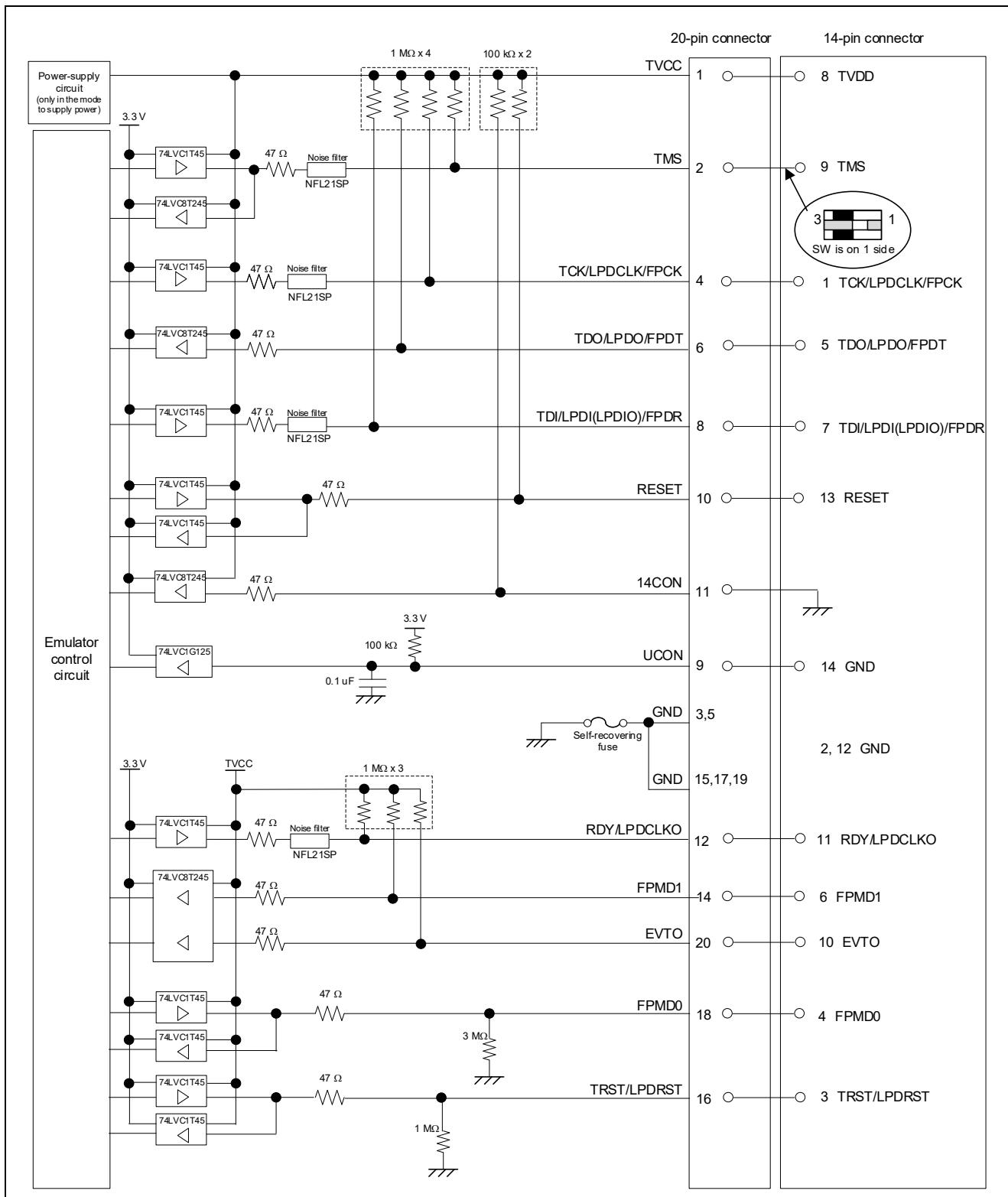
図 5-4 E2 エミュレータ(Rev.D)内インタフェース回路
