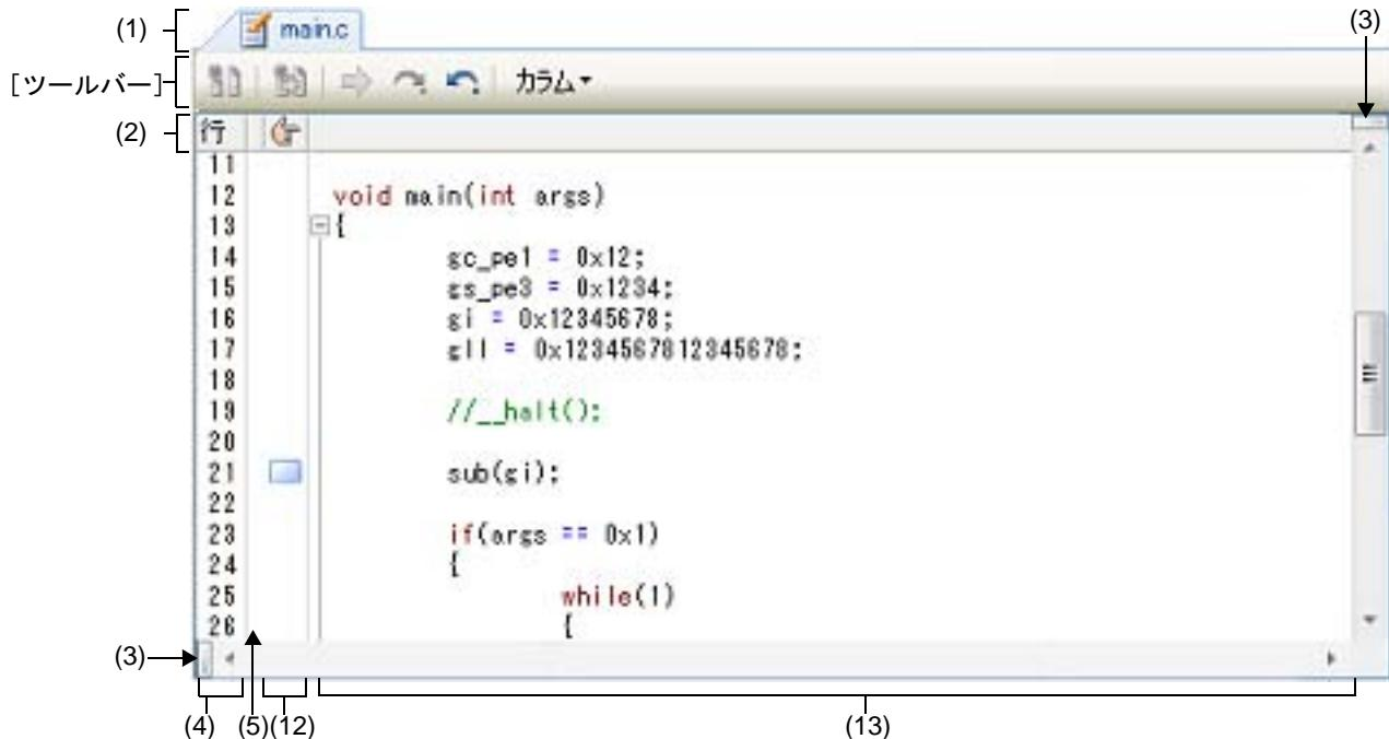
図 A.2 エディタ パネル（デバッグ・ツールと接続時）
