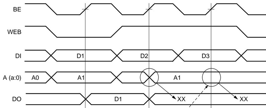
正常に読み出しても、すでにデータが破壊されているので、読み出した値は不定になります。
