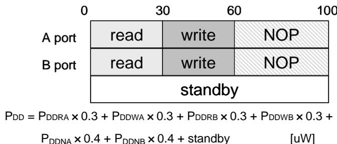
**例 2** RAMの全動作期間においてリード30%、ライト30%、NOP期間をクロック・ゲーティングでクロック制御した場合、動作率はリード0.3、ライト0.3になります。
