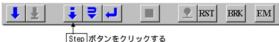
プログラムウィンドウがソース表示モードの場合は、ソース行単位でステップ実行します。プログラムウィンドウが逆アセンブル表示モードの場合は、命令単位でステップ実行します。
