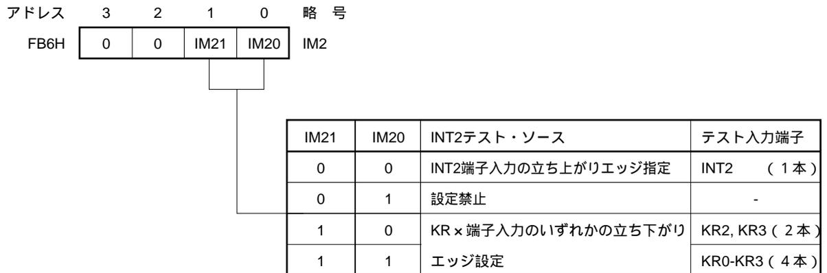
注意1 . エッジ検出モード・レジスタを変更すると、テスト要求フラグがセットされる場合がありますので、あらかじめテスト入力を禁止してモード・レジスタを変更し、CLR1命令によってテスト要求フラグをクリアしてから、テスト入力を許可してください。
