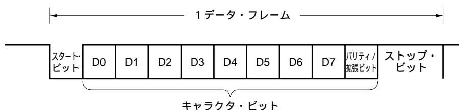
図8-2 アシンクロナス・シリアル・インタフェースの送受信データのフォーマット
