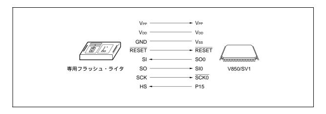
専用フラッシュ・ライタが転送クロックを出力し, V850/SV1はスレーブとして動作します。
