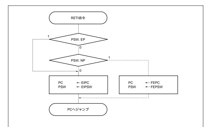
注意 例外トラップ処理中にLDSR命令によりPSW.EPビット, PSW.NPビットを変更した場合には, RETI命令による復帰時にPCとPSWを正常にリストアするために, RETI命令の直前で, LDSR命令を使用してPSW.EP = 1に戻しておいてください。
