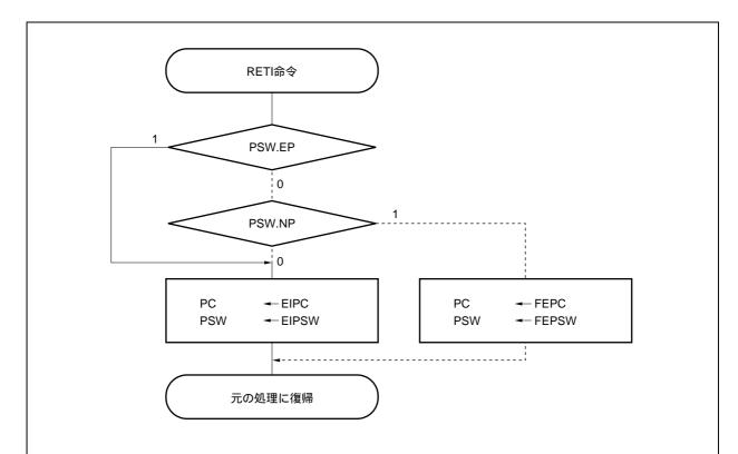
注意 ソフトウエア例外処理中にLDSR命令によりPSW.EPビット, PSW.NPビットを変更した場合には,RETI命令による復帰時にPCとPSWを正常にリストアするために,RETI命令の直前で,LDSR命令を使用してPSW.EP = 1に戻しておいてください。
