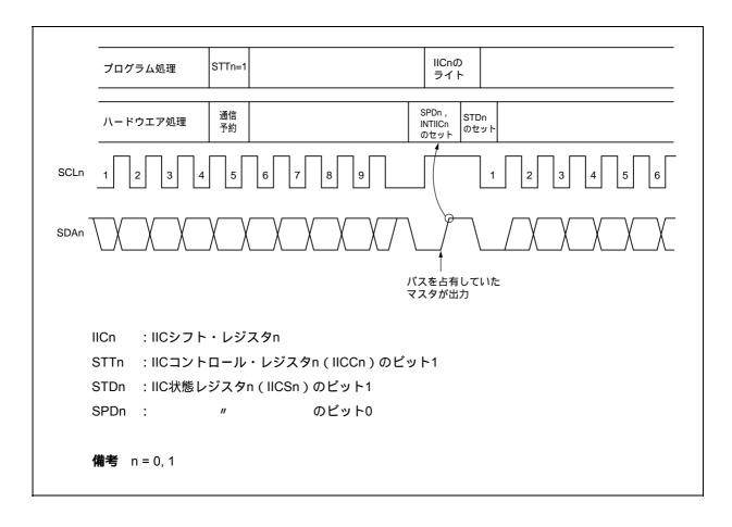
通信予約は次のタイミングで受け付けられます。IIC状態レジスタn(IICSn)のビット1(STDn) = 1になったあと,ストップ・コンディション検出までにIICコントロール・レジスタn(IICCn)のビット1(STTn) = 1で通信予約をします(n=0,1)。
