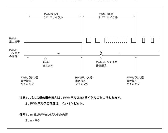
図14 - 8 PWM出力タイミング例2 (PWMパルス幅書き換え周期2<sup>x</sup>/fpwmc)
