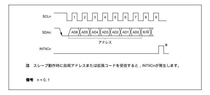
アドレスは,スレーブのアドレスと(3**)転送方向指定**に説明する転送方向を合わせて8ビットとしてIIC シフト・レジスタn(IICn)に書き込むと出力します。また,受信したアドレスはIICnに書き込まれます(n=0,1)。
