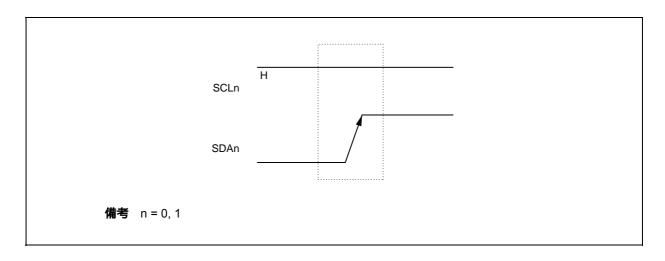
ストップ・コンディションは,IICコントロール・レジスタn(IICCn)のビット0(SPTn)をセット(1) すると発生します。また,ストップ・コンディションを検出するとIIC状態レジスタn(IICSn)のビット0(SPDn)がセット(1)され,IICCnのビット4(SPIEn)がセット(1)されている場合にはINTIICnが発生します(n=0,1)。
