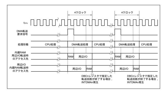
図12 - 4 DMA転送動作のタイミング図
