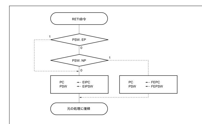
注意 マスカブル割り込み処理中にLDSR命令によりPSW.EPビット, PSW.NPビットを変更した場合は, RETI命令による復帰時にPCとPSWを正常にリストアするために, RETI命令の直前で, LDSR命令を使用してPSW.EP = 0かつPSW.NP = 0に戻しておいてください。
