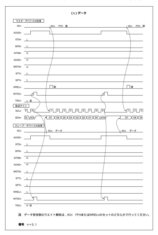
図10-23 スレープ マスタ通信例(マスタ,スレープとも9クロック・ウエイト選択時)(3/3)
