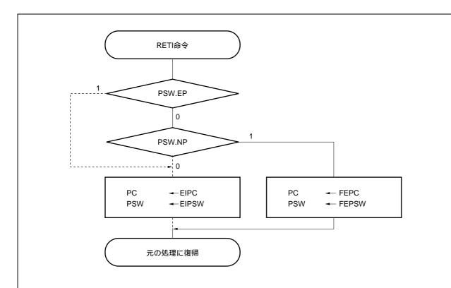
注意 ノンマスカブル割り込み処理中にLDSR命令によりPSW.EPビット, PSW.NPビットを変更した場合には, RETI命令による復帰時にPCとPSWを正常にリストアするために, RETI命令の直前で, LDSR命令を使用してPSW.EP = 0かつPSW.NP = 1に戻しておいてください。
