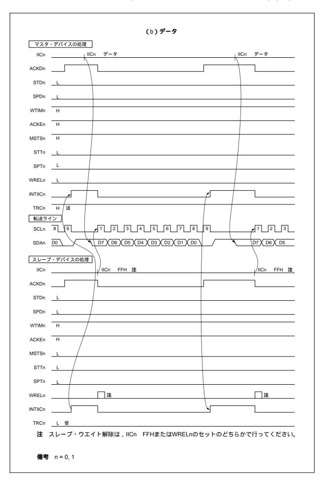
図10-22 マスタ スレーブ通信例(マスタ,スレーブとも9クロック・ウエイト選択時)(3/3)
