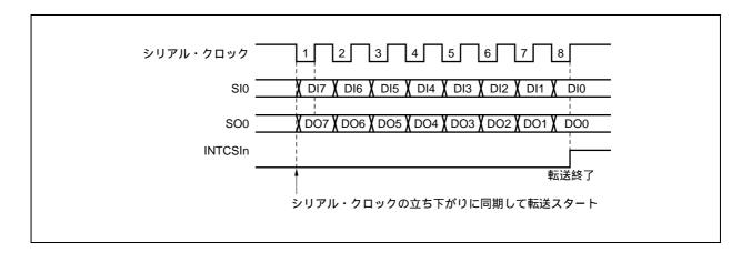
図10-4 3線式シリアルI/Oモードのタイミング
