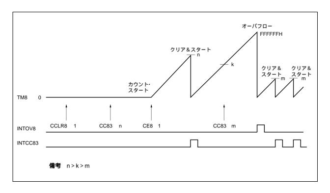
図7 - 10 CC83一致によるタイマのクリア / スタート動作とオーバフロー動作の関係 (CCLR8 = 1, OST8 = 1の場合)
