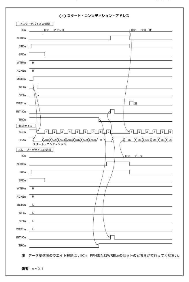
図10-23 スレーブ マスタ通信例(マスタ,スレープとも9クロック・ウエイト選択時)(2/3)
