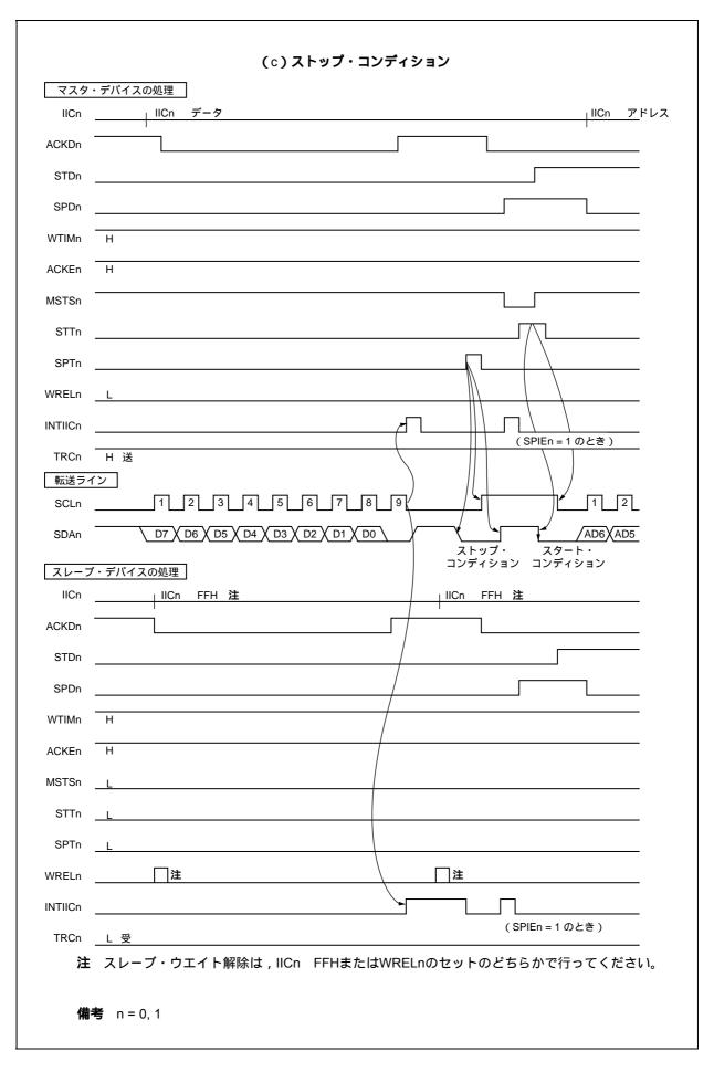
図10-23 スレーブ マスタ通信例(マスタ,スレープとも9クロック・ウエイト選択時)(1/3)
