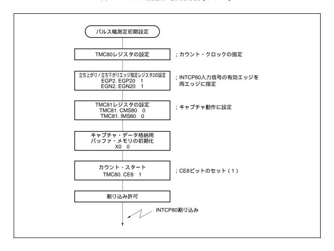
図7 - 24 パルス幅を算出する割り込み要求処理ルーチン例 (タイマ8)
