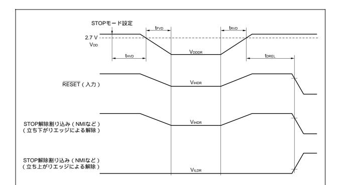
注意1. STOPモードへの移行,およびSTOPモードからの復帰は, V<sub>DD</sub> = 2.7 V以上(fxx = 16 MHz時), V<sub>DD</sub> = 3.1 V以上(fxx = 20 MHz時)で行ってください。
