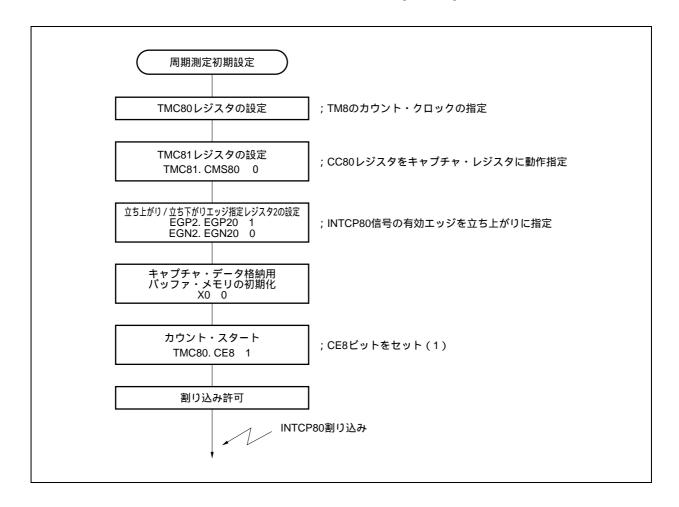
図7-30 周期を算出する割り込み要求処理ルーチン例(タイマ8)
