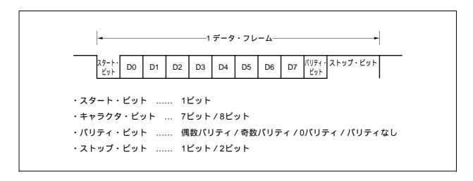
キャラクタ・ビットとして7ビットを選択した場合,下位7ビット(ビット0-ビット6)のみが有効となり,送信の場合は最上位ビット(ビット7)は無視され,受信の場合は必ず最上位ビット(ビット7)は"0"になります。
