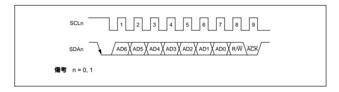
自局アドレス受信時は,ACKEnの値にかかわらずSCLnの8クロック目の立ち下がりに同期してアクノリッジ信号を自動出力し,自局アドレス以外の受信時は,アクノリッジ信号を出力しません(n=0,1)。 データ受信時のアクノリッジ信号の出力方法はウエイト・タイミングの設定により次のようになります。
