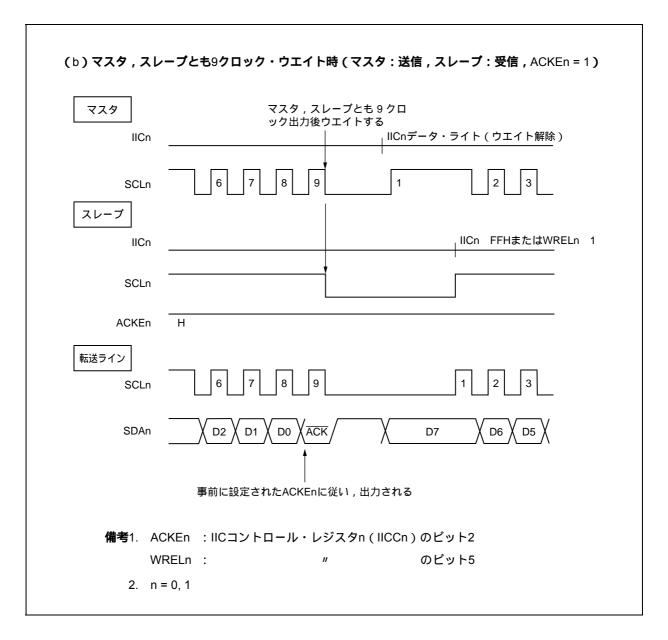
ウエイトは,IICコントロール・レジスタn(IICCn)のビット3(WTIMn)の設定により自動的に発生します(n=0,1)。
