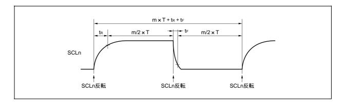
選択クロックは,IICクロック選択レジスタn(IICCLn)のSMCn, CLn1, CLn0ビット,IIC機能拡張レジスタn(IICXn)のCLXnビットを組み合わせて設定します(n=0,1)。
