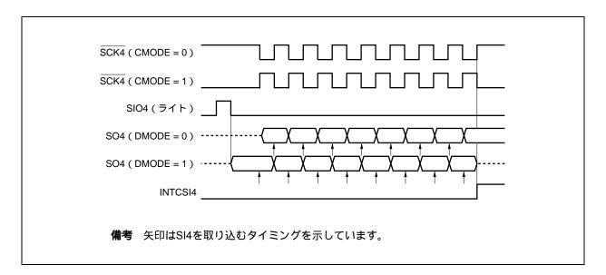
図10-40 3線式可変長シリアルI/Oモードのタイミング
