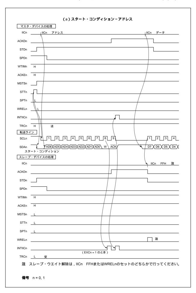
図10-22 マスタ スレーブ通信例(マスタ,スレーブとも9クロック・ウエイト選択時)(2/3)
