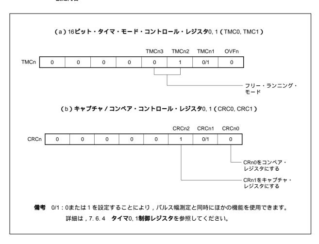
図7-39 フリー・ランニング・カウンタによるパルス幅測定の構成図
