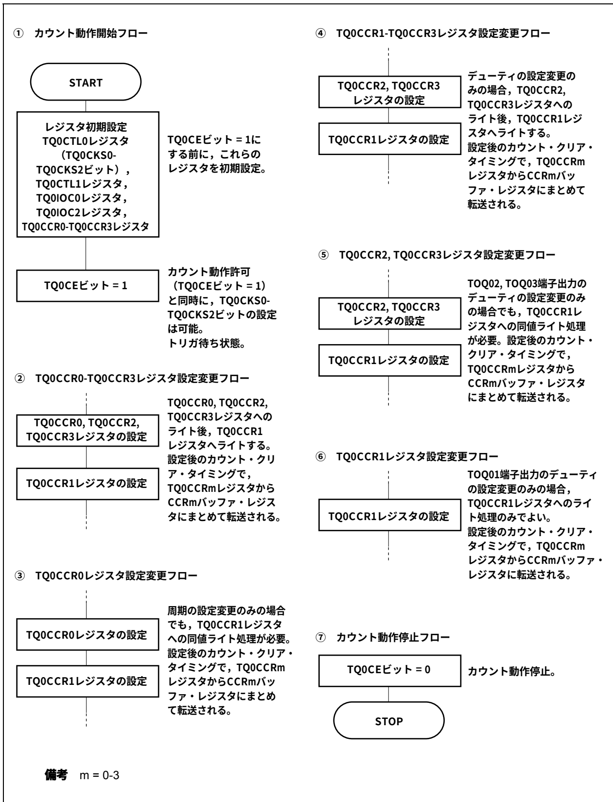
図8-19 外部トリガ・パルス出力モード使用時のソフトウェア処理フロー (2/2)
