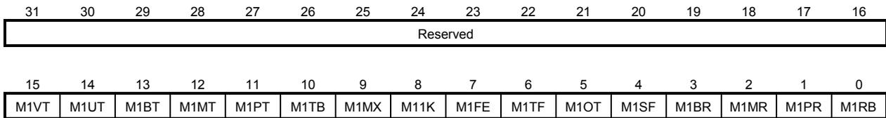
CAR1レジスタ内のビットに1が設定されたときに発生するINT#信号をマスクします。このビットに1を設定すると、マスクが解除されます。
