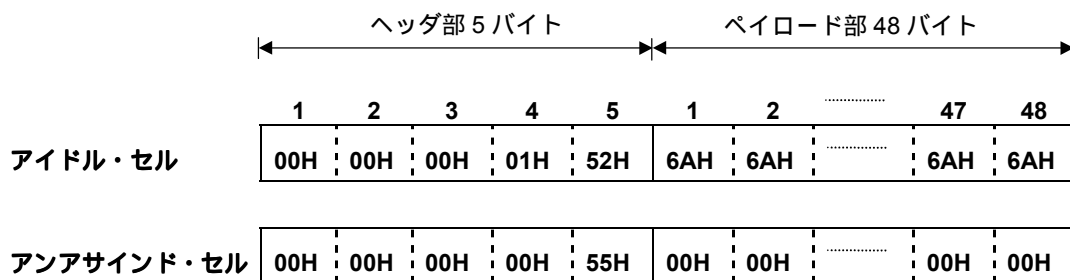
図 3 - 6 \mu PD98414 が挿入する空きセルのフォーマット
