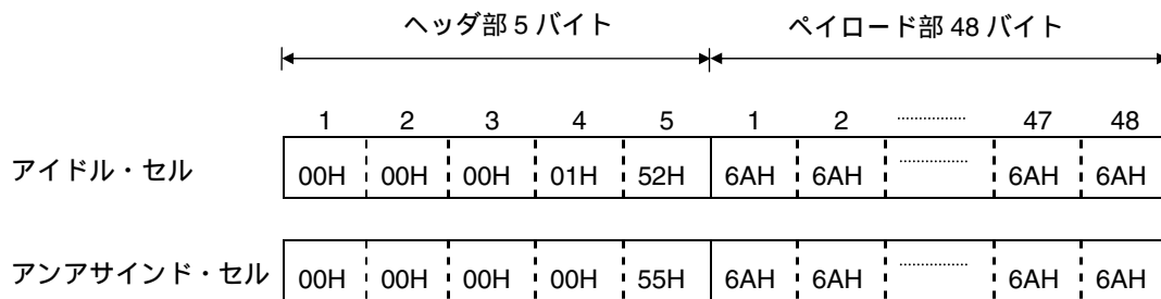
図 3-6 \mu PD98411 が挿入する空きセルのフォーマット
