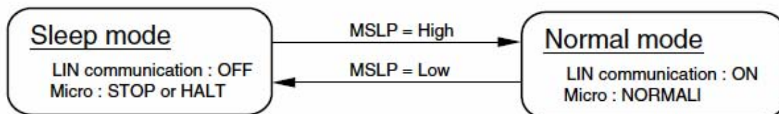
図5-2 動作モード状態遷移図
