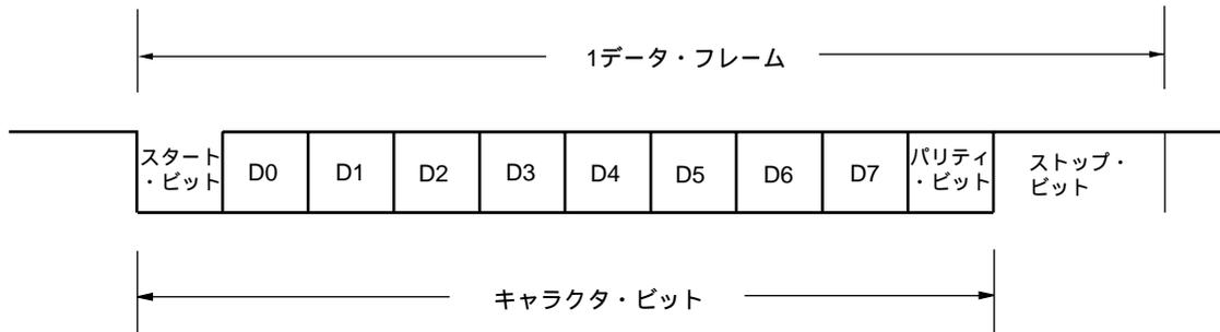
1データ・フレームは、次に示す各ビットで構成されます。
