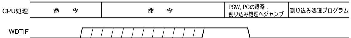
図17-10 ノンマスクابل割り込み要求の受け付け動作
