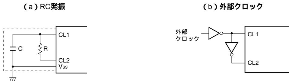
**注意** システム・クロック発振回路を使用する場合は, 配線容量などの影響を避けるために, 図8-3の破線の部分を次のように配線してください。
