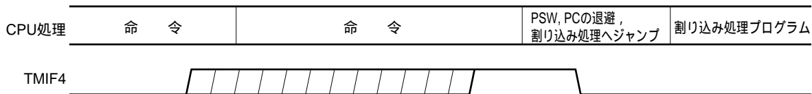
図9 - 8 ノンマスクブル割り込み要求の受け付け動作
