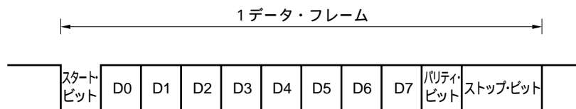
図8-7 アシンクロナス・シリアル・インタフェースの送受信データのフォーマット
