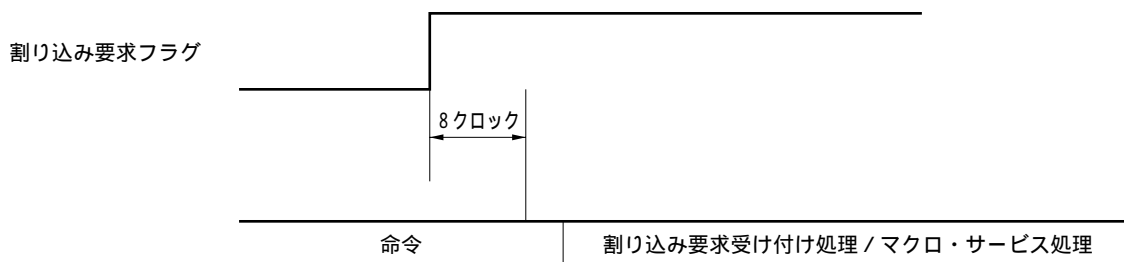
図14 - 34 割り込み要求の発生と受け付け（単位：クロック = 1/f_{\text{CLK}} ）
