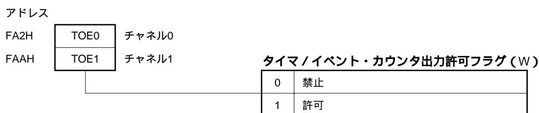
図5 - 34 タイマ/イベント・カウンタ出力許可フラグのフォーマット
