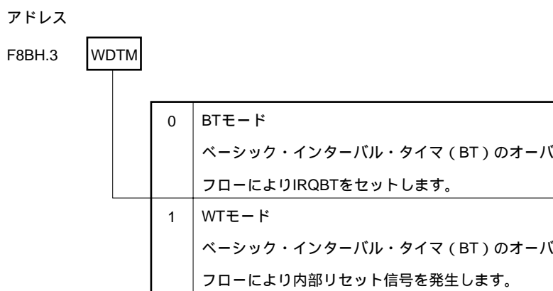
図5 - 25 ウォッチドッグ・タイマ許可フラグ (WDTM) のフォーマット
