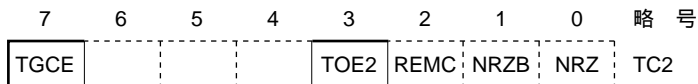
図5-36 タイマ/イベント・カウンタ・コントロール・レジスタの設定
