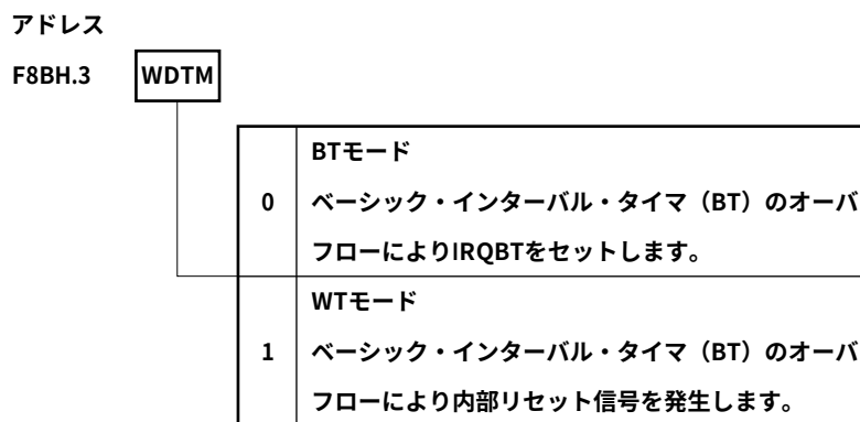
図5-25 ウォッチドッグ・タイマ許可フラグ (WDTM) のフォーマット
