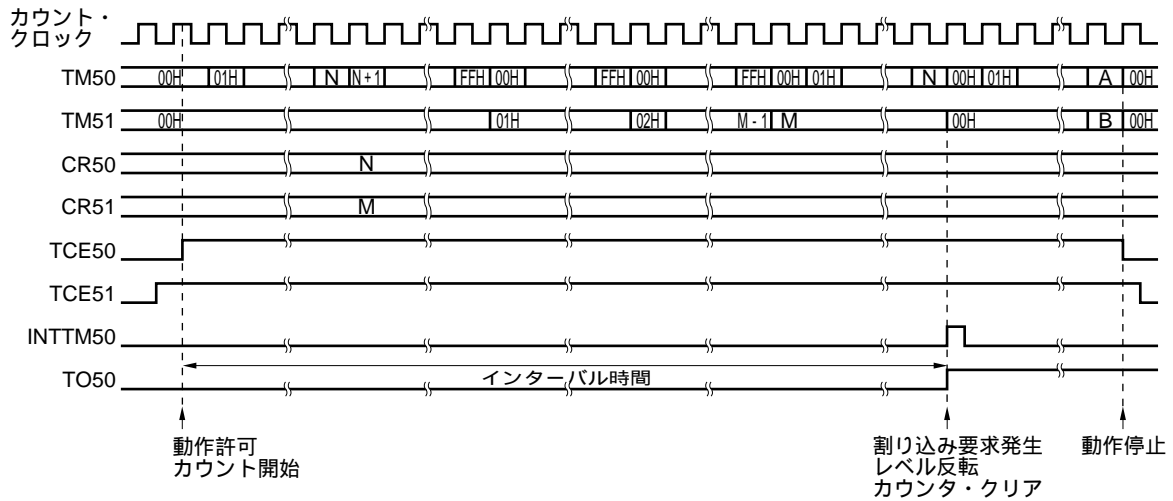
図6-12 16ビット分解能カスケード接続モード
