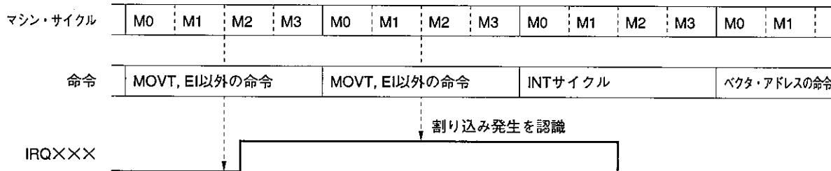
図14-4 割り込み受け付けタイミング・チャート (INTE = 1, IPXXXX = 1のとき) (2/3)
