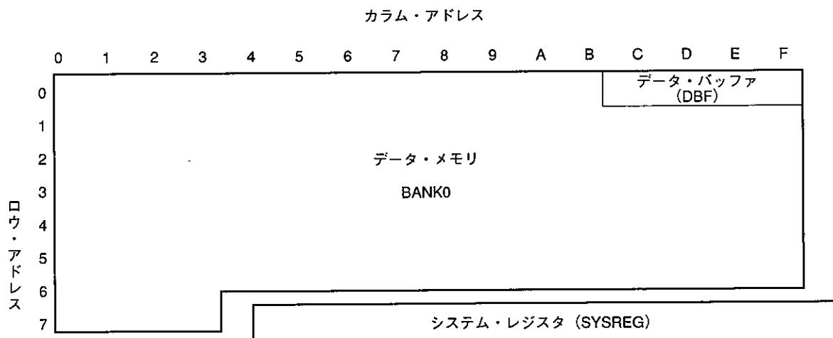
図10-2にデータ・バッファの構成を示します。図10-2に示すようにデータ・バッファはデータ・メモリの0FH番地のビット0をLSBとし、0CH番地のビット3をMSBとする16ビットで構成されています。
