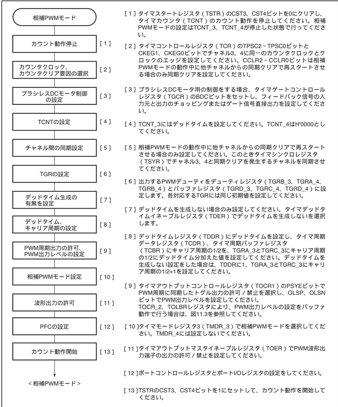
図 11.38 相補 PWM モードの設定手順例
